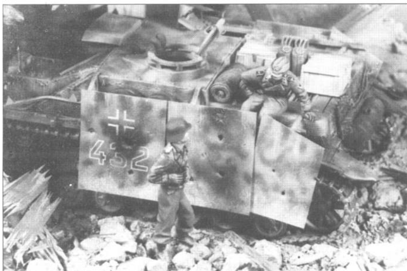
Толщина бортовых экранов немецкой бронетехники составляла всего 6 мм, они легко пробивались пулями и осколками.
