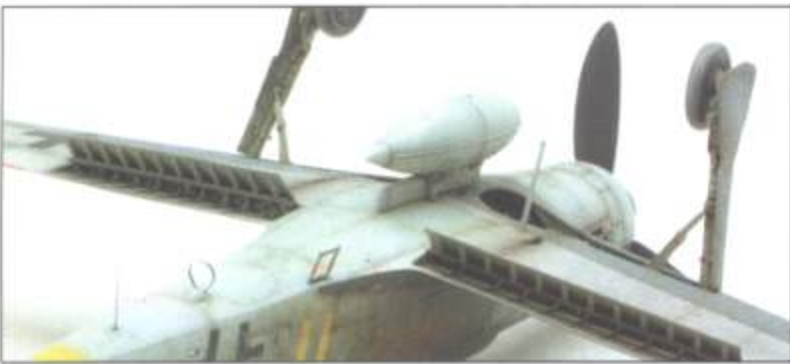
На нижней поверхности модели установлены довольно хрупкие детали: подножка, рамочная антенна радиоконпаса, подвесной бака. Все это хозяйство легко повредить.
