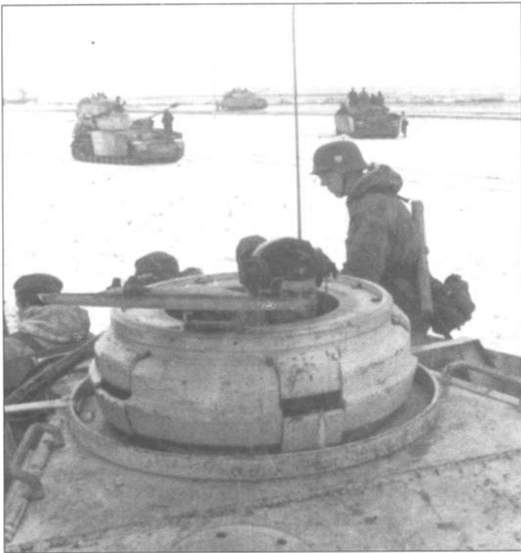
Командирская башенка имела пять смотровых приборов с вертикально сдвигающимися бронезаслонками. По крыше башенки шла отбортовка, которая служила для отражения осколков снарядов. На переднем плане заметна часть бронекорпуса вентилятора.
