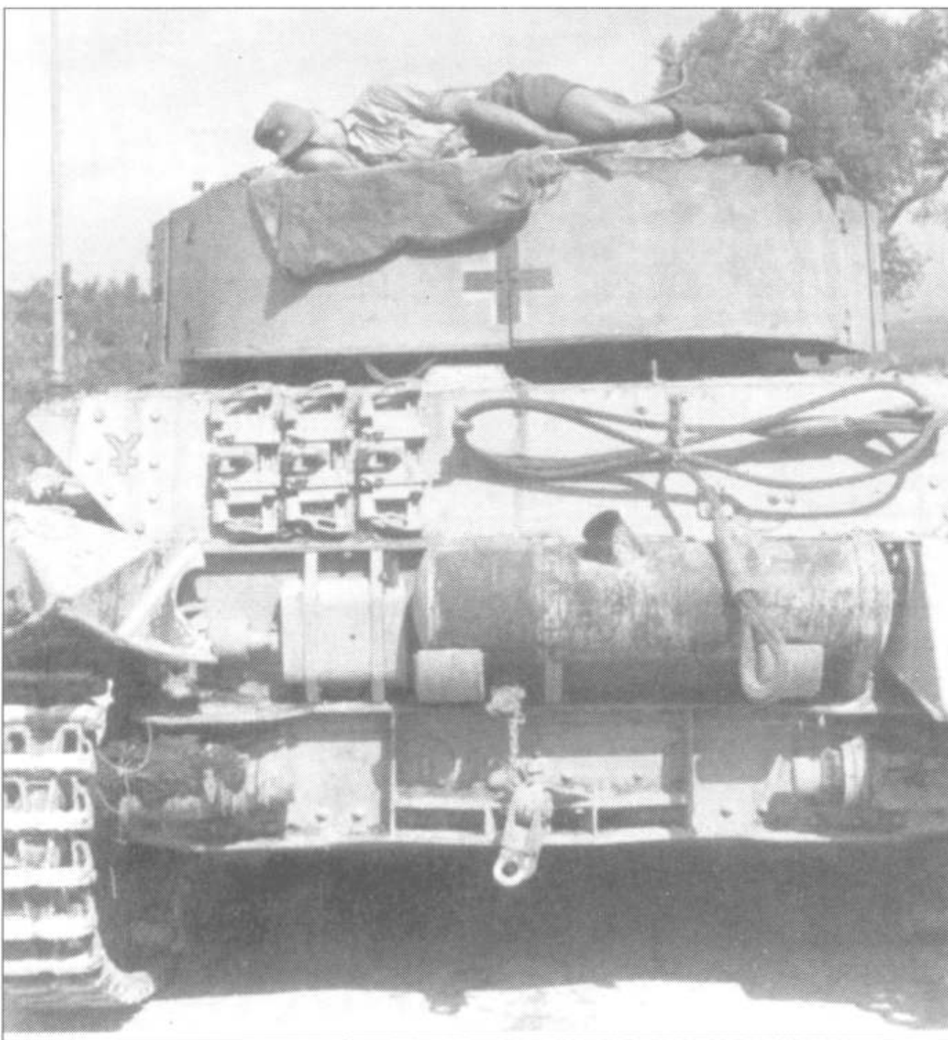
Теплый климат южной Италии расслабляюще подействовал на этого танкиста: боец заснул, растянувшись прямо на кормовом башенном контейнере танка Pz.Kpfw IV Ausf. H. Антенна смонтирована в задней части корпуса, слева.
