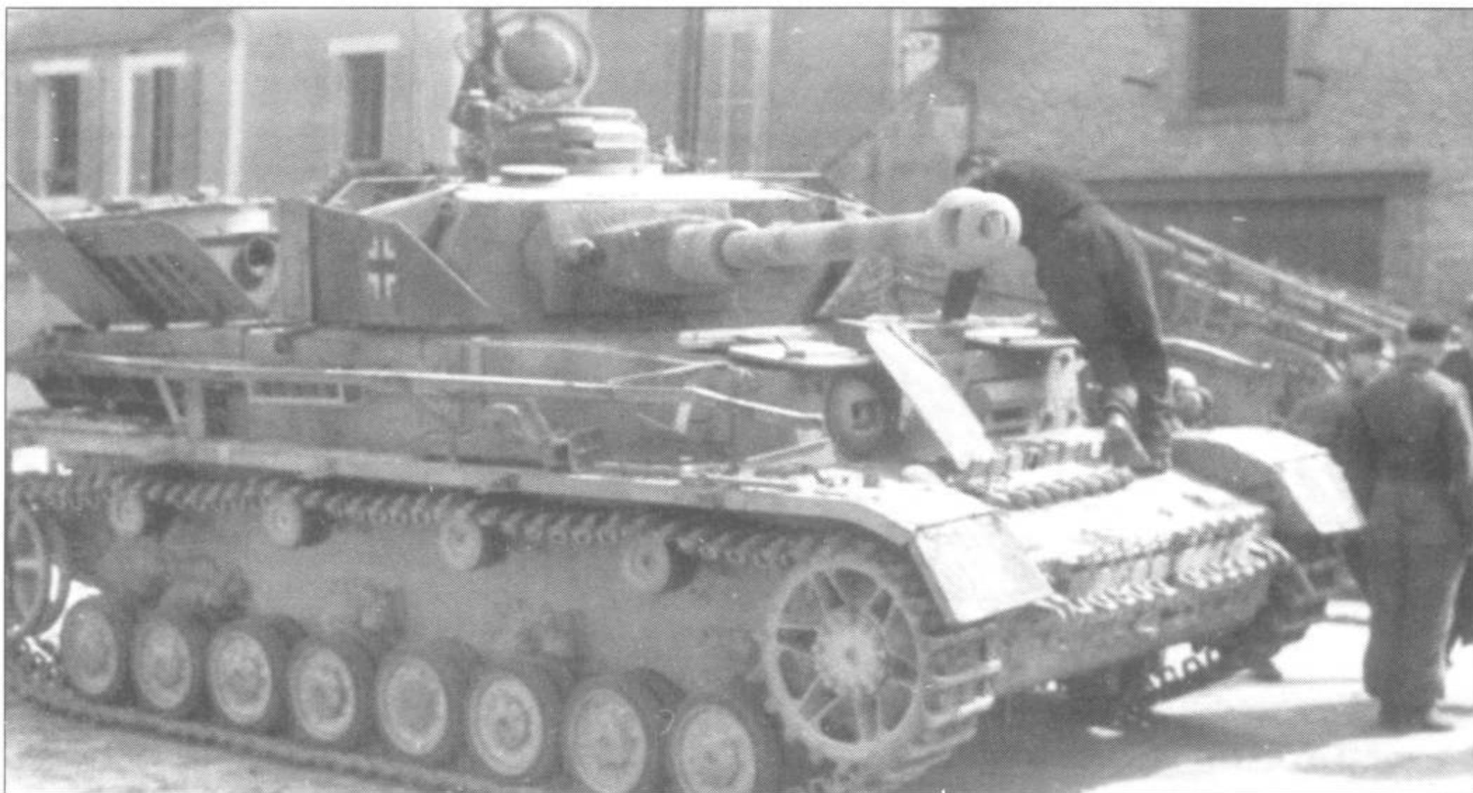
Циммеритное покрытие танка Pz.Kpfw IV Ausf. H нанесено даже на установленную в лобовой части корпуса накладную броню и брызговики. На танке установлены ведущие колеса новой конструкции, но на опорных катках - бронеколпаки втулок старого образца, а ролики имеют обрезинку. Командирская башенка оснащена одностворчатым люком и турельной установкой под зенитный пулемет MG-34.
