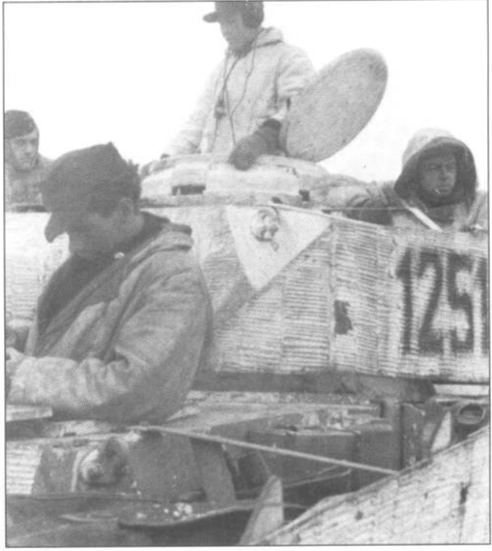
Этот танк PzKpfw IV Ausf. H полностью, включая башенные экраны, покрыт циммеритом. Обратите внимание, невидимые под экранами поверхности танка в «зимний камуфляж» белого цвета не перекрашены.
