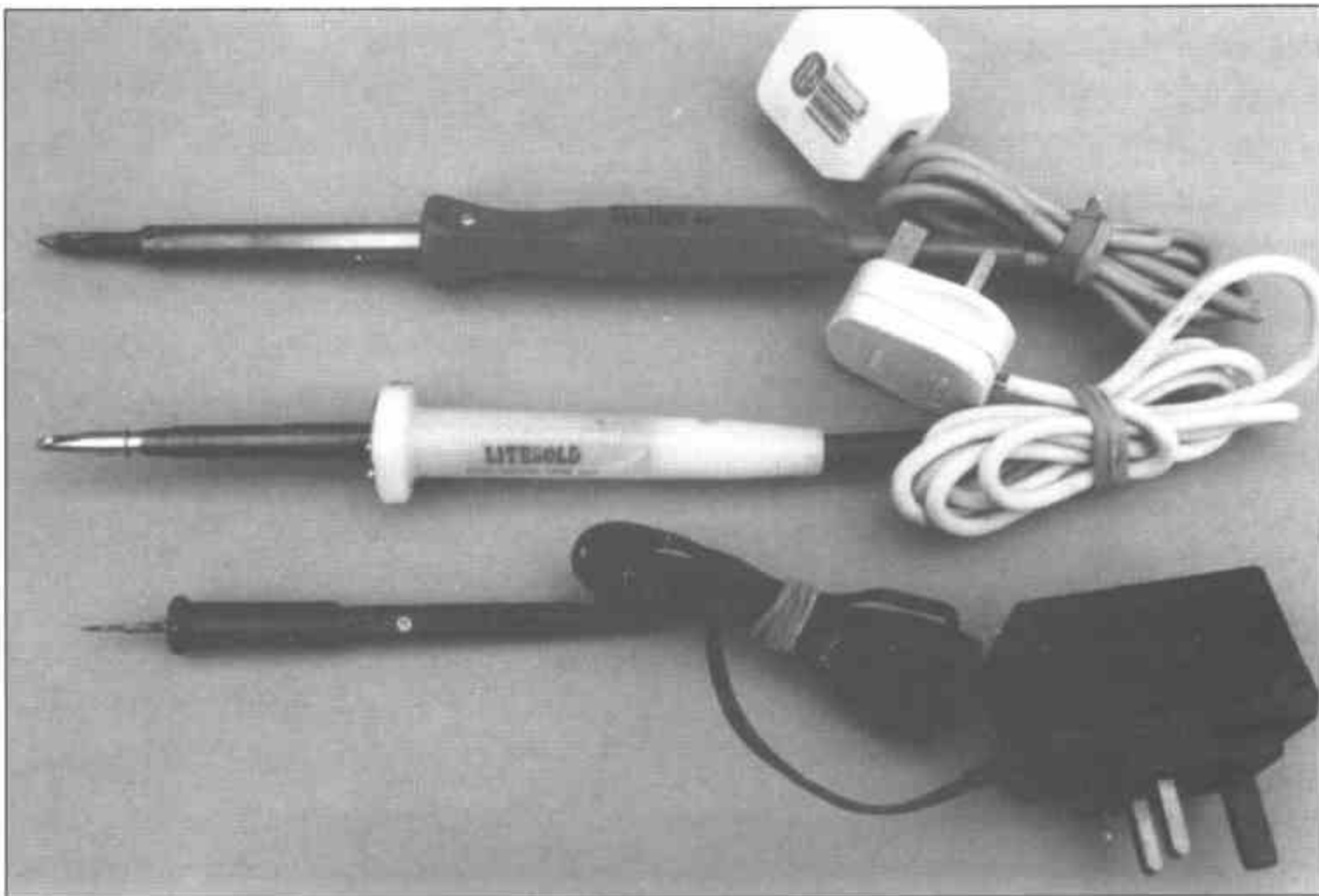
Три различных паяльника, верхний – 40-ваттный, в центре – паяльник регулируемой мощности и в низу – прибор для выжигания, им также можно паять детали из белого металла.
