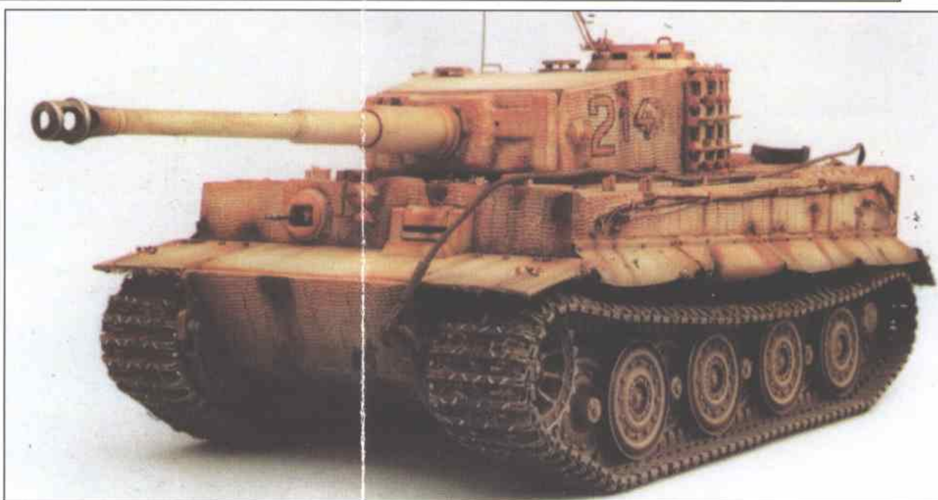
Panzerkampfwagen VI Ausf. E (позднего выпуска) – Тамия. Бортовые крылья сделаны из свинцовой фольги. Циммерит имитирован миллипудом. Детали фототравления – из наборов фирм Show Modelling и On The Mark.
