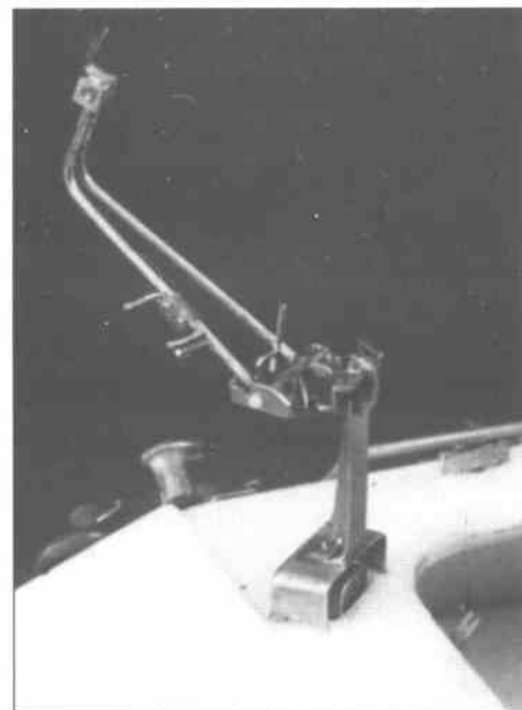
Турель для зенитного пулемета на модели Bergepanzer собрана из металлических детали пайкой.
