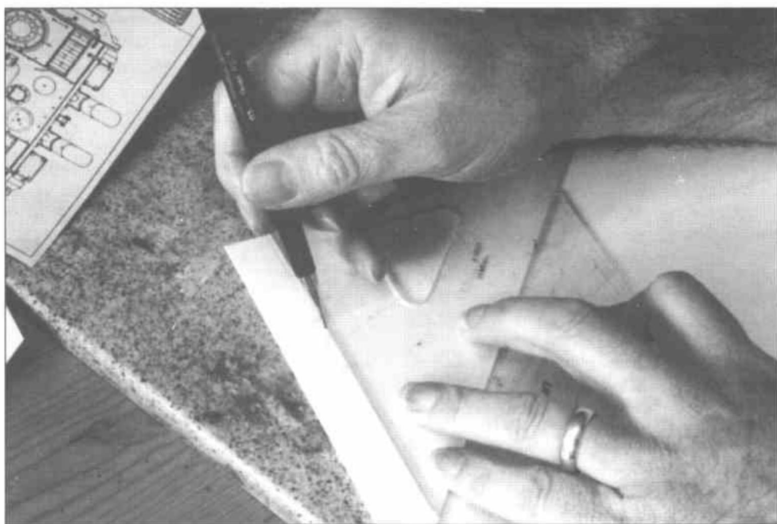
Разметка параллельных линий на листовом пластике с помощью двух треугольников.
