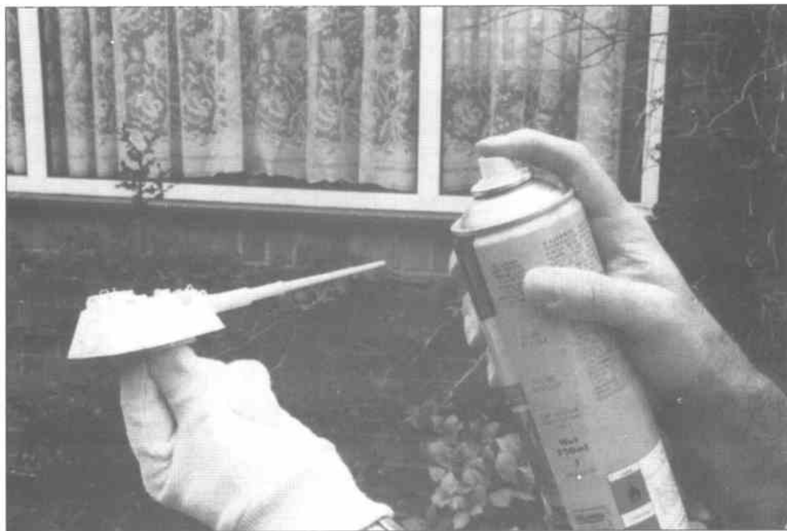
Окраска модели начинается с нанесения автомобильной грунтовки из аэрозольного баллончика.
