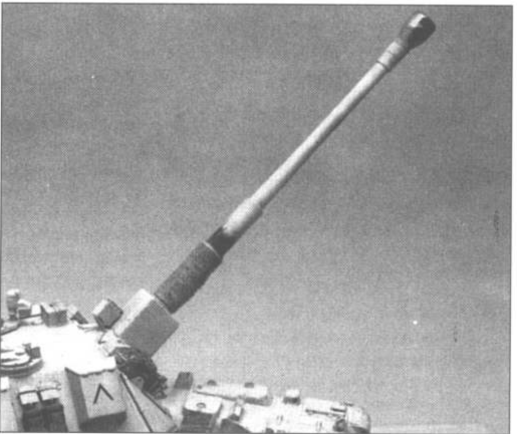
Обратите внимание на протертую краску песочного цвета у «гармошки» чехла. Краска сдиралась при откате ствола после выстрела о края чехла.
