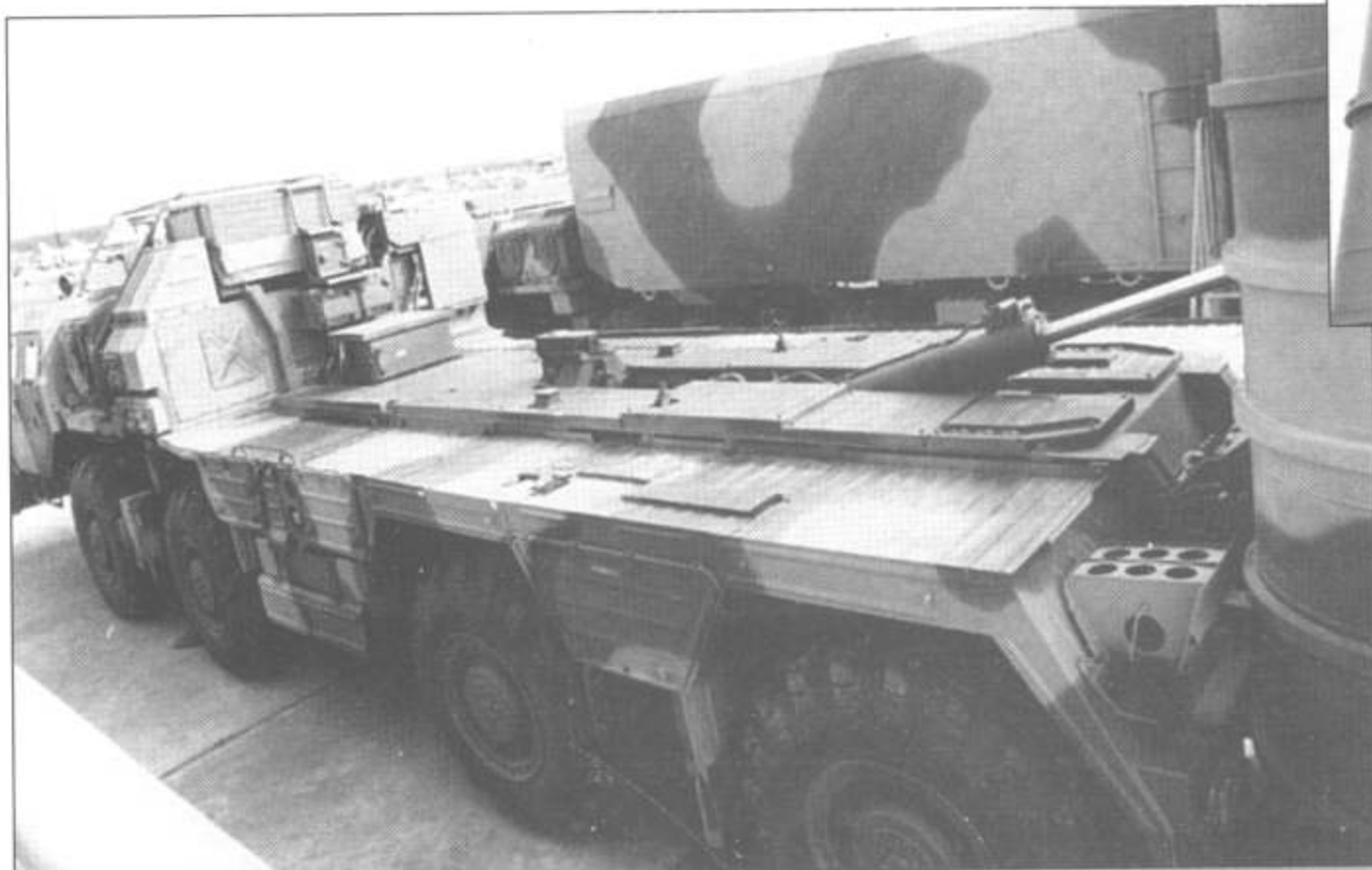
Слева: платформа транспортно-заряжающей машины 5П85Д. Хорошо видно единственное отличие от машины 5П85С – нет объемистого контейнера за кабиной.
