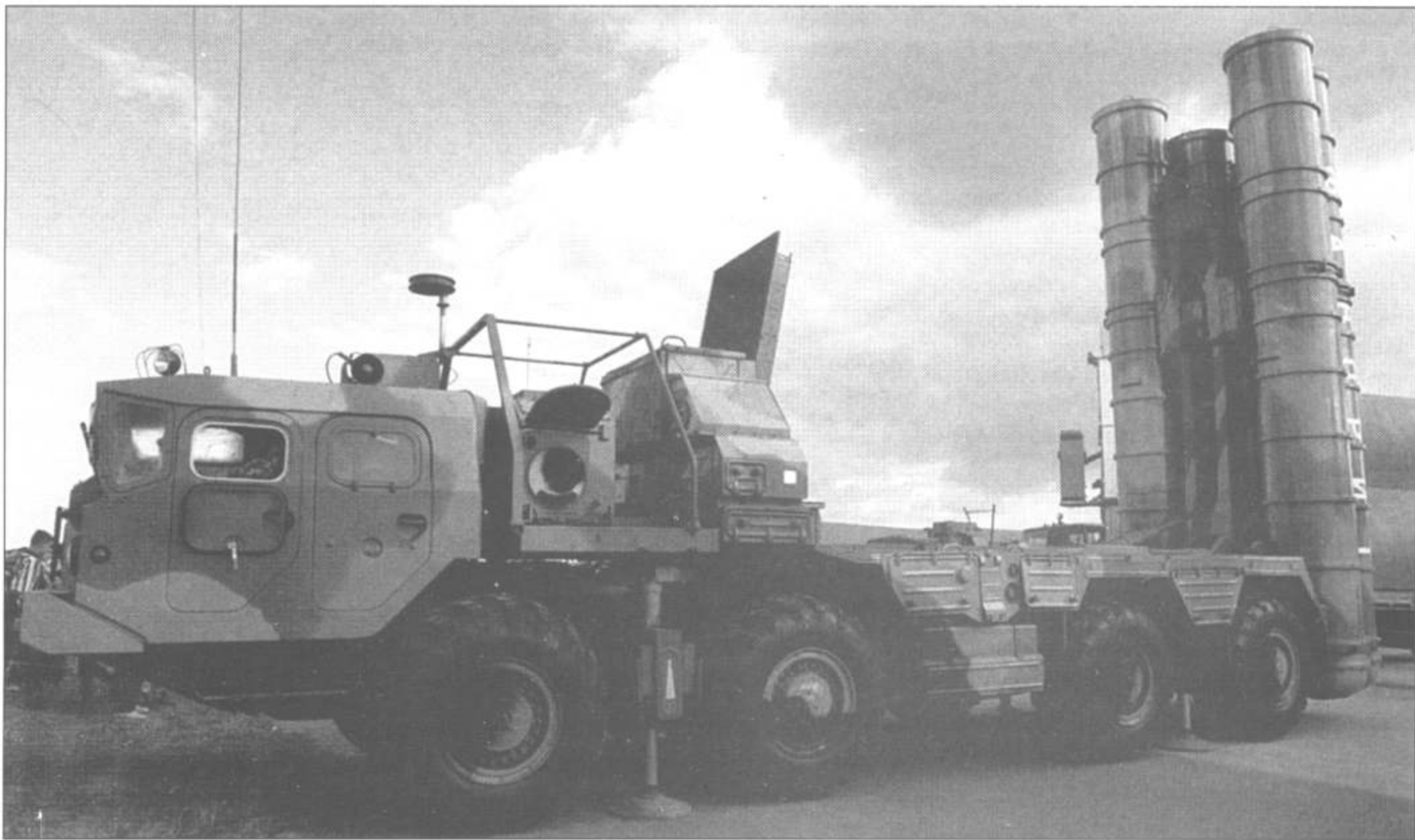
Одна из последних модификаций комплекса С-300: транспортно-заряжающая машина 5П85ДУ комплекса С-300ПМУ-2 «Фаворит». Обычно на выставках машины комплекса красят в более яркий камуфляж. Этот снимок сделан на одном из МАКСов.
