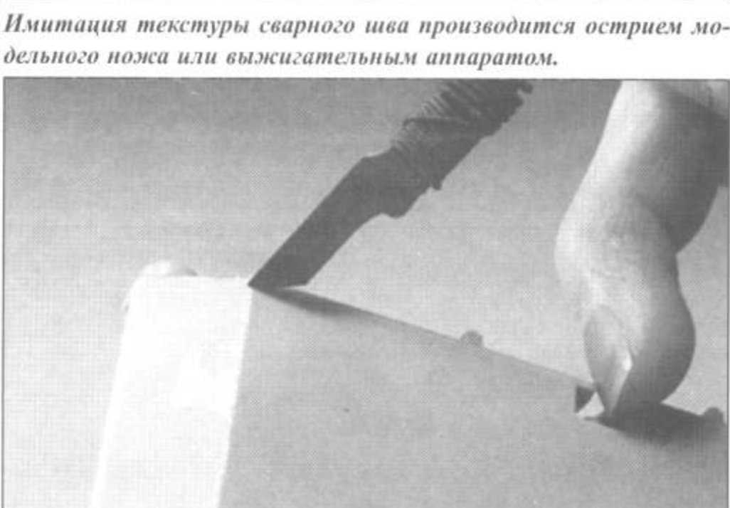
Имитация текстуры сварного шва производится острием модельного ножа или выжигательным аппаратом.
