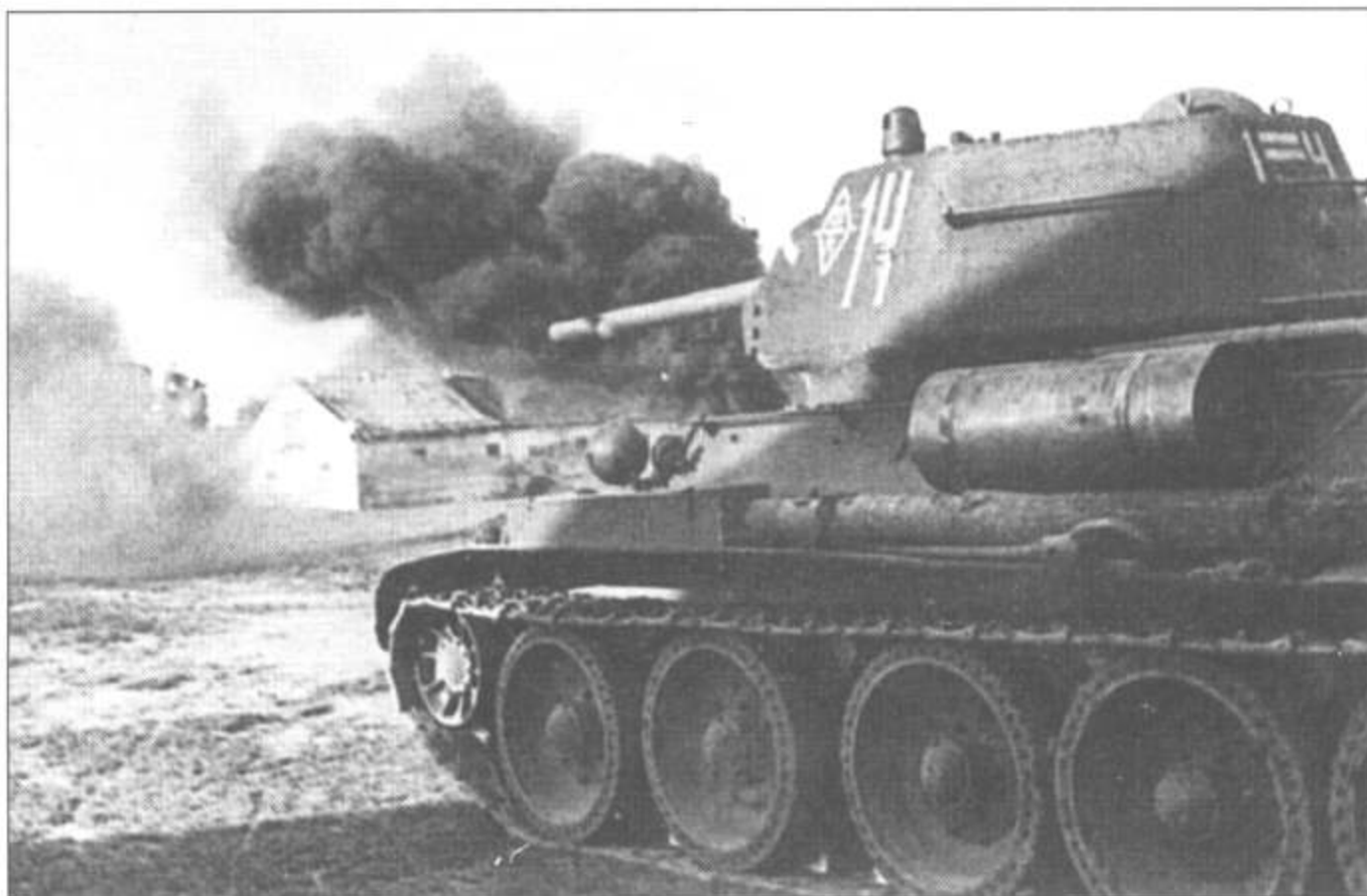
Еще одна фотография танка Т-34-76 образца 1943 г. - опорные катки с резиновым бандажом и сплошными дисками, на корпусе и башне установлены поручни, на борту корпуса закреплен цилиндрический внешний топливный бак. Обратите внимание на бревно для самовытаскивания из грязи.
