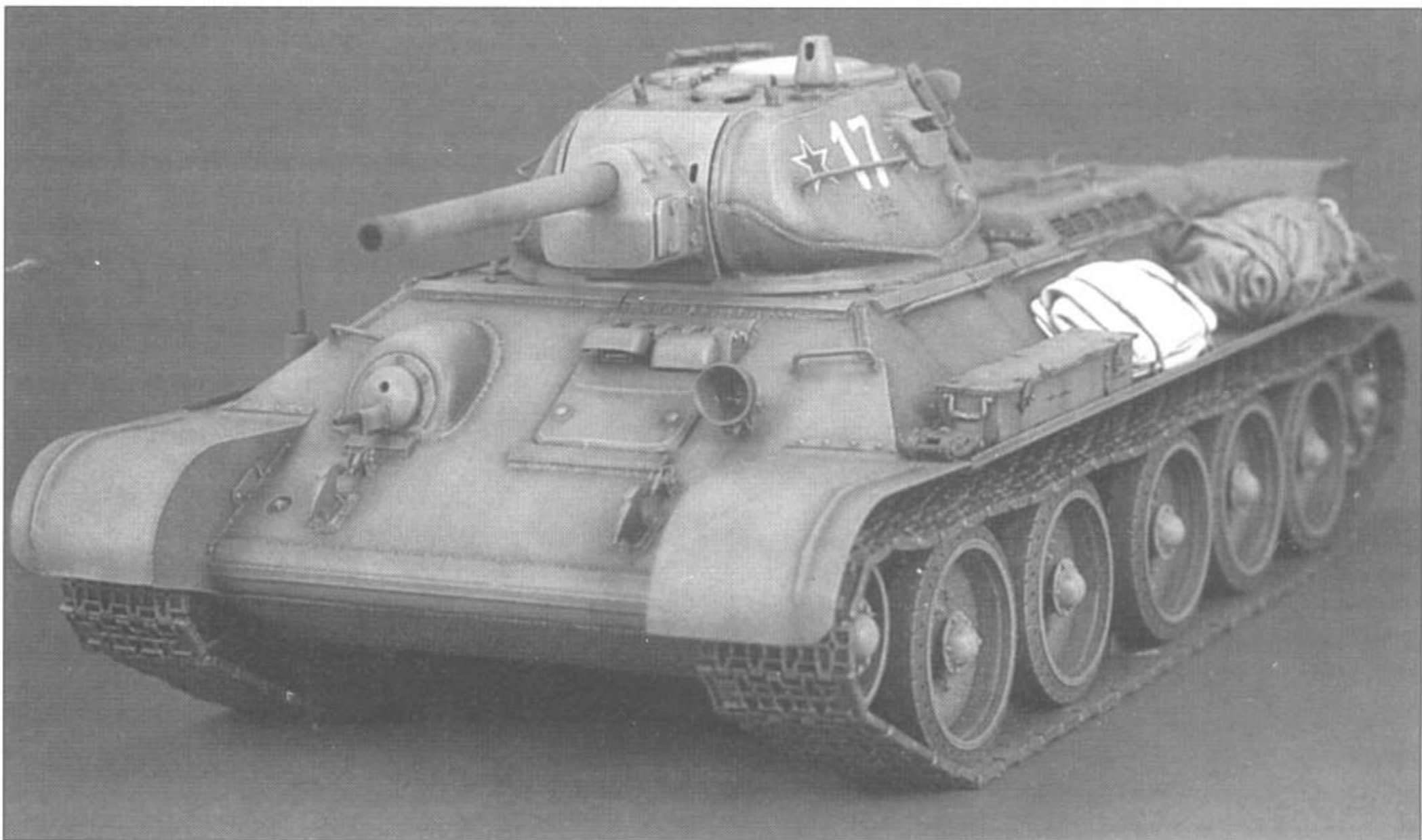
Вид на модель 3/4 спереди, обратите внимание на полоски стали по периметру корпуса, снижающие вероятность заклинивания башни при попадании снарядов.
