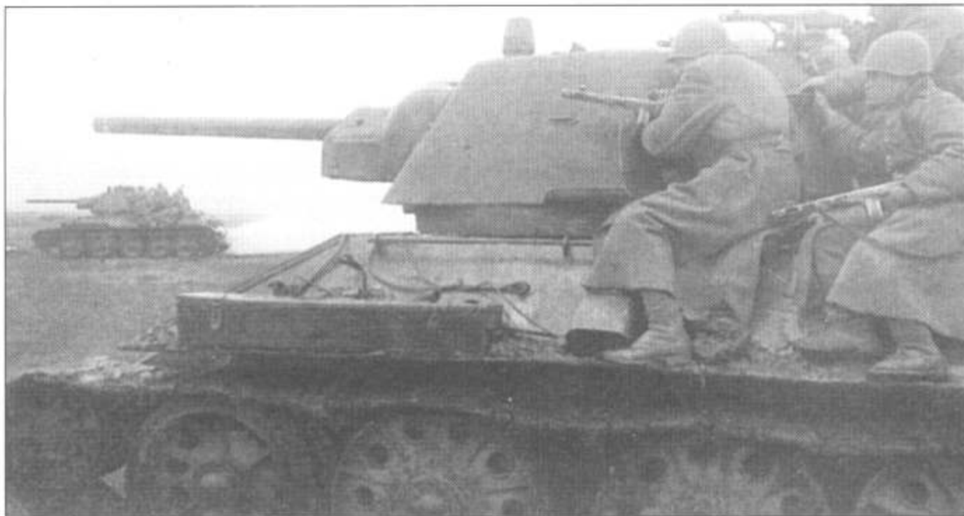
Танк Т-34-76 образца 1943 г. с шестигранной башней. Обратите внимание на ступеньку по линии стыка нижней и верхней литых частей башни. Опорные катки, как минимум, двух типов: передний каток с резиновым бандажом, второй, третий и четвертый - без бандаж. Последний, пятый каток, скорее всего, имеет резиновый бандаж.
