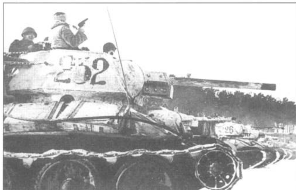
Танк Т-34-76 образца 1943 г. в зимней окраске, сквозь белый цвет проступает зеленая краска. Обратите внимание на закрепленные на борту корпуса ящики из-под 76-мм снарядов. Скорее всего, в ящиках находится имущество танкистов. Танк оснащен радиостанцией.
