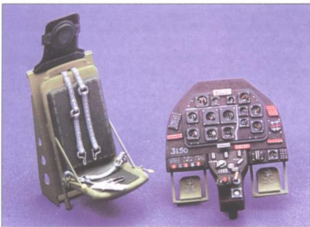
Привязные ремни кресла пилота сделаны из фольги, кресло доработано с использованием медной проволоки. Обратите внимание на качество выполнения и окраски приборной доски.
