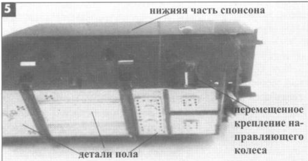
Днище корпуса сделано заново из трех отдельных пластин, доработана ходовая часть.
