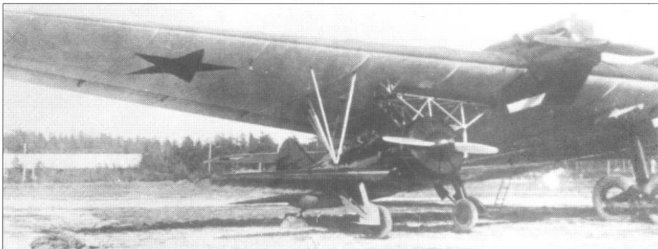
И-16 тип 5 подведен под крыло ТБ-3-4М-17Ф. Шасси истребителя выпущено, он готов к сцепке с носителем.
