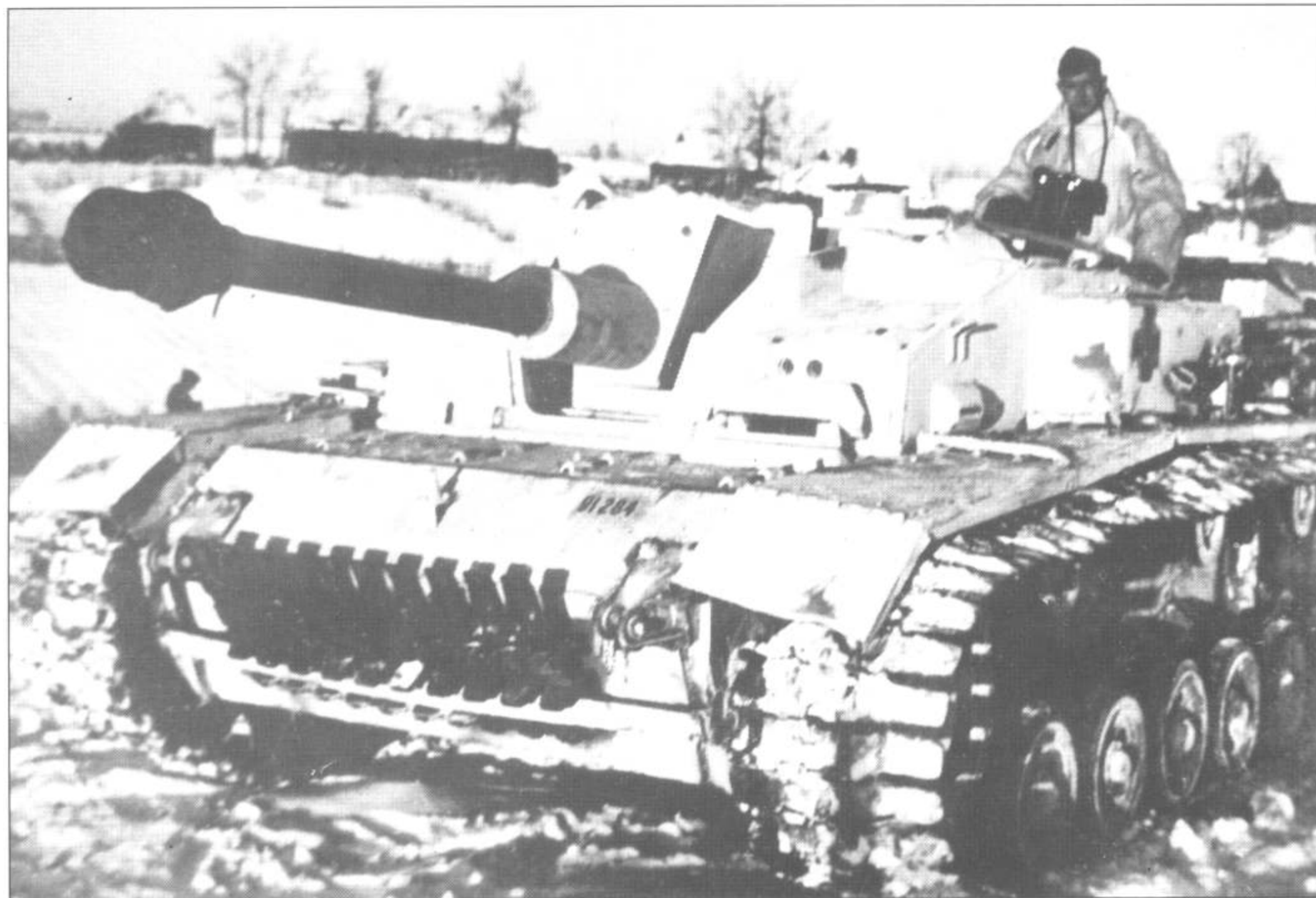
Sturmgeschutz Ausf.F, обратите внимание на зимние траки гусеницы и 75-мм орудие с длиной ствола 48 калибров.
