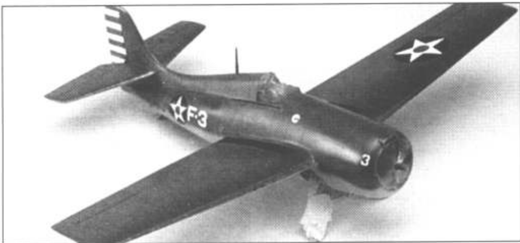
6-18. После нанесения декалей для имитации облеслости краски методом сухой кисти на передние кромки крыла и оперения наносится серебрянка фирмы Тесторз. Методом сухой кисти серебрянкой обрабатываются также поверхности, которые особенно часто испытывают механическое воздействие рук и ног летно-технического состава.
