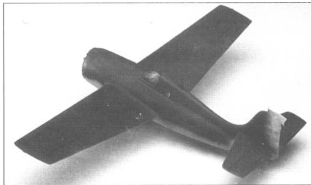
6-12. Верхние поверхности модели окрашены. Очень важно стараться при окраске держать аэрограф под углом, близким к прямому по отношению к окрашиваемой поверхности. В случае с моделями самолетов добиться этого не всегда просто. Важно также выдержать линию разграничения цветов на фюзеляже. После просушки модель целиком задувается глянцевым лаком.
