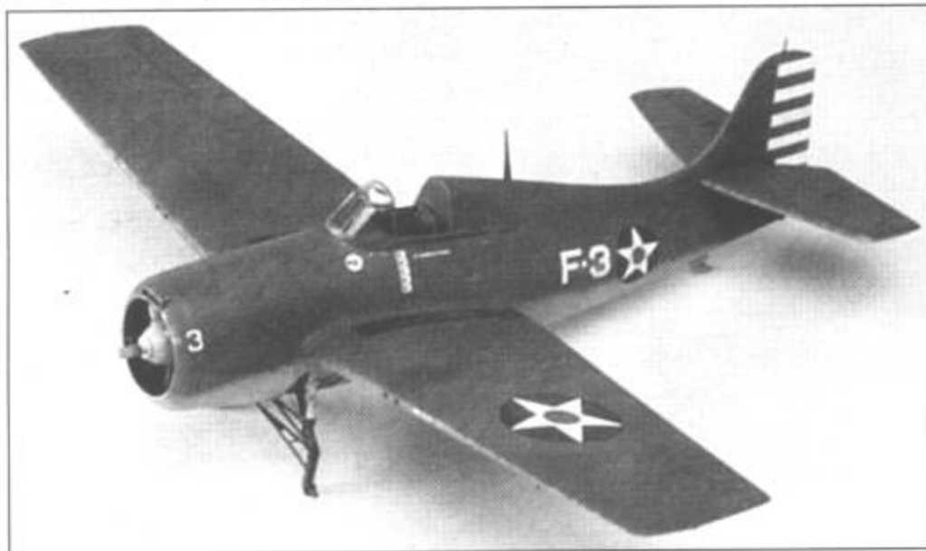
6-19. На верхней поверхности крыла в районе установки пулеметов имитируется нагар от пороховых газов. В районе выхлопных патрубков имитируется копоть. После тонирования модель покрывается лаком.
