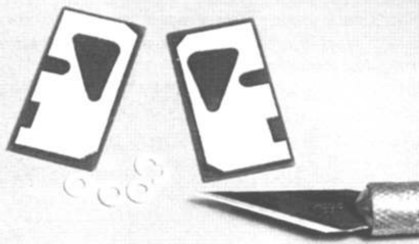
4-60. Кружки пластика выбиты из листа специальными пуансонами. Разрежем кружки на сектора - получатся петли.
