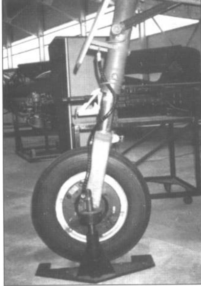
Передняя стойка шасси Me-262 «Швальбе», вид слева.
