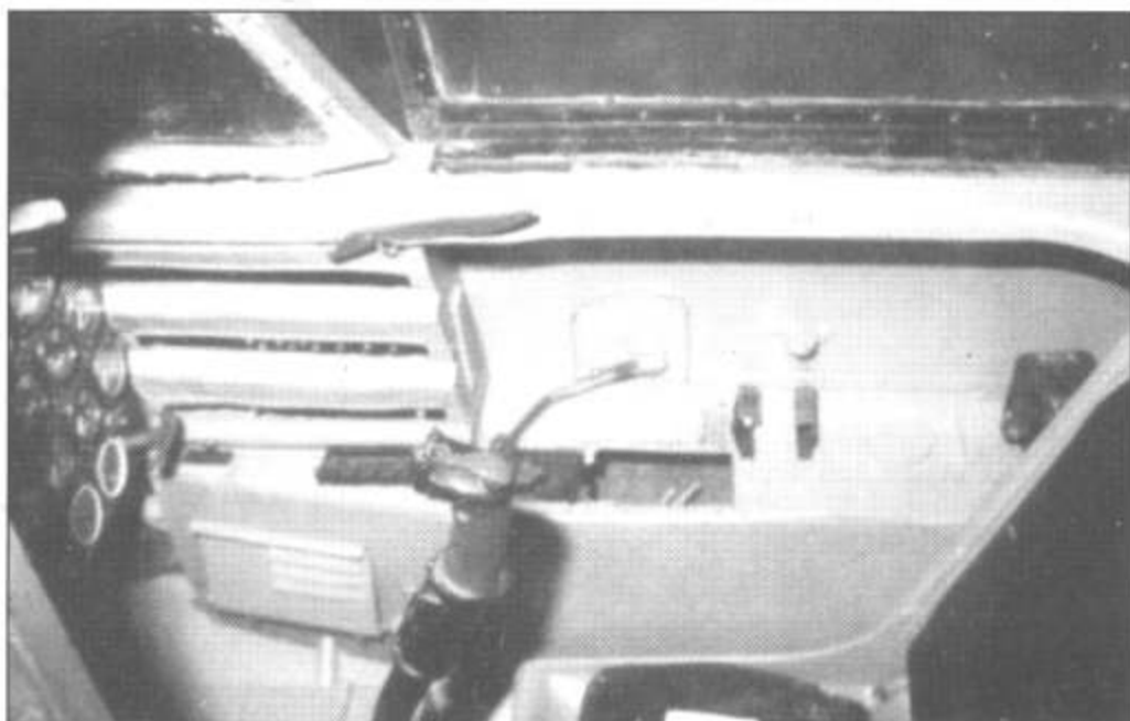
Правая боковая панель, ручка управления, а так же пилотское кресло в кабине Me-262 A-2.
