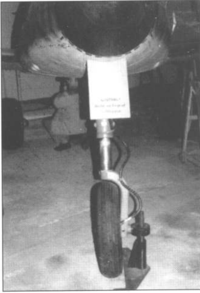
Передняя стойка шасси Me-262 «Швальбе», вид спереди.
