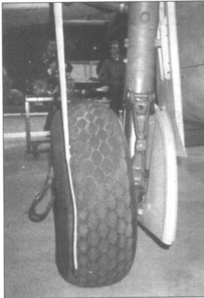
Колесо правой основной стойки шасси, вид сзади. На переднем плане видна антенна типа Morane.
