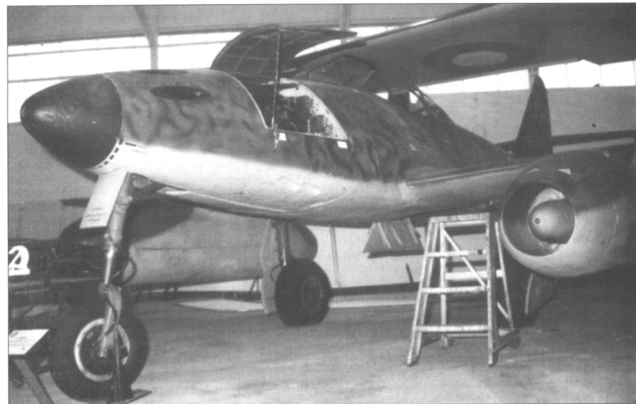
Отреставрированный Me-262 A «Швальбе» в экспозиции музея. Этот же экземпляр «Швальбе». Виден открытый отсек вооружения, в котором размещаются четыре пушки МК 108 калибра 30 мм, а так же открытый фонарь кабины пилота.
