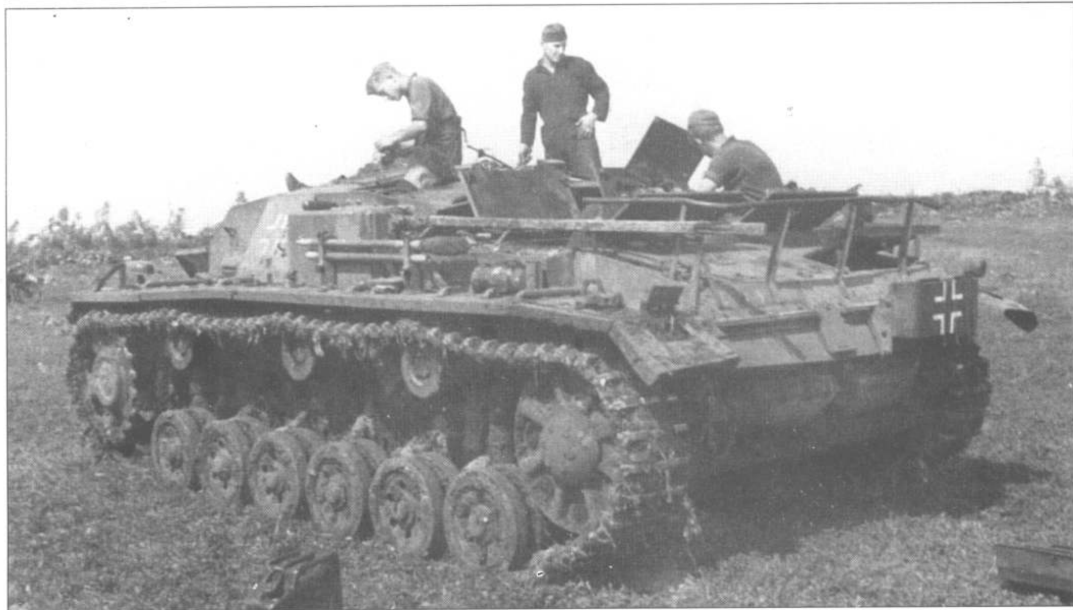
Вид спереди и сзади на прототип нашей модели - штурмовое орудие Ausf.B. Судя по ведущим колесам нового типа и наличию бронеколпака дымопускного устройства, эта машина - позднего выпуска. На корме укреплен рама для перевозки имущества экипажа. Обратите внимание на стоящую на переднем плане немецкую бензиновую канистру - такие же изделия и сейчас сильно распространены на территории бывшего Советского Союза.
