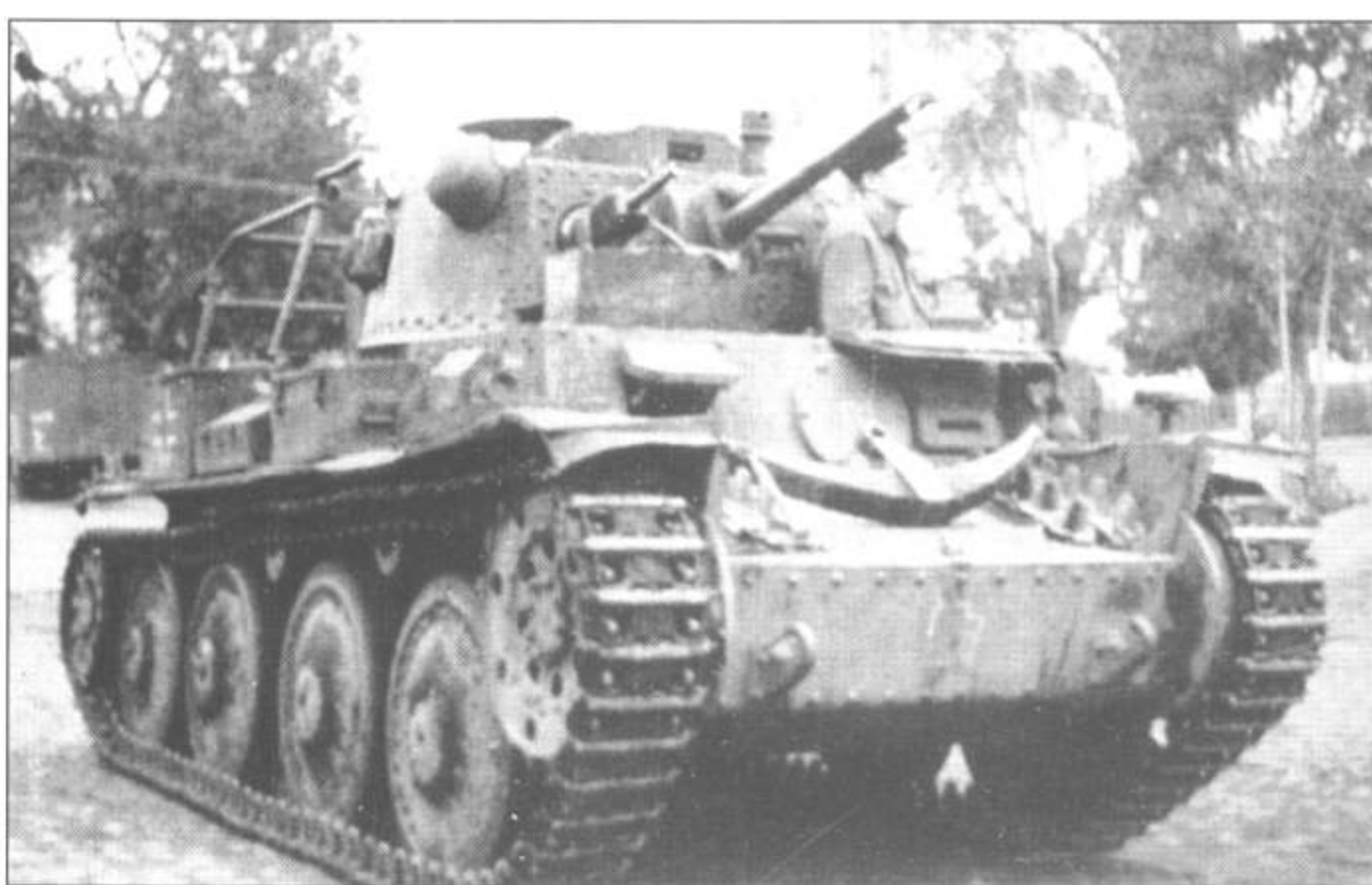
Эта фотография Befehlspanzer 38(t) демонстрирует круглую бронированную «тарелку», прикрепленную болтами в лобовой части корпуса. Запасная рессора, закрепленная на передней части корпуса, пригодится в случае аварии.
