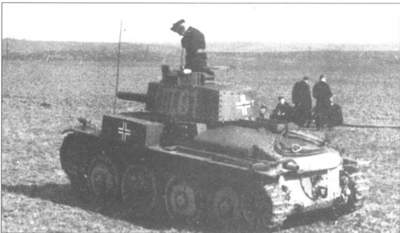
Редкая фотография Befehlspanzer 38 (t) оборудованного двумя штыревыми антеннами. Та, которая находится справа, едва заметна перед командиром танка.
