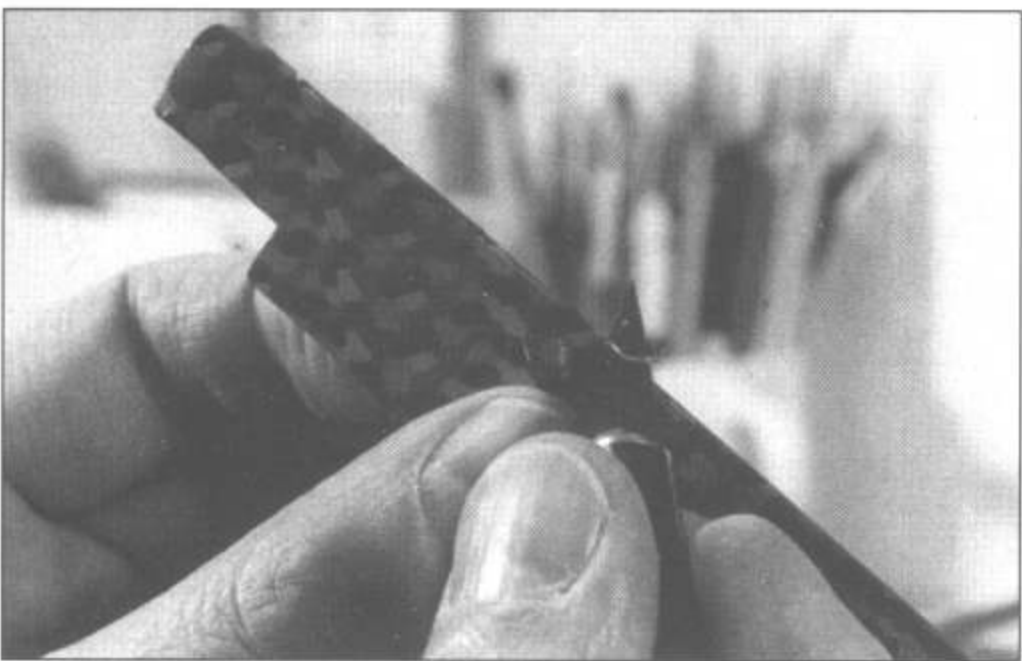
5. После высыхания декалей острым ножом обрезается припуск. Важно не повредить пластик!
