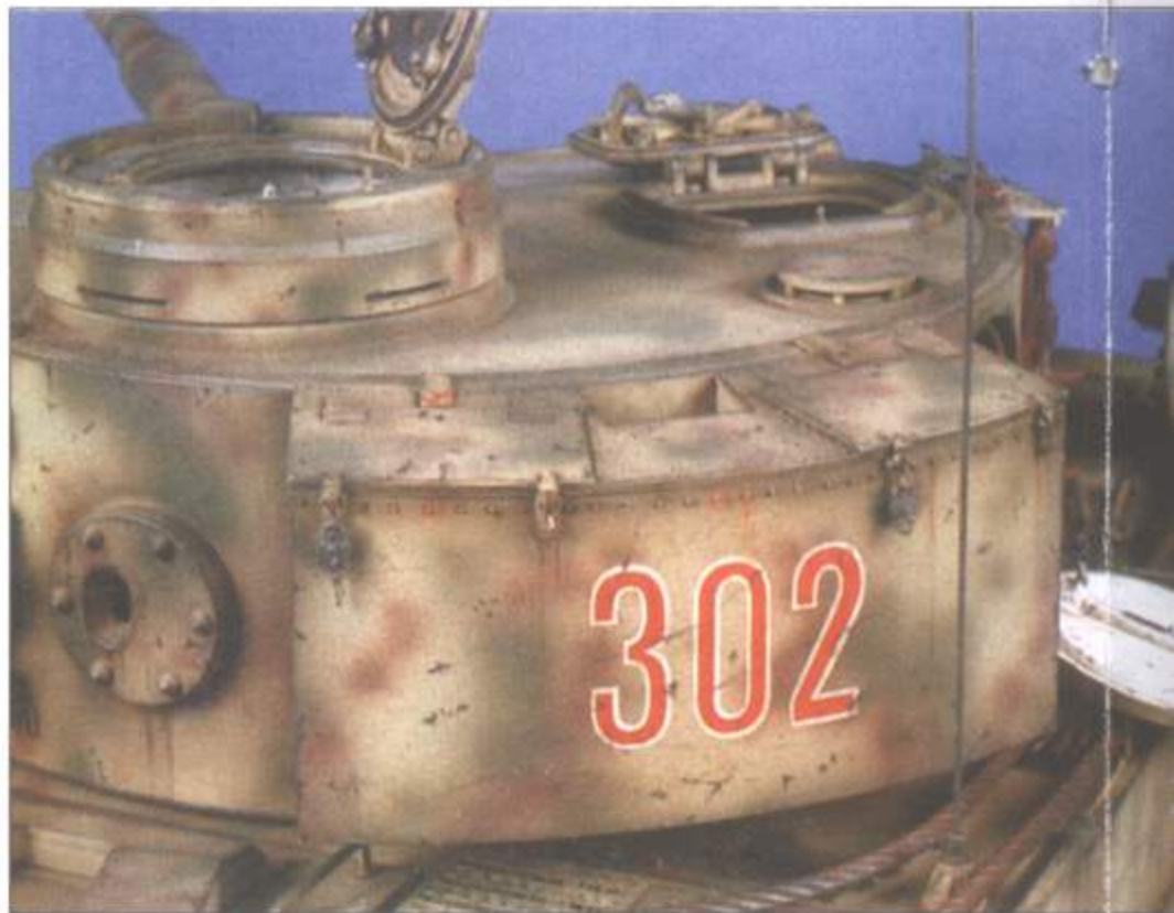
Номер танка был нанесен аэрографом через двойной трафарет. В результате номер получился слишком аккуратным и его пришлось немного испортить царапинами.
