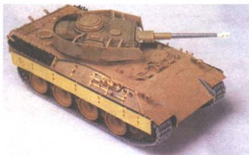
Командирская «Пантера» из 653-го батальона истребителей танков «Фердинад». На верхних снимках представлена неокрашенная модель. Хорошо видны фототравленные детали польской фирмы «Абер», наборные гусеничные траки «Драгона» и точеный ствол орудия производства фирмы Professional Models.
