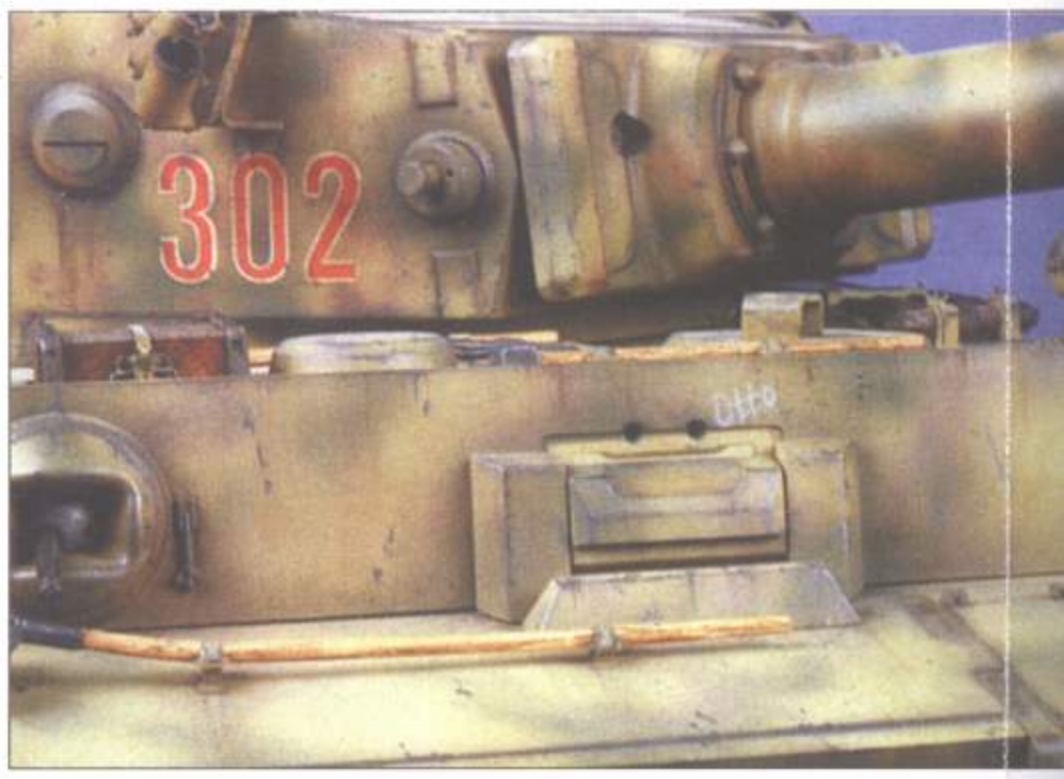
Бронированная створка люка механика-водителя подвижна. Вблизи она открывает два отверстия, предназначенных для перископа.
