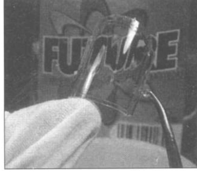
13. Дополнительную прозрачность фонарю придает покрытие составом Future.
