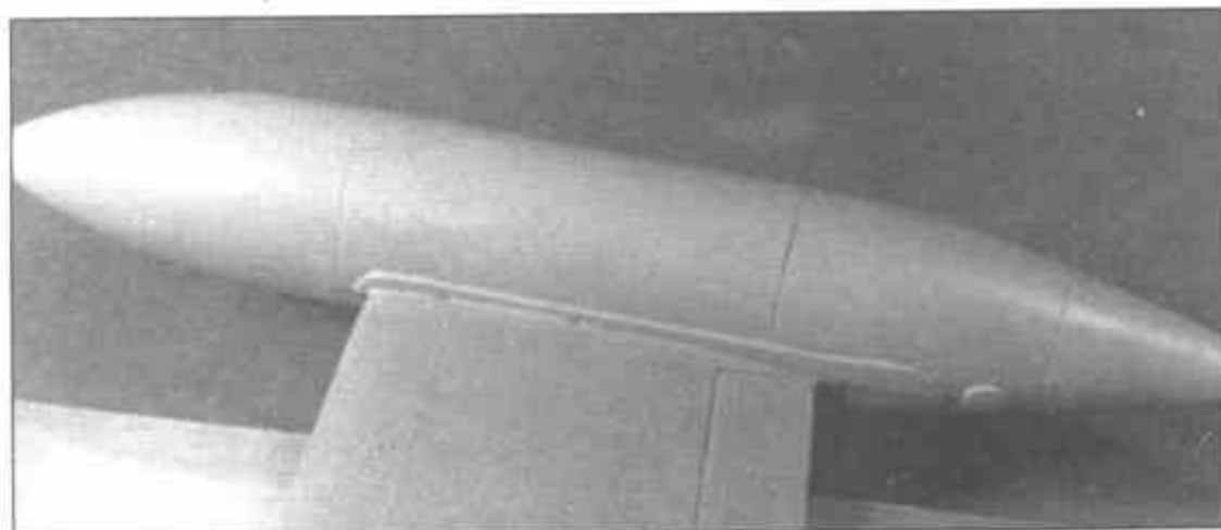
2-12. Еще раз осматриваем бак на предмет обнаружения полостей на поверхности или воздушных пузырьков.
