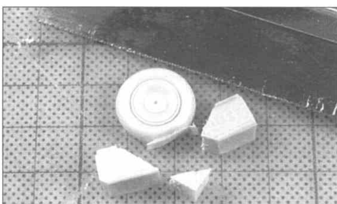
2-1. Первый шаг в работе с отлитым из эпоксидки колесом - это отделение детали от литника. Колесо следует отрезать лезвием как можно ближе к шне.
