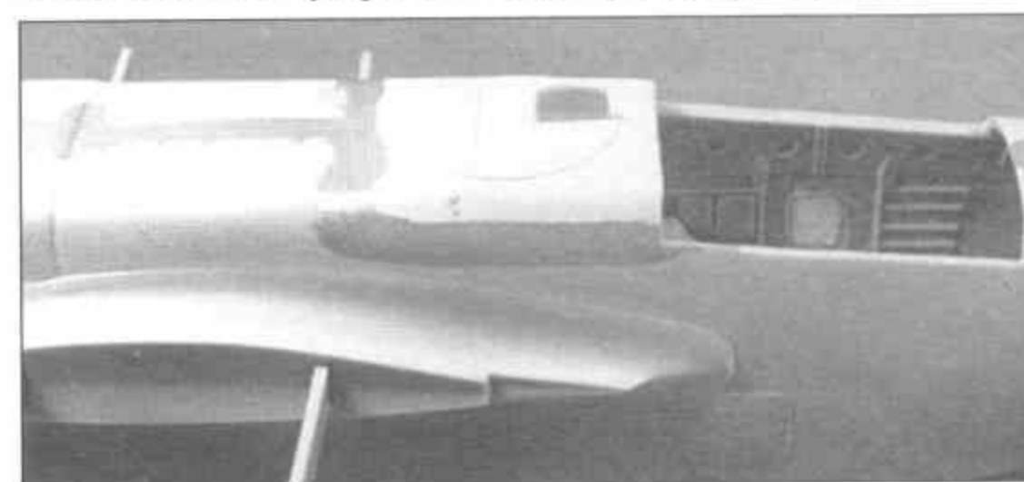
2-19. Серебрянка выявляет даже самые мелкие дефекты поверхности - промазываем швы серебрянкой.
