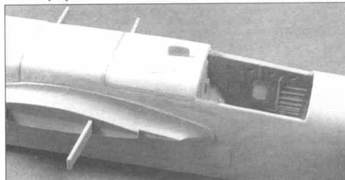
2-18. Осматриваем поверхность детали и швы. Возможно придется добавить «супер глюка» и еще раз все зачистить.
