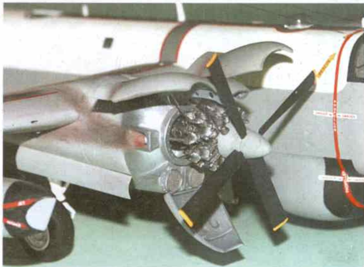
Раскапотированный двигатель Wright R-3350-32W Cyclone, хорошо видна внутренняя часть капотов.
