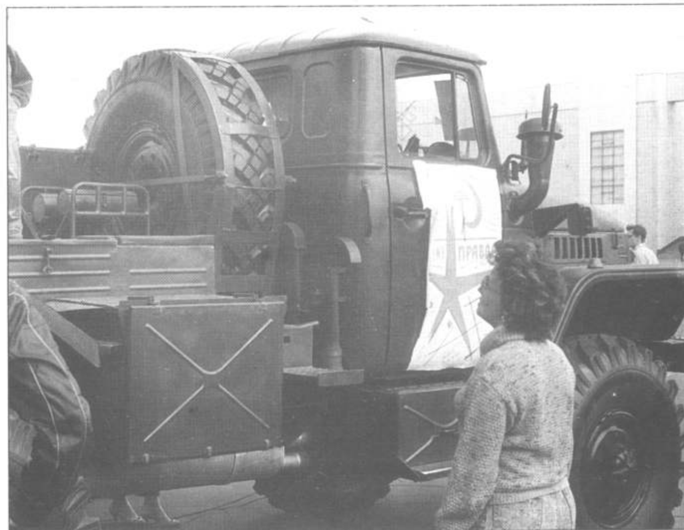
Урал-4320 системы «Град». Справа за кабиной расположены воздухозаборники генератора ПУ. (все фото боевых машин А. Аксенова)
