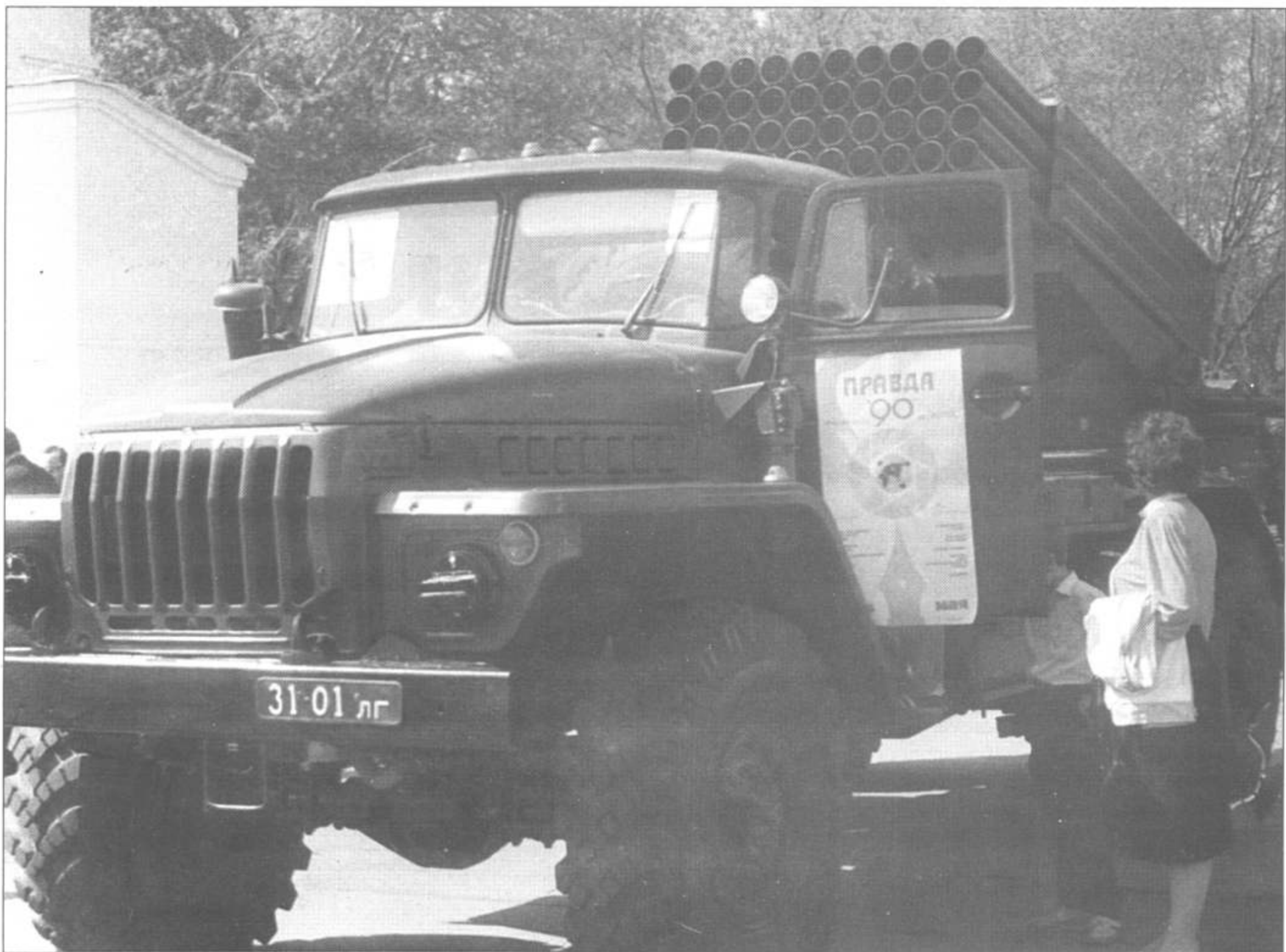
БМ-21-1 крупным планом. Хорошо виден отсутствующий на модели теплозащитный кожух пакета направляющих пусковой установки.
