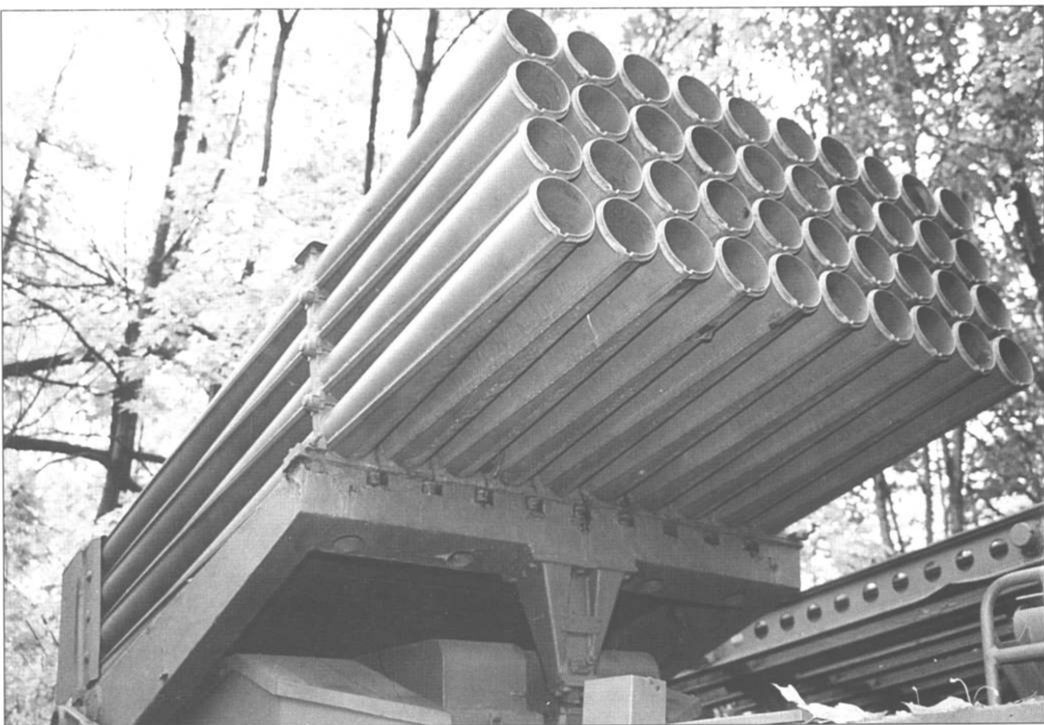
Передняя часть пакета направляющих БМ-21. Дульный срез каждой тонкостенной трубы усилен приваренным кольцом.
