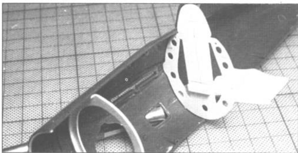
1-42. Примеряем шпангоут к половине фюзеляжа. Важно, чтобы шпангоут занял правильное положение, не отклонялся ни в одной плоскости.
