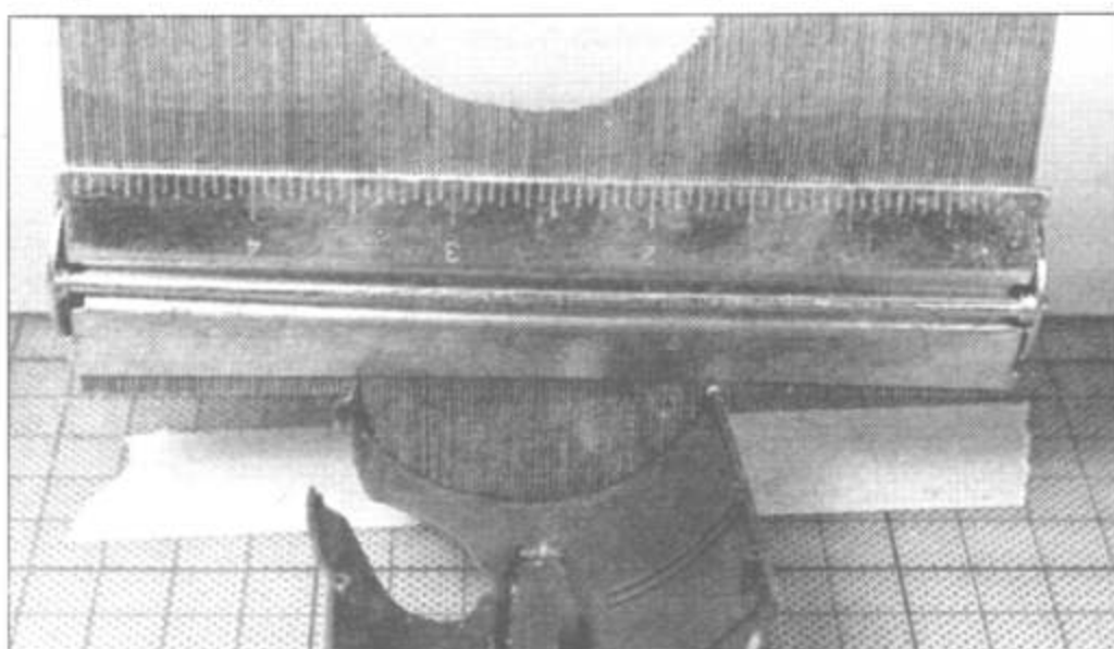
1-4. Хорошим средством определить контур сечения является гофрированный картон. Отрезая кусочки гофра добиваемся полного «погружения» картона в половинку фюзеляжа рядом с приклеенной полоской.
