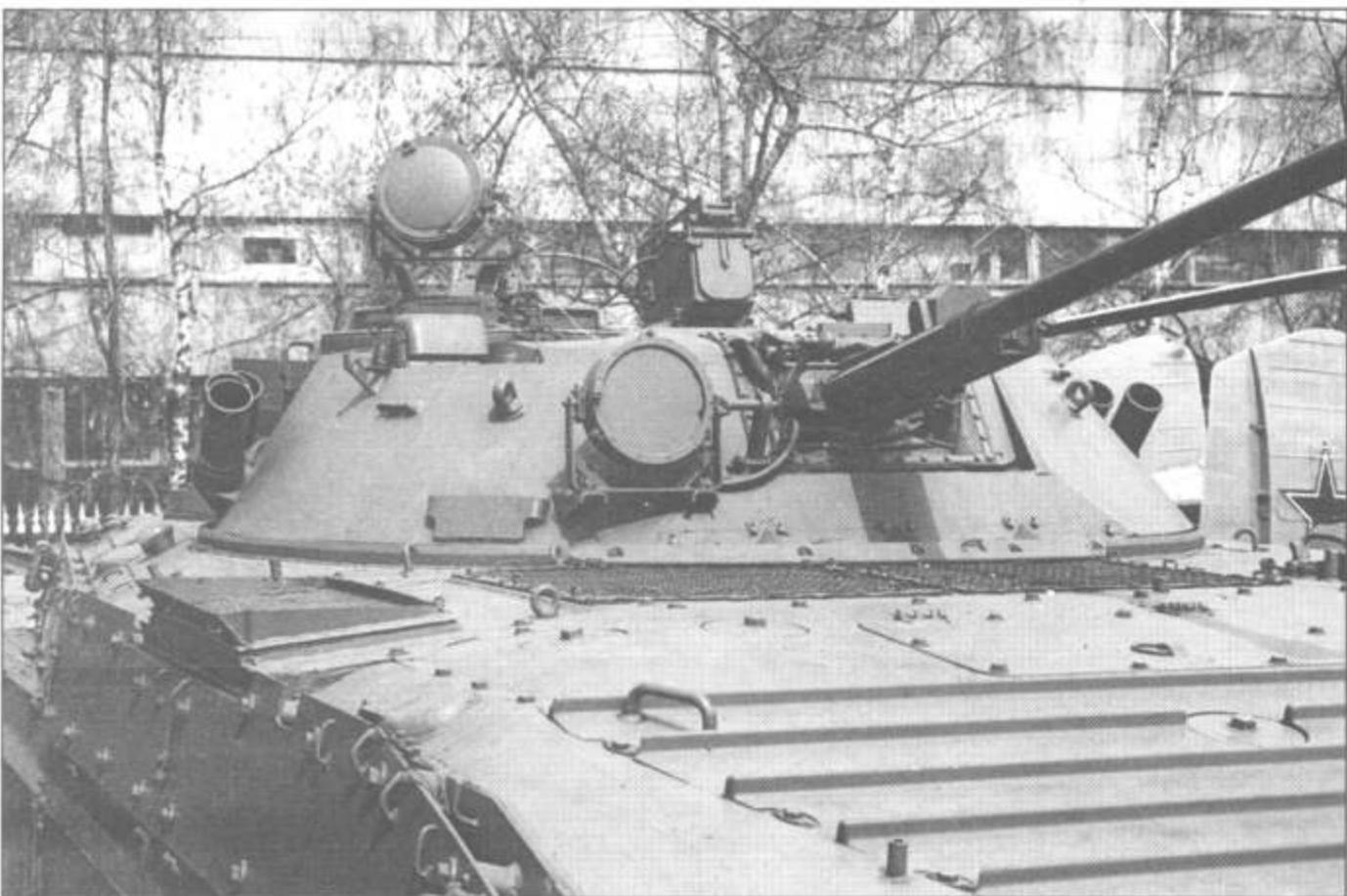
Детали конструкции БМП-2Д из экспозиции музея Советской армии в Москве. Накладная броня на башне этой отсутствует.
