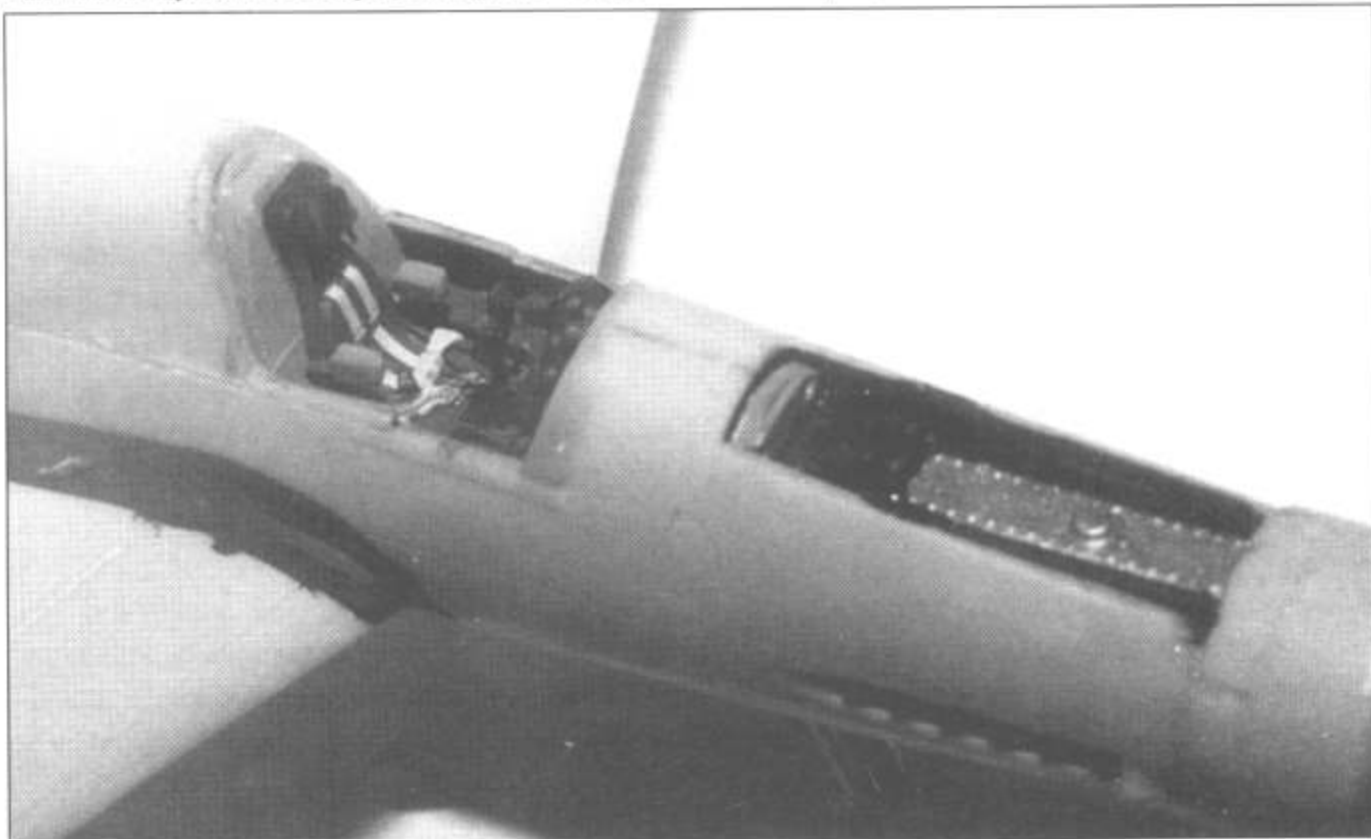
Внутренность кабины пилота только частично дополнена элементами фототравления - просто модель была построена, перед тем как появился подобный набор дополнительных деталей. Черные полосы между крылом и фюзеляжем - это черная акриловая краска, которая после шлифовки выравнивает все неровности на данном переходе крыло-фюзеляж.
