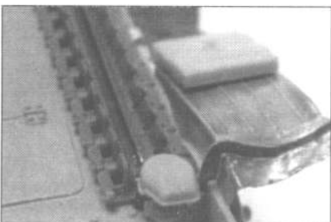
Подкрылок слегка погнут для имитации повреждений.
