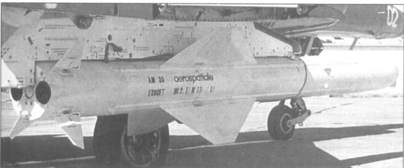
Одна из самых эффективных противокорабельных ракет в своем классе «Экзосет» под крылом Супер Этандара. Аргентинцы успели купить у французов всего пять таких ракет, с началом боевых действий Франция перестала поставлять Аргентине вооружение. Обратите внимание на большое число технических надписей на пилоне.
