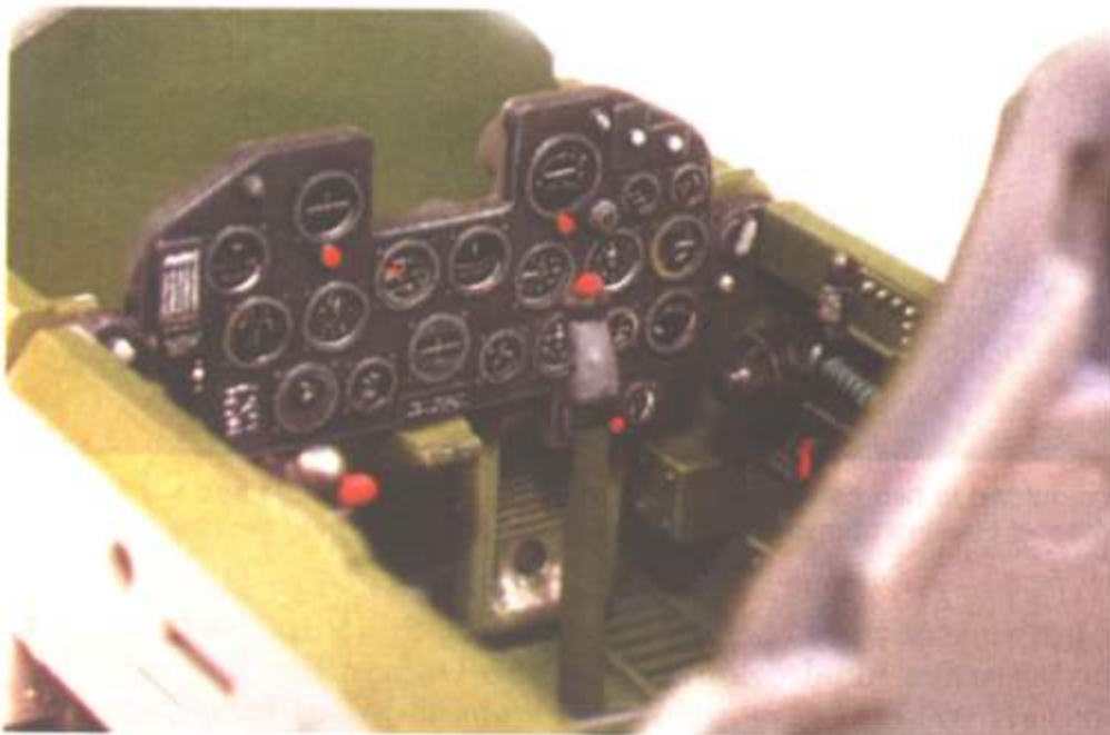
Приборная доска установлена на место. В данном случае не потребовалось никакой дополнительной доработки - только окраска и нанесение декалей. Стандартные детали из набора - превосходны!
