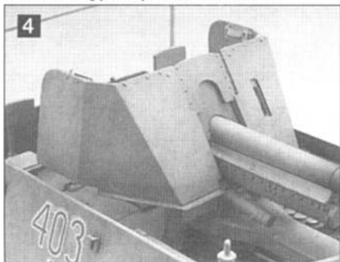
Со щита орудия удалены заклепки
