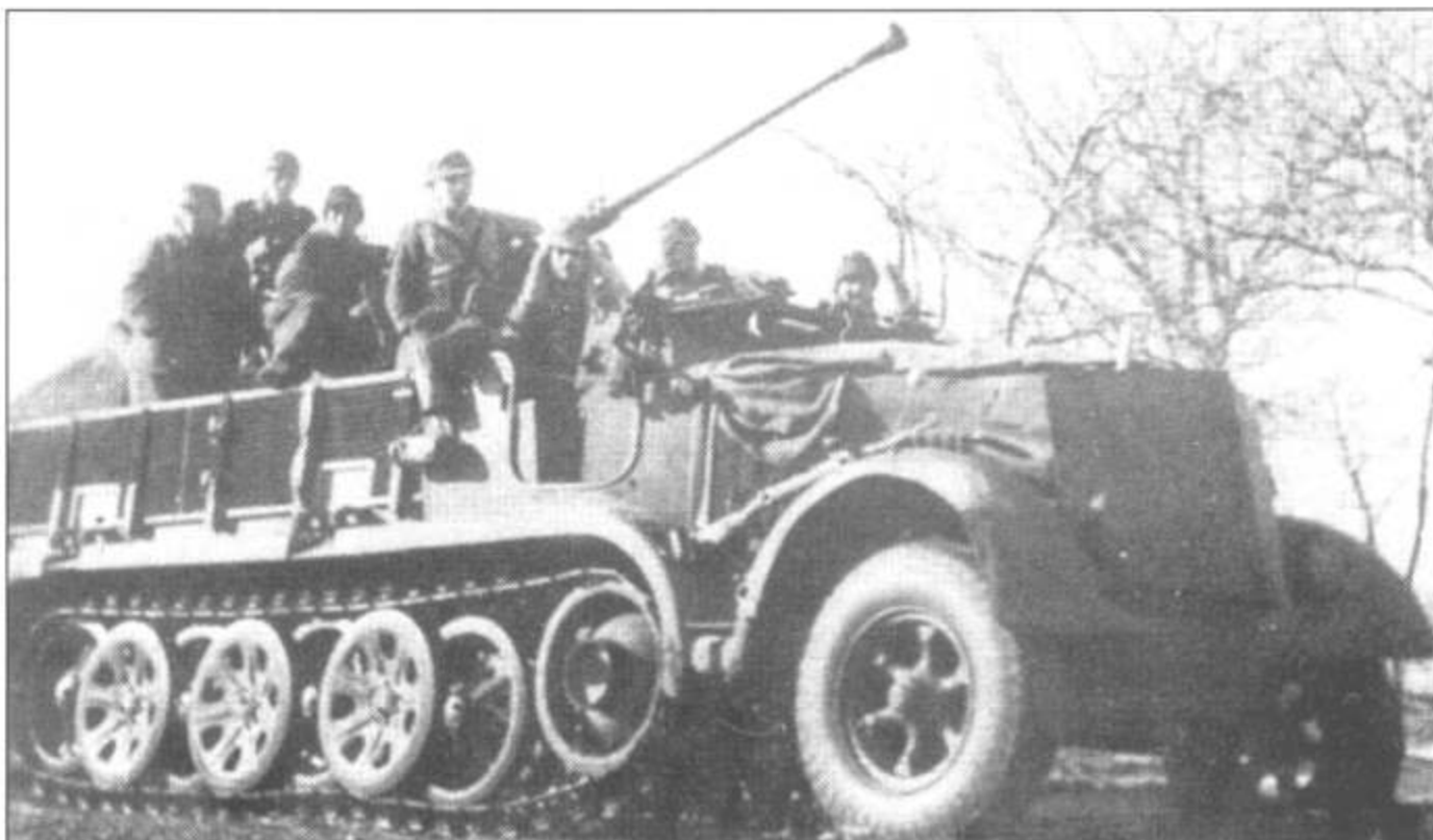
Самоходное зенитное орудие Sd.Kfz. 7/2 вероятно из 290-го дивизиона зенитной артиллерии входящего в состав 4-й танковой дивизии Вермахта. В передней части машины установлена бронеплита прикрывающая двигатель. Белоруссия, весна 1944 года.
