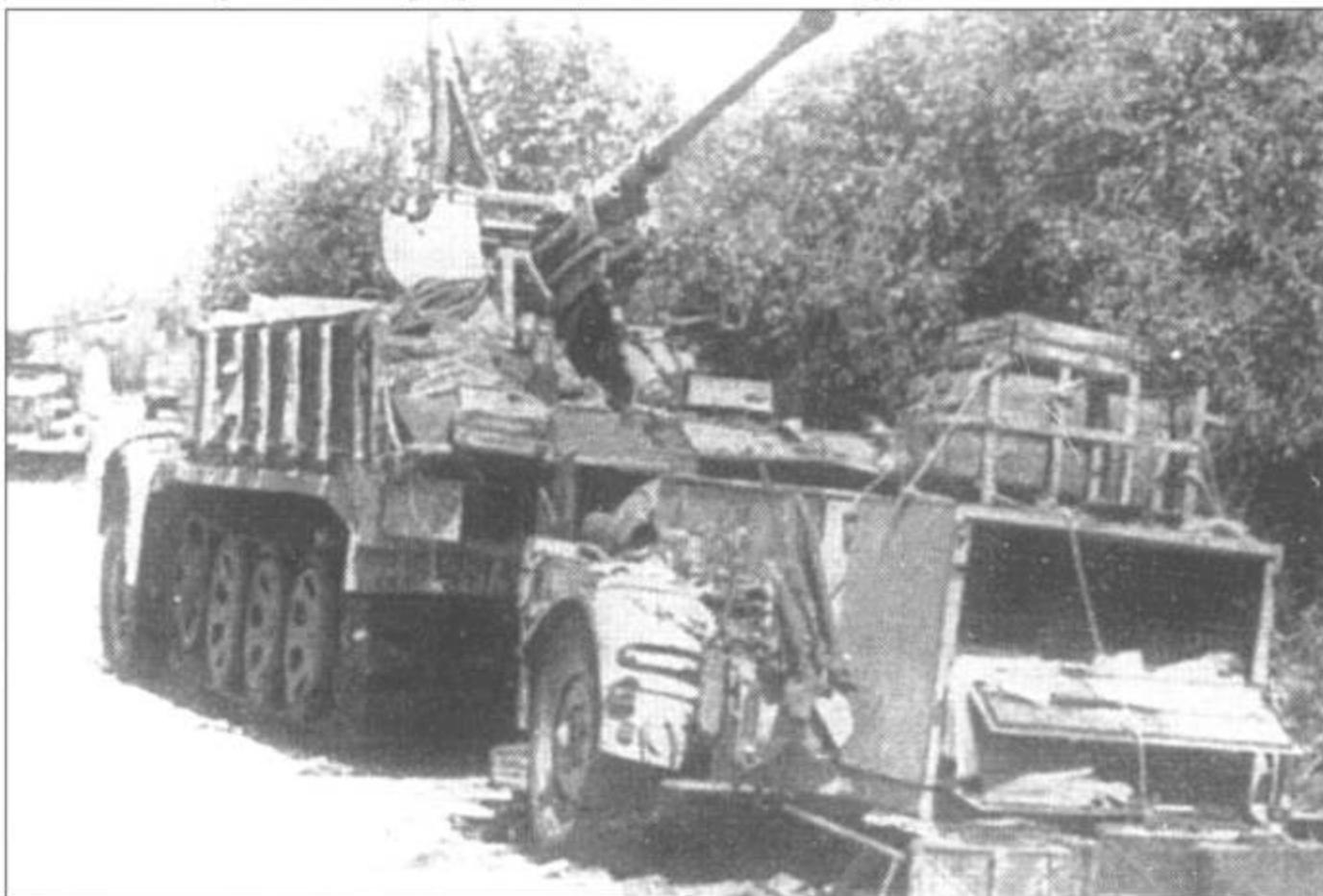
Два самоходных зенитных орудия Sd.Kfz. 7/2 брошенные на одной из дорог Италии, 1944 либо 1945 год. Обратите внимание на одноосный прицеп с амуницией.
