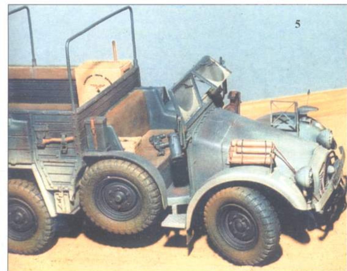
Фото 3. Окрашенная модель - вид сзади. Грязевые щитки колес выполнены из фольги, видны нанесенные следы эксплуатации.
