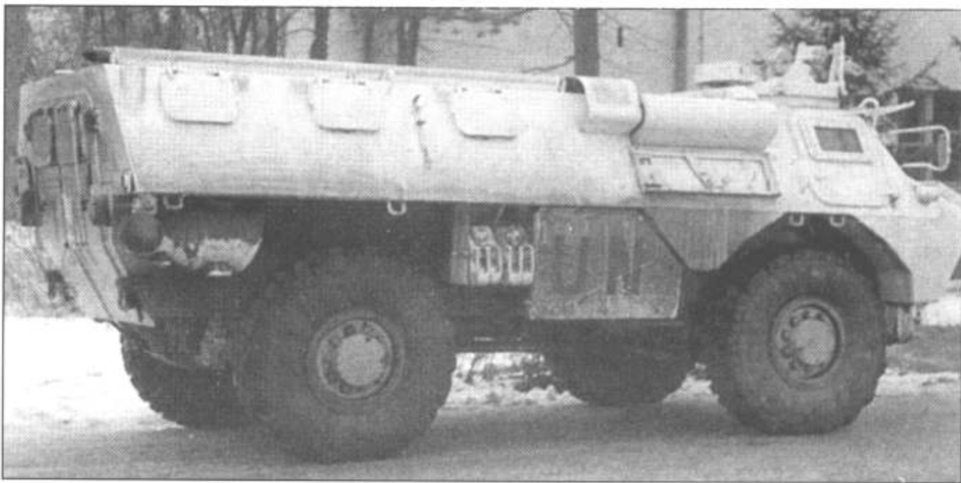
Кормовая часть этого VAB из французского контингента ООН в Сараево испещрена пулевыми попаданиями. Машина оснащена башней с 20-мм пушкой.
