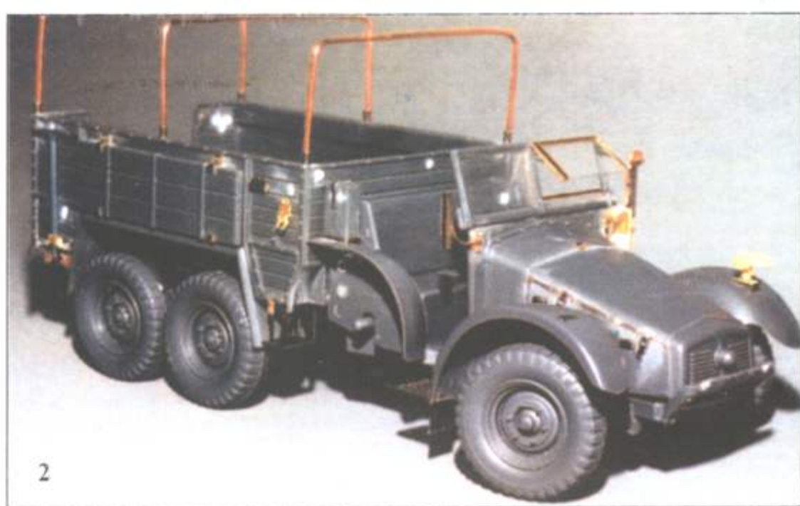
Фото 1. Модель перед окраской, хорошо видны установленные фототравленные детали из набора Aber. В левой задней части кузова виден сделанный заново ящик для инструмента. Так же видны зашпаклеванные места.
