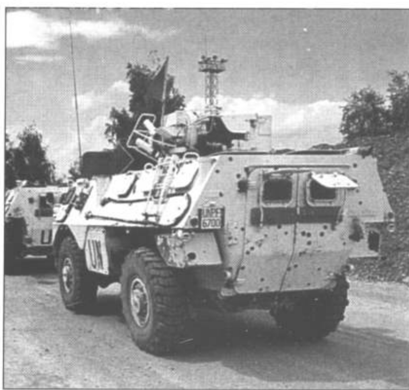
Кормовая часть этого VAB из французского контингента ООН в Сараево испещрена пулевыми попаданиями. Машина оснащена башней с 20-мм пушкой.
