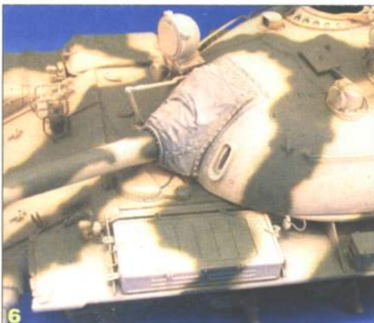
6 Пятна камуфляжа имеют неправильную форму. Из-за сложной формы поверхности (наличие щелей между ящиками и т.д.) после работы аэро-графом обязательно остаются огрехи, которые можно устранить опять же аэро-графом или кисточкой.
