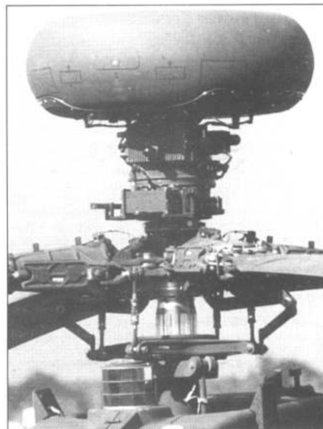
Ротор несущего винта AH-64D оснащен радаром кругового обзора.
