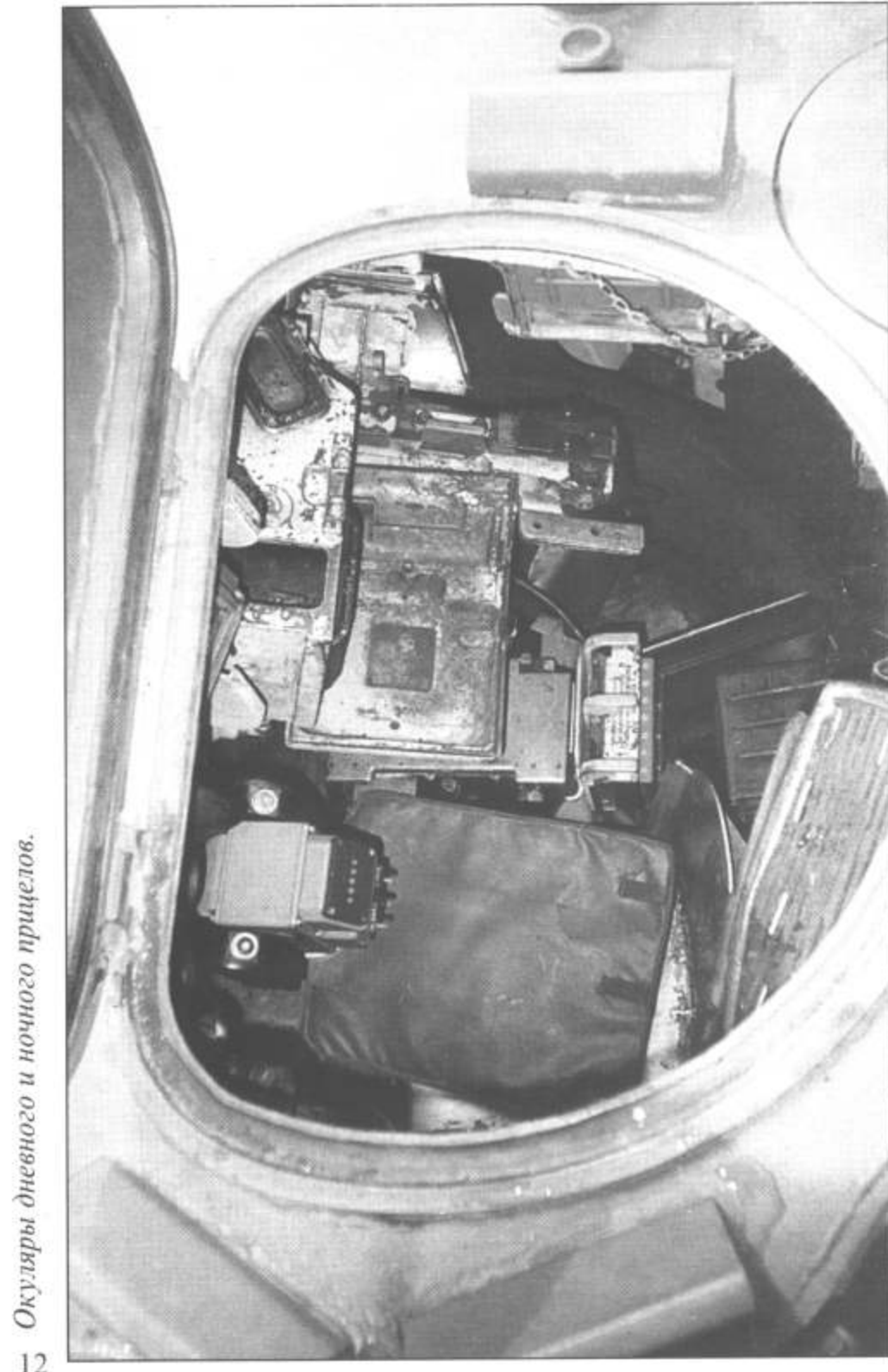
Вид вниз через открытый башенный люк. Перед сиденьем расположены рукоятки управления стрельбой.
