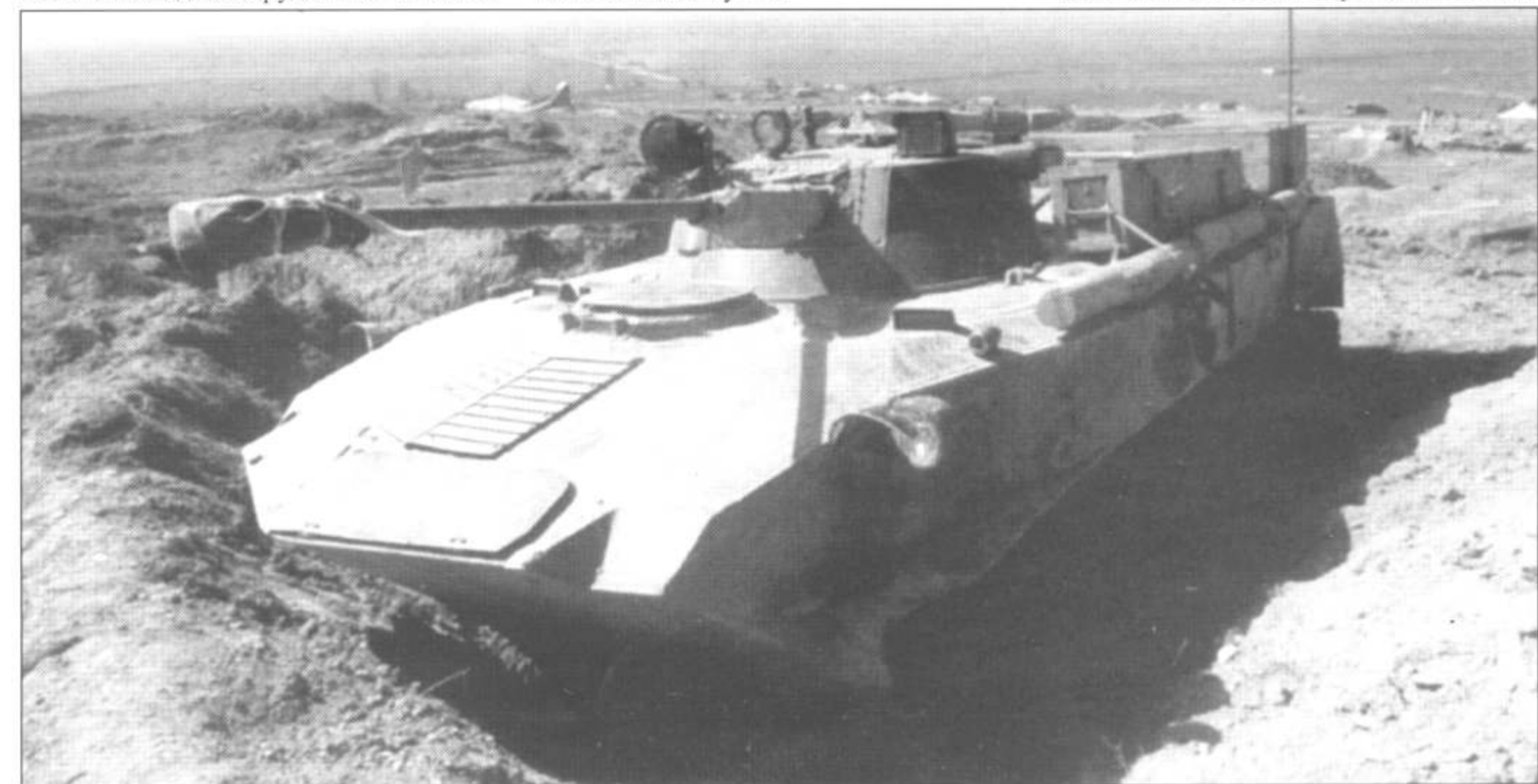
БМД-2 на позиции в Чечне, 9 апреля 1995 г. Машина покрыта пылью, тактический номер замазан грязью, на борту лежит бревно для самовытаскивания, на корме - ящики с боезапасом. Ствол укрыт брезентом. (фото А. Ефремова)
