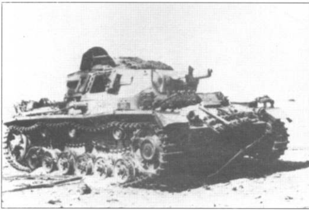
Типичные повреждения подбитой машины: горелая резина бандажей опорных катков, открытые люки, сброшенные запасные гусеничные траки, крылья погнуты.
