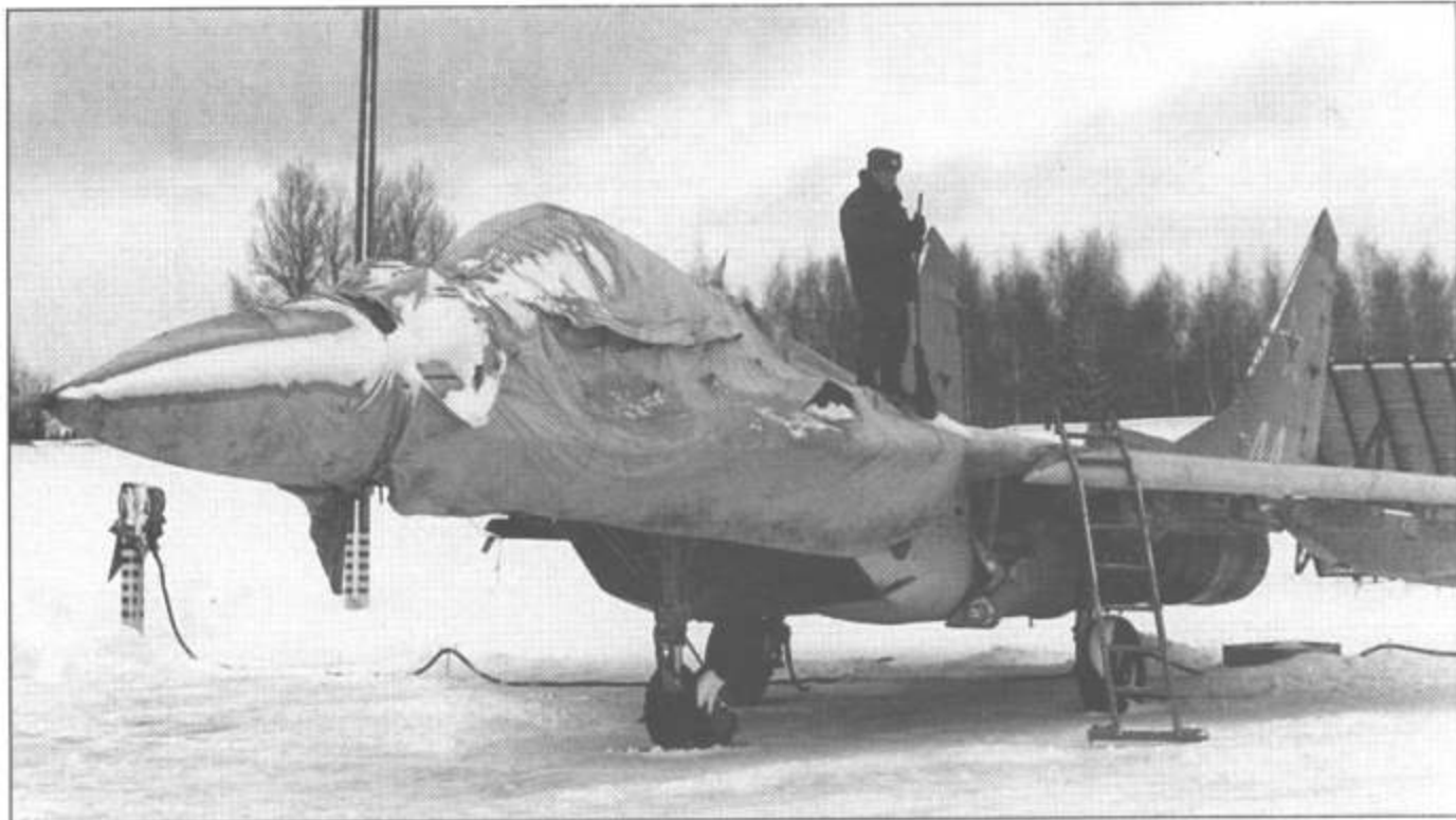
Самолеты пилотажной группы хранятся под открытым небом, поэтому идет интенсивное старение лако-красочного покрытия.
