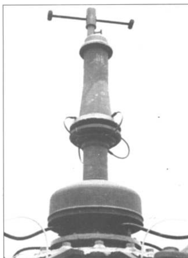
Ротор несущего винта венчает датчик погоды. Он определяет температуру воздуха, давление, направление и скорость ветра.
