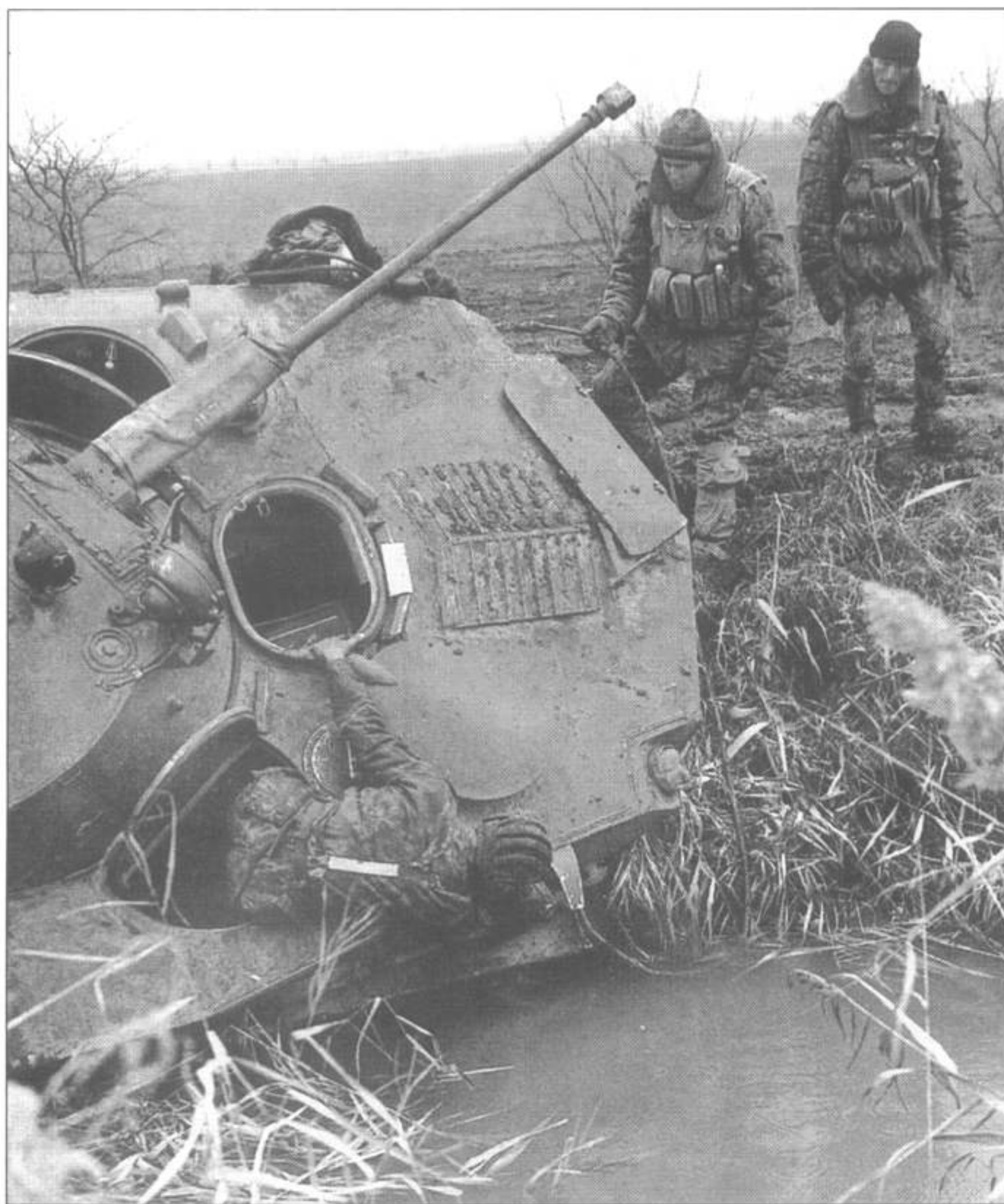
Чечня: БМД-2 сползла в яму с водой. Обратите внимание на проводку к ИК-прожектору на башне. На этом фото часть ствола пушки укрыта брезентовым чехлом.
