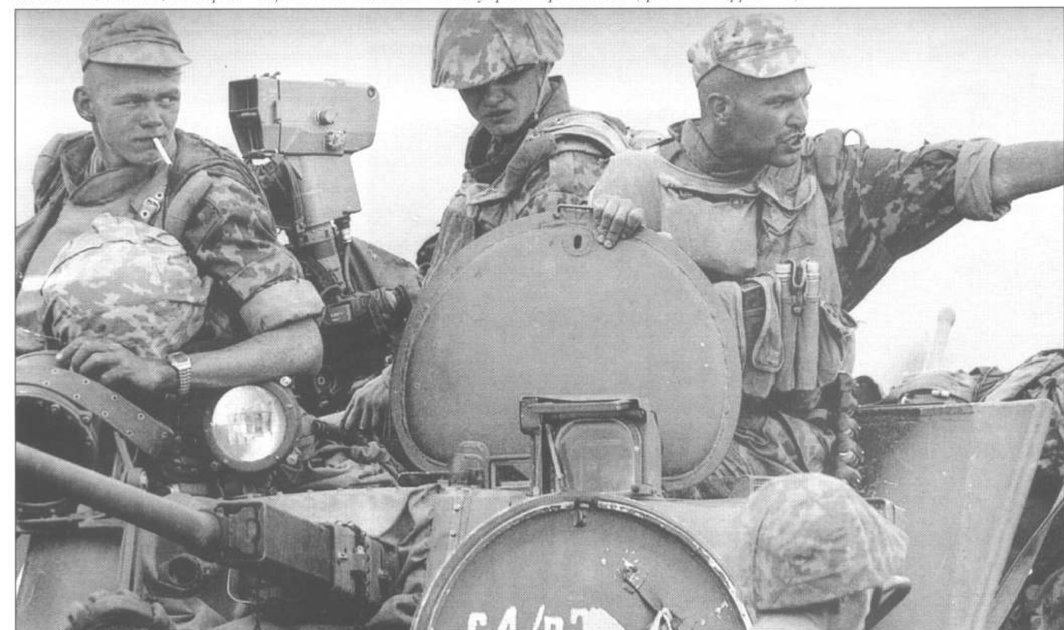
Крупный план башни БМД-2. Брезент с орудия снят, обратите внимание на маленькую ручку на самом верху люка командира. Внутренняя часть люка водителя окрашена в зеленый цвет, видны сколы краски до металла. Фото сделано в Чечне во время спецоперации.
