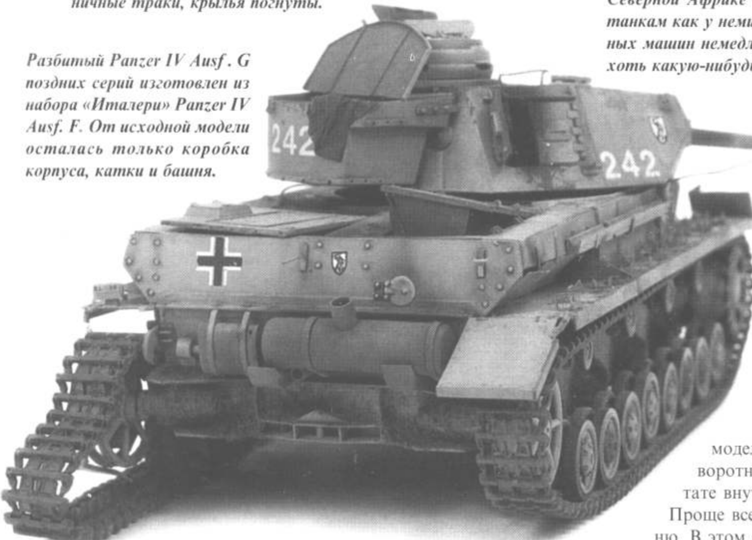
Типичные повреждения подбитой машины: горелая резина бандажей опорных катков, открытые люки, сброшенные запасные гусеничные траки, крылья погнуты.
