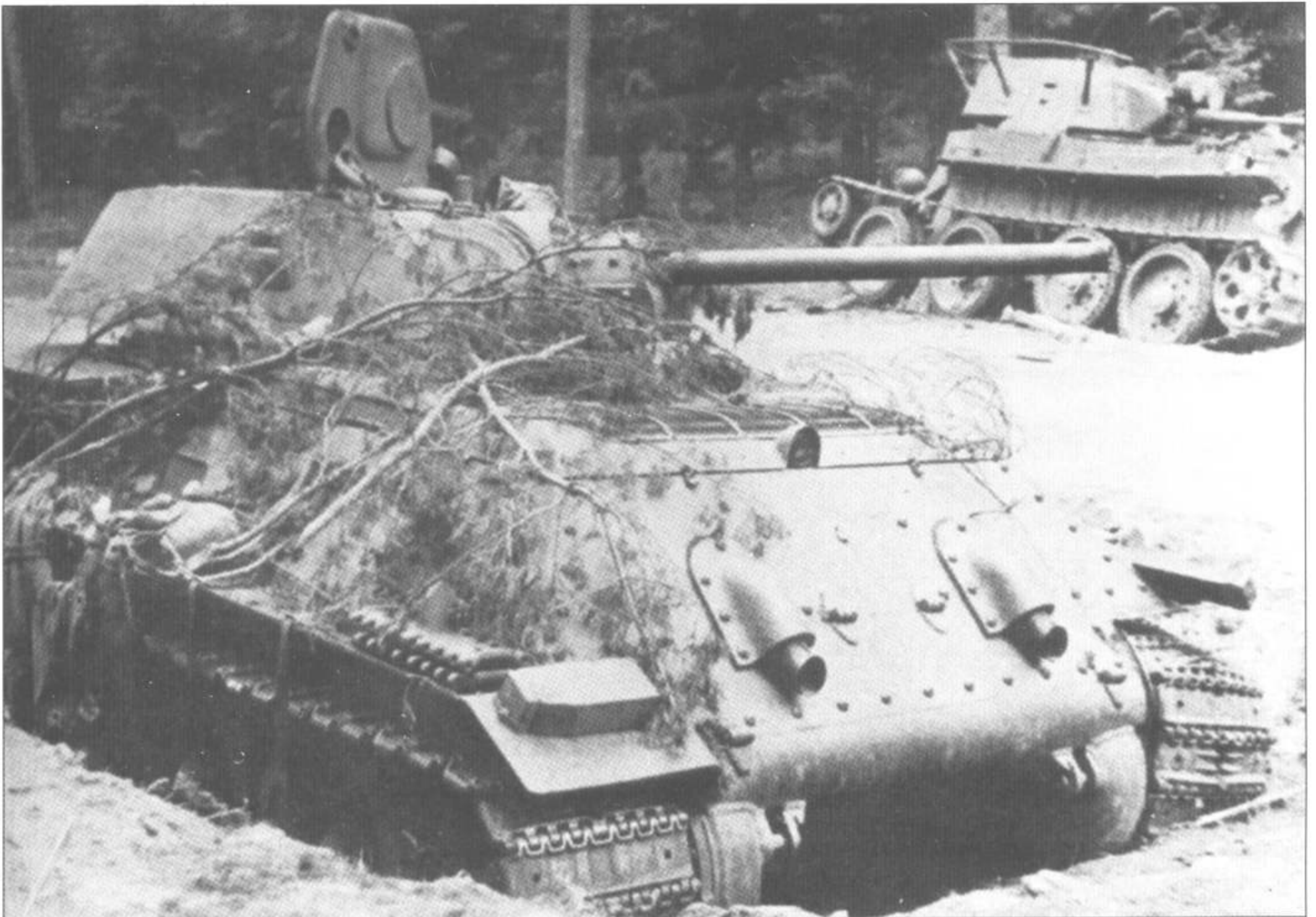
Т-34 обр. 1941 г. с пушкой Ф-34. Такое обозначение принято для удобства. Более правильно говорить не образца, а выпуска 1941 г., так как в официальной документации военных лет Т-34 на образцы не делились. С марта 1941 г. на танки Т-34 стали устанавливать пушку Ф-34 вместо Л-11. Хорошо видны отличия танков выпуска 1940/41 гг: квадратный трансмиссионный люк, фара в центре надмоторной решетки, деревянные чурбаки на крыльях, закругленный низ кормового листа, заваренное отверстие для смотрового прибора кругового обзора в крышке люка башни.
