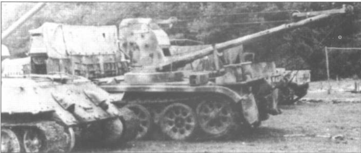
Сфотографированный, возможно, на площадке поврежденных на фронте машин, SdKfz 9/1 , оснащенный 6-тонным краном, рядом с T-34/76 . Здесь хорошо виден поднятый в верхнее положение ствол его орудия.
