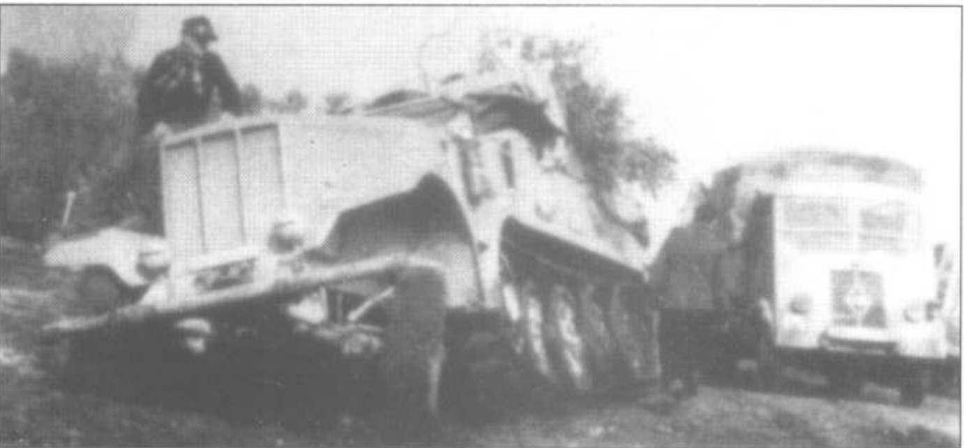
FAMO в активной работе дублирует Renault AHN . Эта машина относится к последней серии выпуска, узнаваемой по обрезанным плоским крыльям и трубчатому бамперу.
