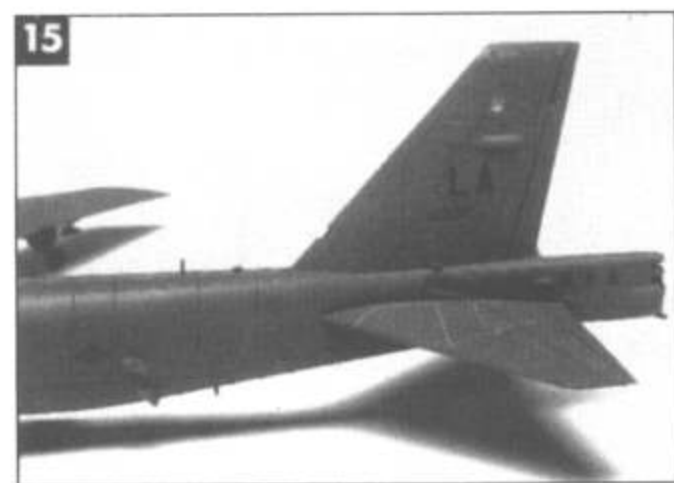
15 Маркировка вертикального оперения состоит из буквенного кода, эмблемы САК ВВС США, серийного номера самолета и голубой полосы 2-го бомбардировочного авиакрыла.
