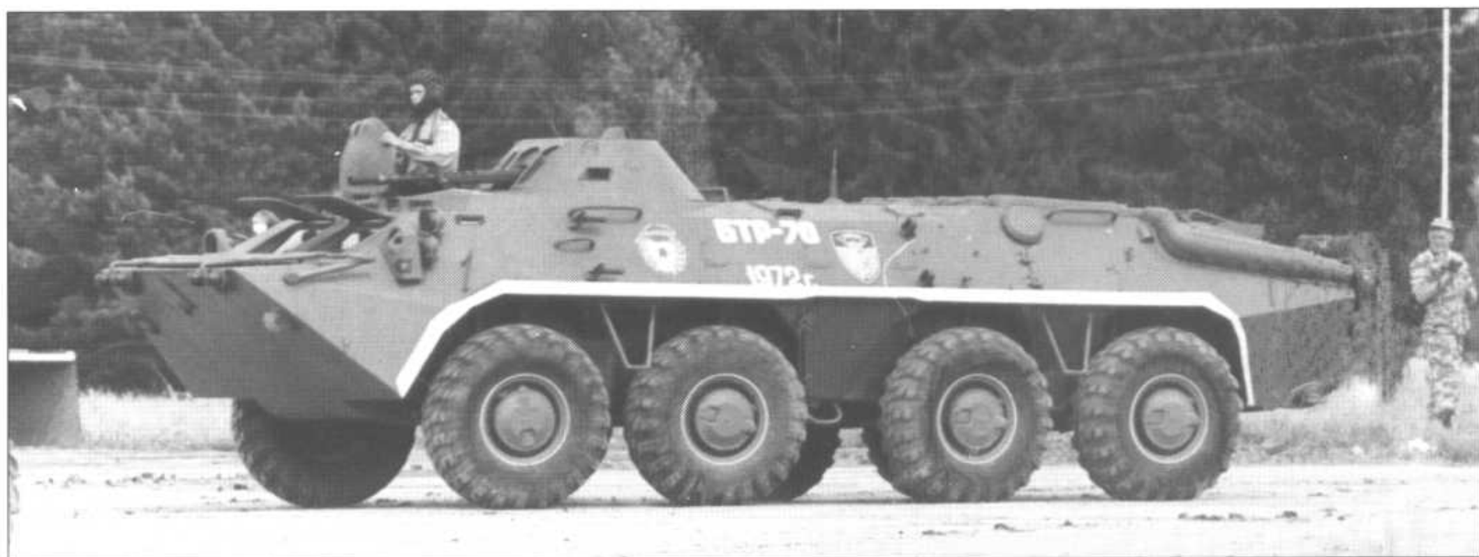
БТР-70 на празднике «День полка» в Кубинке. Машина позднего выпуска, поэтому некоторые элементы на корпусе отличны от модели «Звезды»: поручни с закругленными углами, лючки для стрельбы из оружия десанта в крыше средней части корпуса, резиновые буферы в лобовой части, небольшой воздухозаборник в корневой части глушителя. На этом парадном БТРе отсутствует лопата, но крепления для нее сохранены. Фото А. Аксенова.
