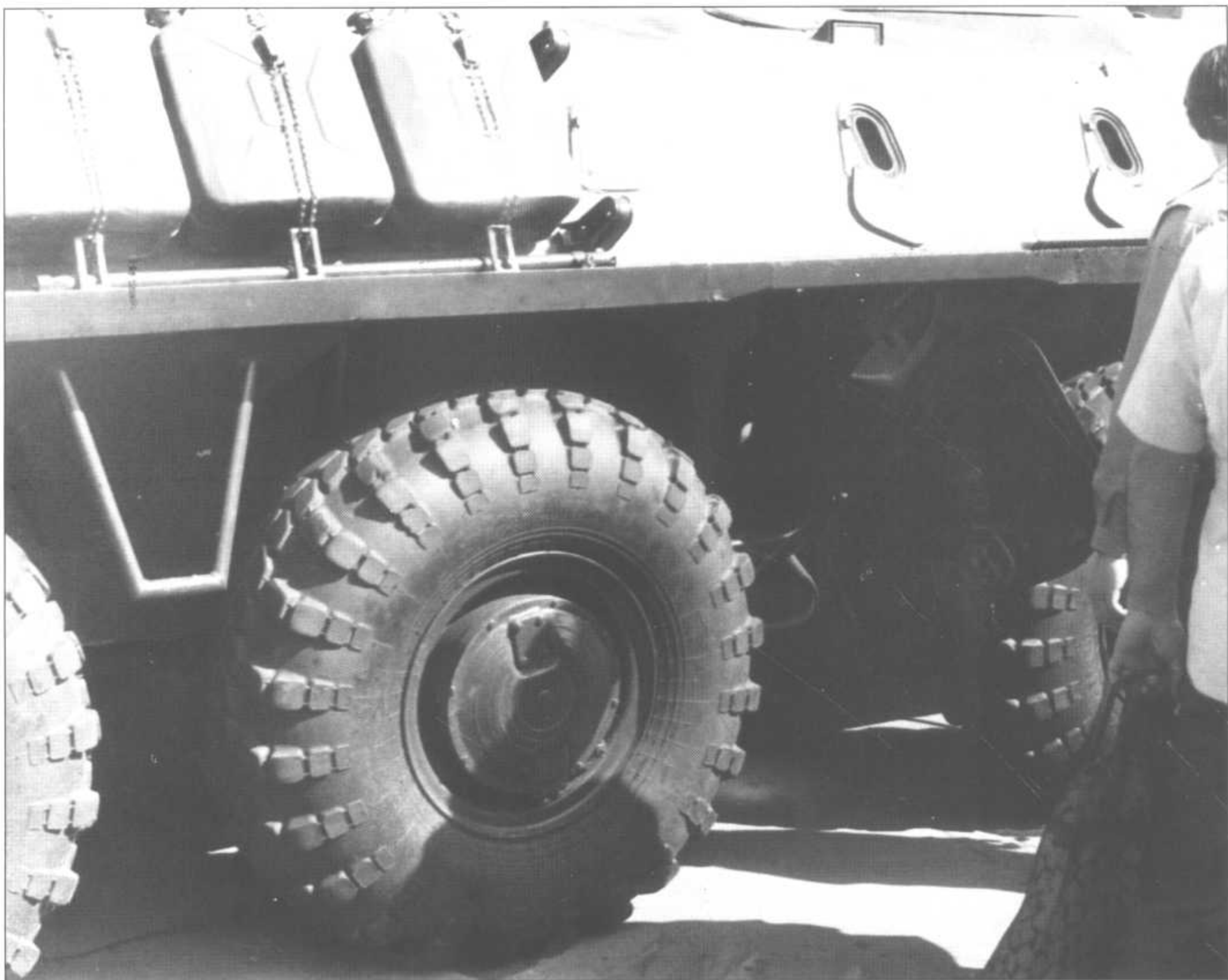
Топливные канистры закреплены на борту машины цепочками на замках. Форма канистр аналогична немецким времен Второй мировой войны.
