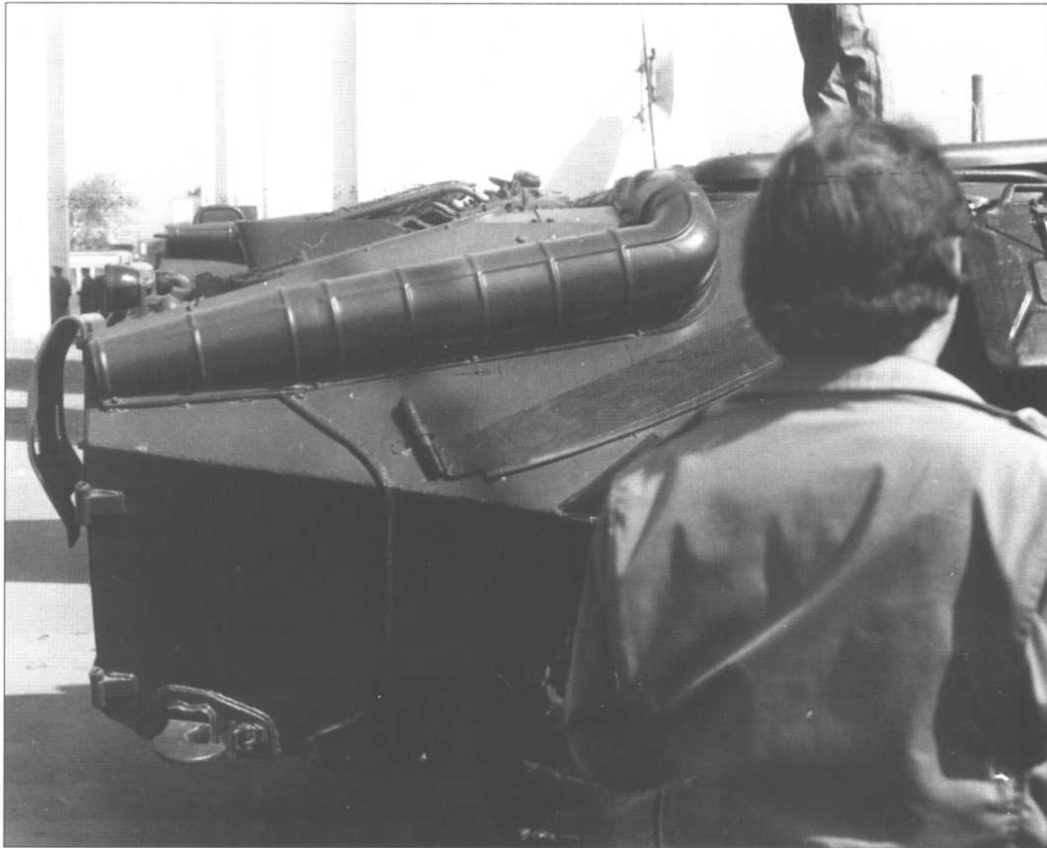
Глушитель правого двигателя, под ним - крепление пилы.
