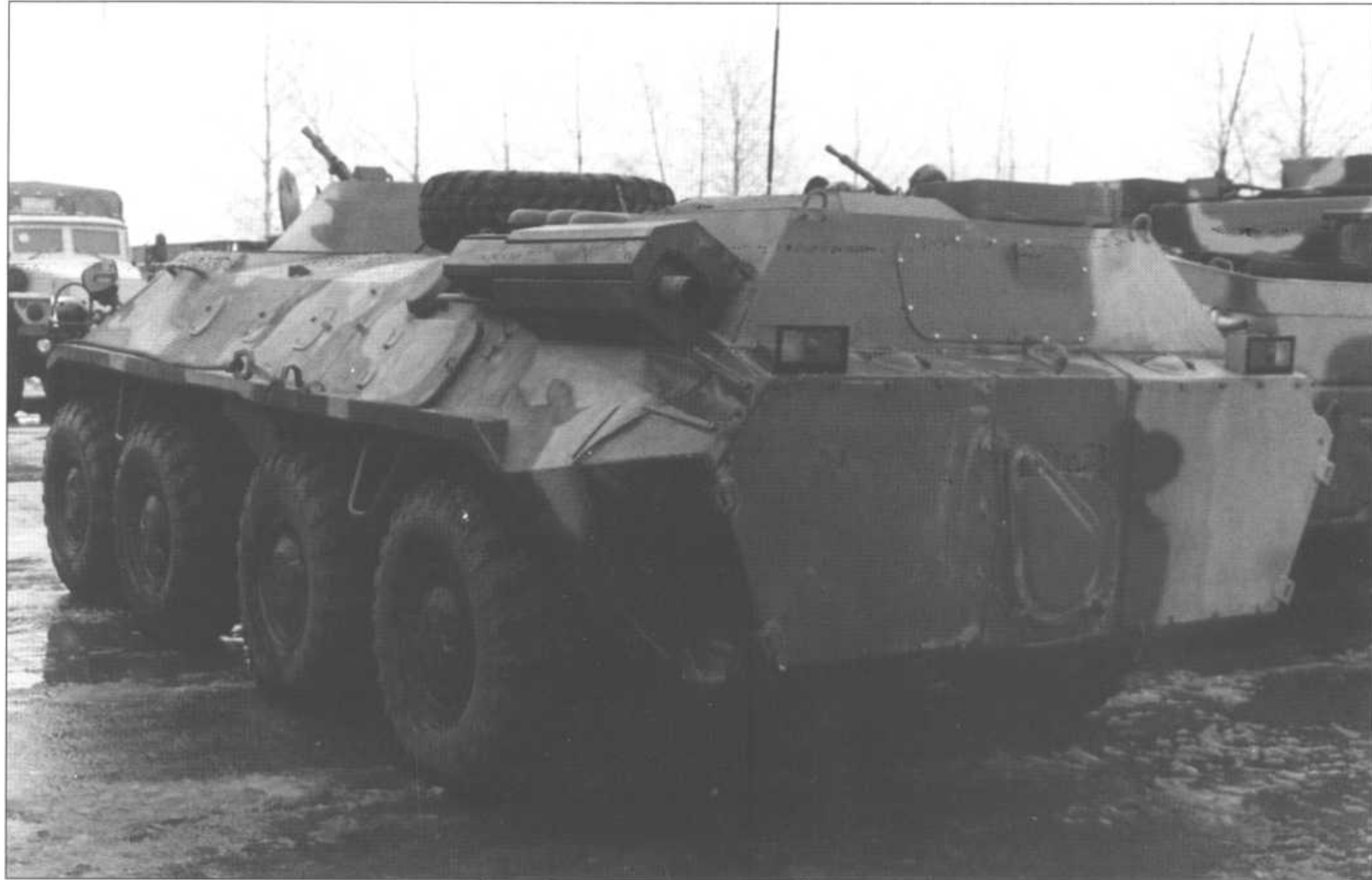
Глушитель выведен только на левую сторону корпуса.
