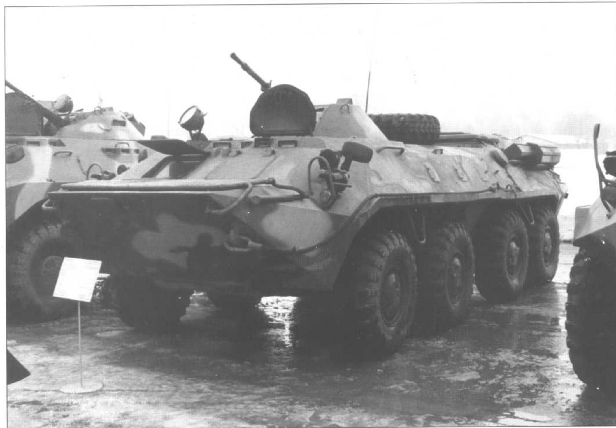
Модернизация предусматривает в т. ч. и замену башни на БПУ-1, унифицированную с БТР-80.
