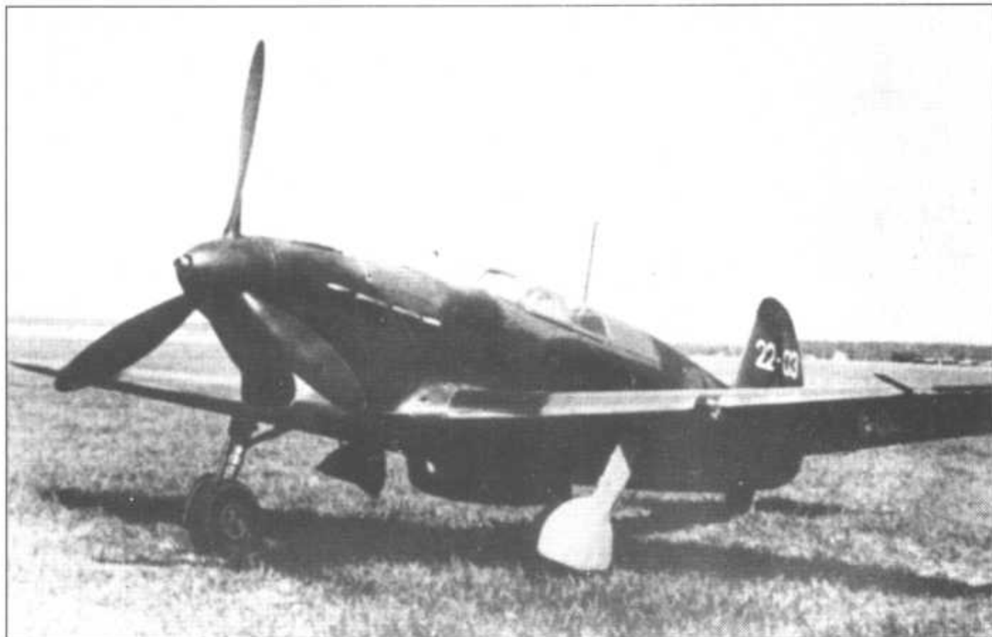
Як-7Б (22-03), собранный на заводе №153 в Новосибирске летом 1942 г. Серийный номер нанесен на киле самолета и обозначает третий самолет 22-й серии. В частях эти номера закрашивались. Камуфляж состоит из темно-зеленых и черных пятен, границы цветов - размытые. Кок винта - черный, без желтых концов.
