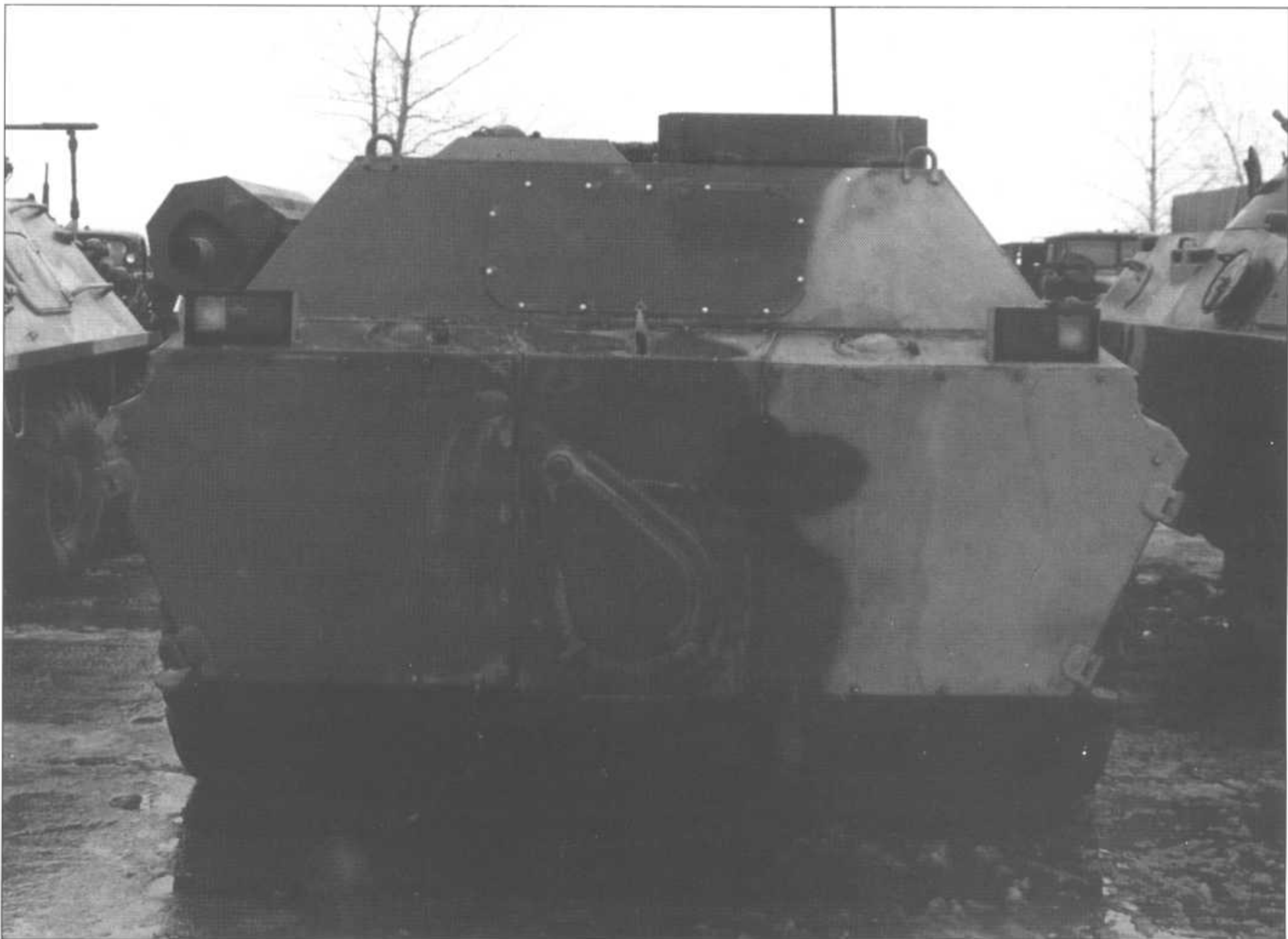
Нижняя часть кормы не изменилась, выросший «короб» скрывает ноаый двигатель.
