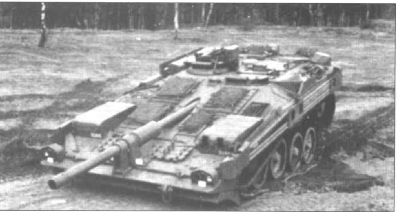
Угол склонения орудия регулируется при помощи подвески танка. Она же помогает машине преодолевать различные препятствия при движении по пересеченной местности.
