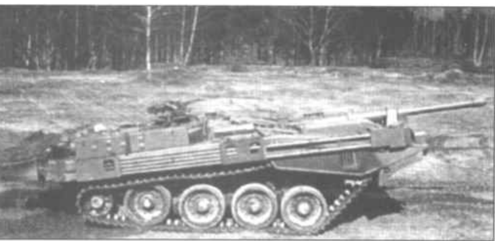
Угол склонения орудия регулируется при помощи подвески танка. Она же помогает машине преодолевать различные препятствия при движении по пересеченной местности.
