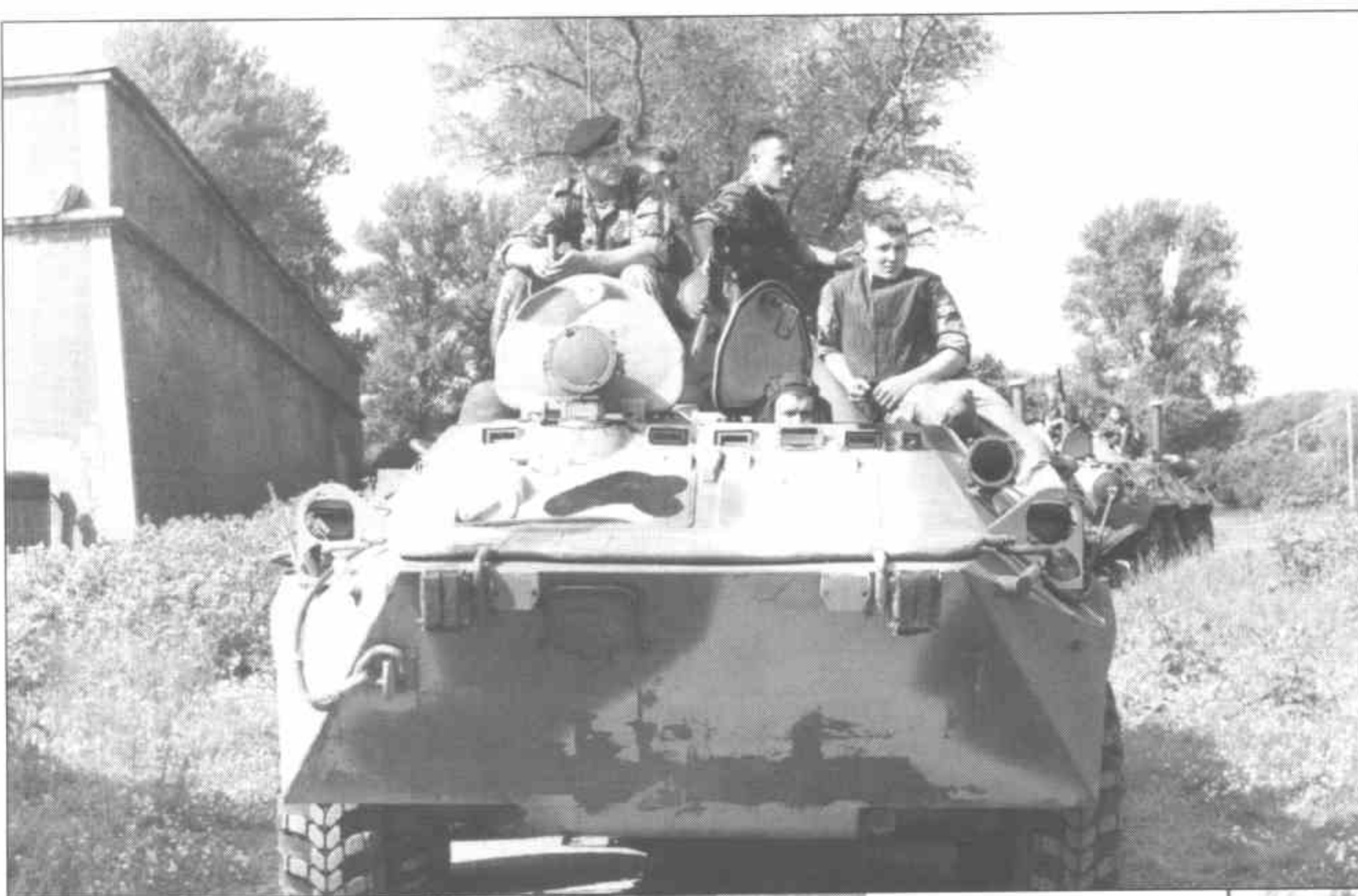
БТР-80 морской пехоты Балтийского флота. Машина позднего выпуска (прямоугольные демпферы в лобовой части корпуса). (Все фото А. Аксенова)
