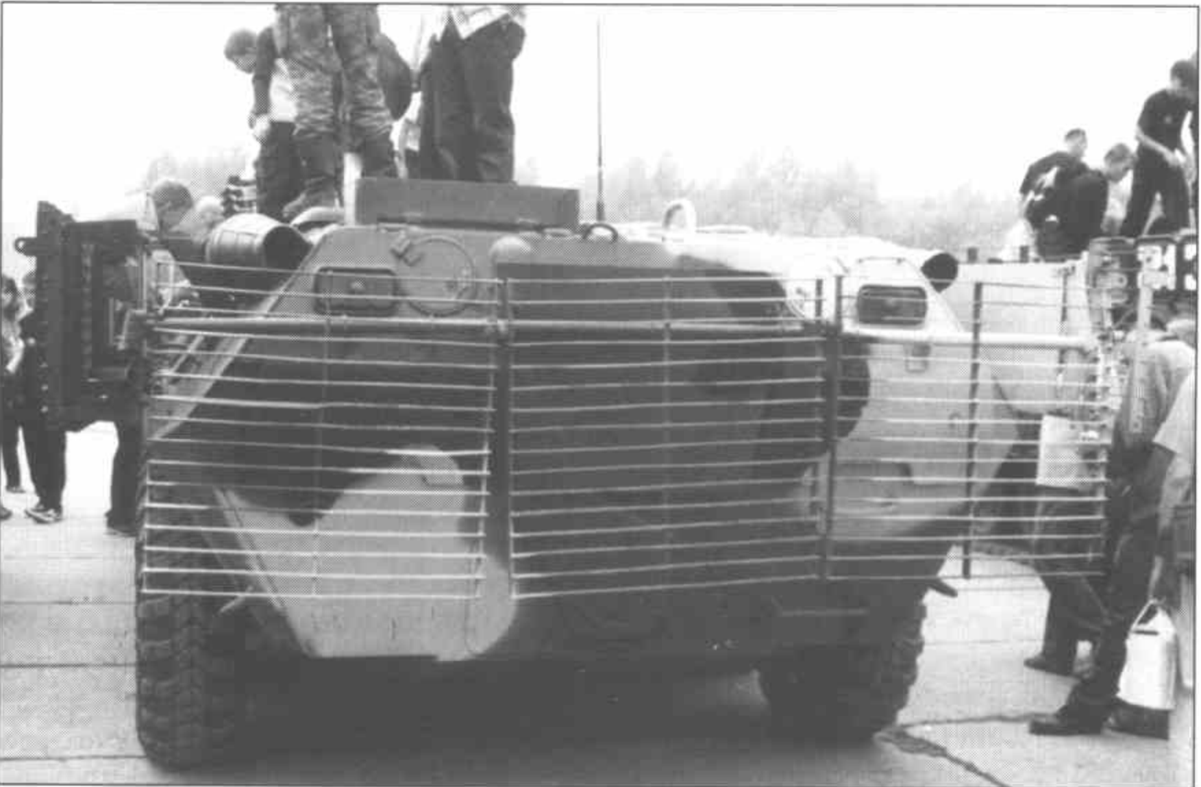
Кормовые противокумулятивные решетки БТР-80 закреплены на оси с некоторой подвижностью, чтобы не оторвались при зацеплении за растительность. За центральной секцией расположен дополнительный бронелист.
