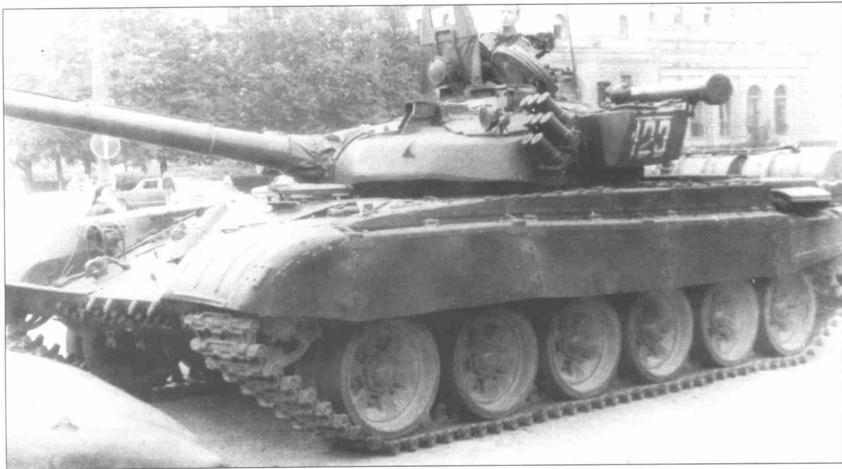
Т-72Б Таманской дивизии в Москве во время путча 1991 г. Танк №123 - зеленого цвета без камуфляжа. На бочках с топливом видна система его подачи в танк, на модели она отсутствует. Катки танка - позднего типа с шестью «окнами», на модели - раннего типа с восемью «окнами». (М. Барятинский).
