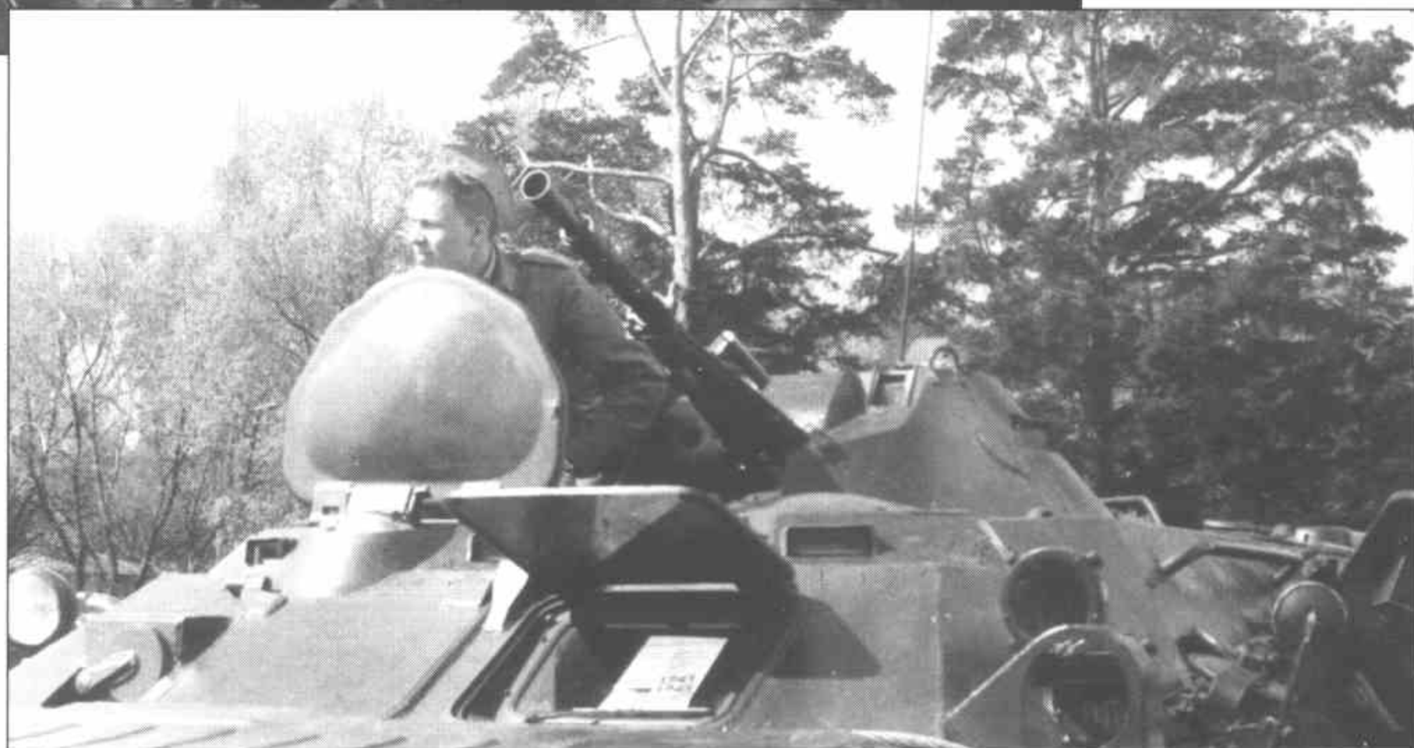
Выхлопная труба закрыта кожухом с вентиляционными щелями (на модели отсутствуют) и прикрыта спереди бронешитком.
