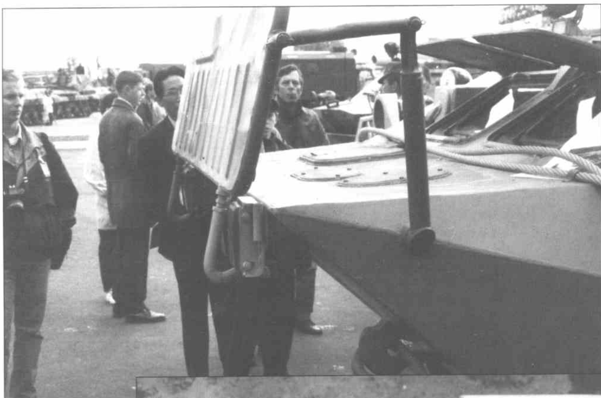
Механизм раскрытия волноотбойного щитка (под ним на верхнем листе корпуса люки обслуживания лебедки).
