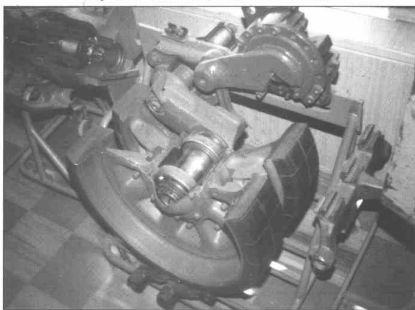
Опорный каток Т-72 (Т-90) позднего типа.
