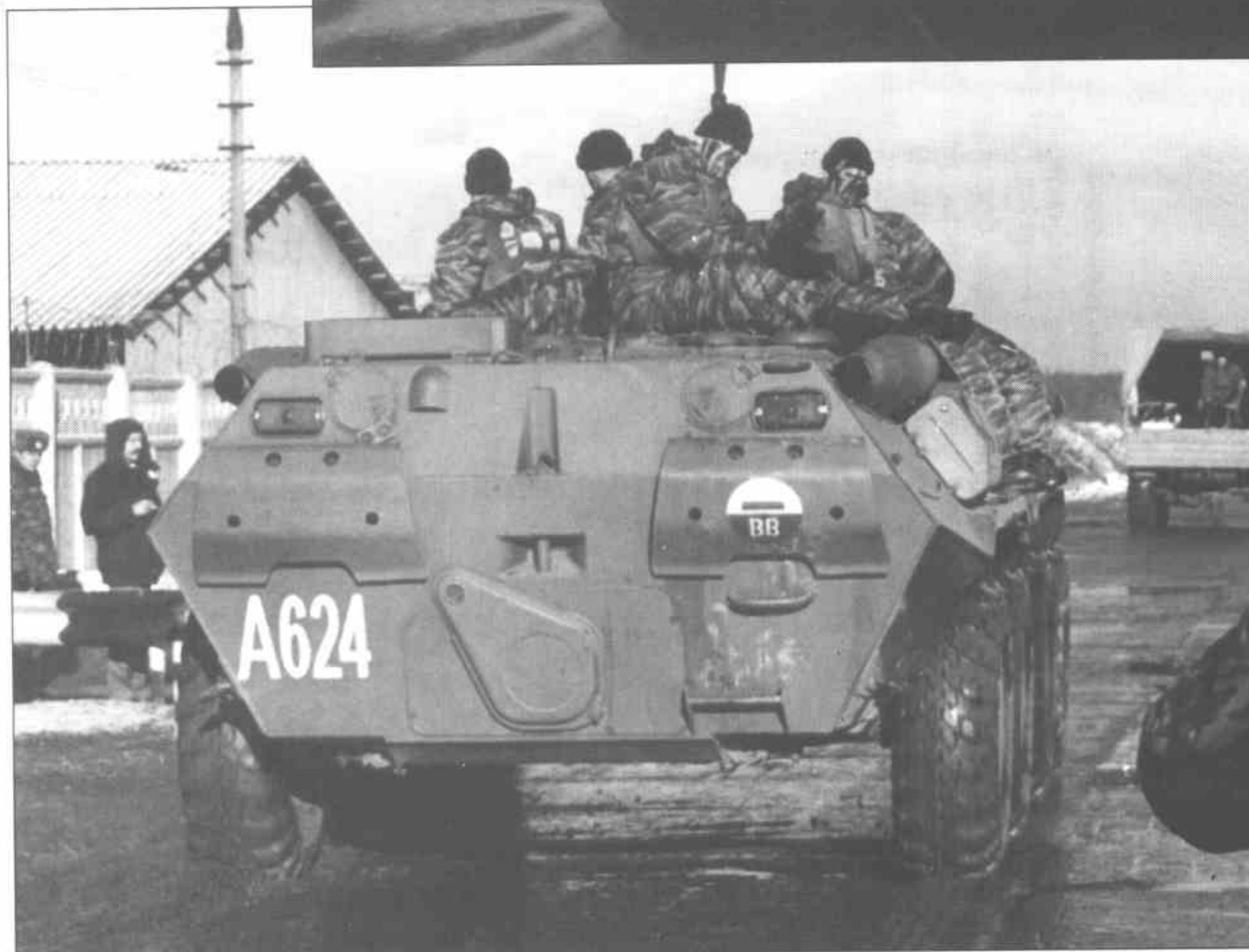
Кормовая часть БТР-80 позднего типа. Люки заправочных горловин откидываются под углом, отверстия в бамперах - круглые. Кормовые фары обеих машин напоминают аналогичные устройства от «Жигулей» первой модели.
