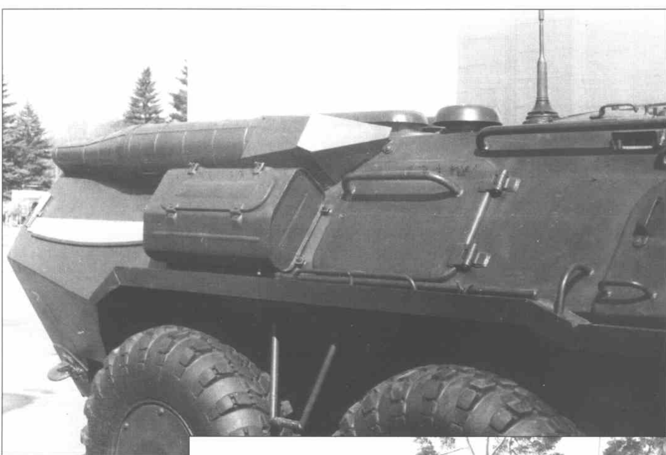
Кормовая правая часть корпуса БТР-80. Ступицы колес закрыты бронекрышками.
