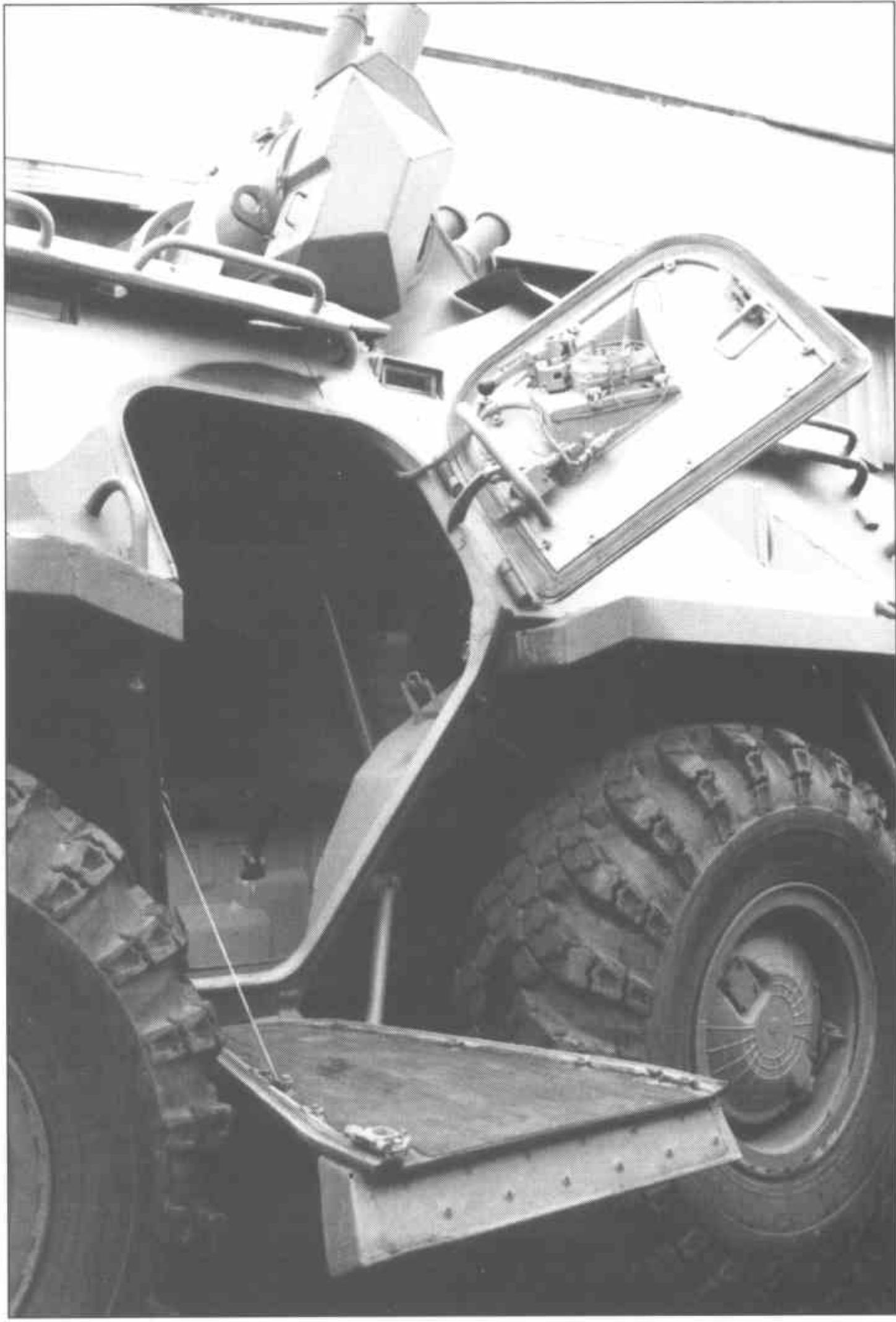
В верхней половине люка сделана бойница для ведения огня оружием десанта. На колесных дисках отсутствует защита. Внутренняя поверхность люка - белого цвета.
