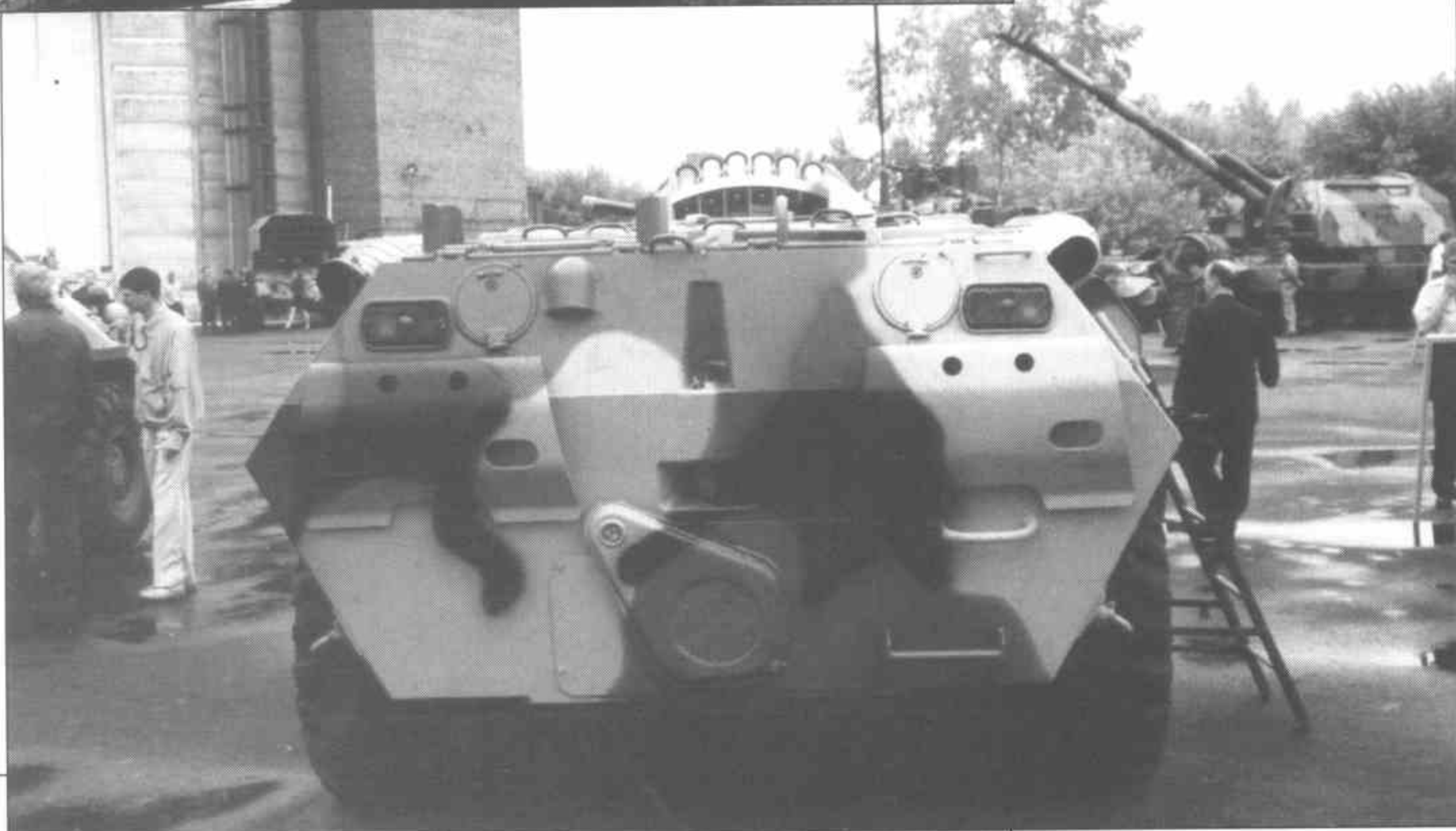
Кормовая часть БТР-80 раннего типа. Люки заправочных горловин откидываются в вертикальной плоскости. Отверстия в бамперах - овальные. Именно такую версию машины и сделала «Звезда».
