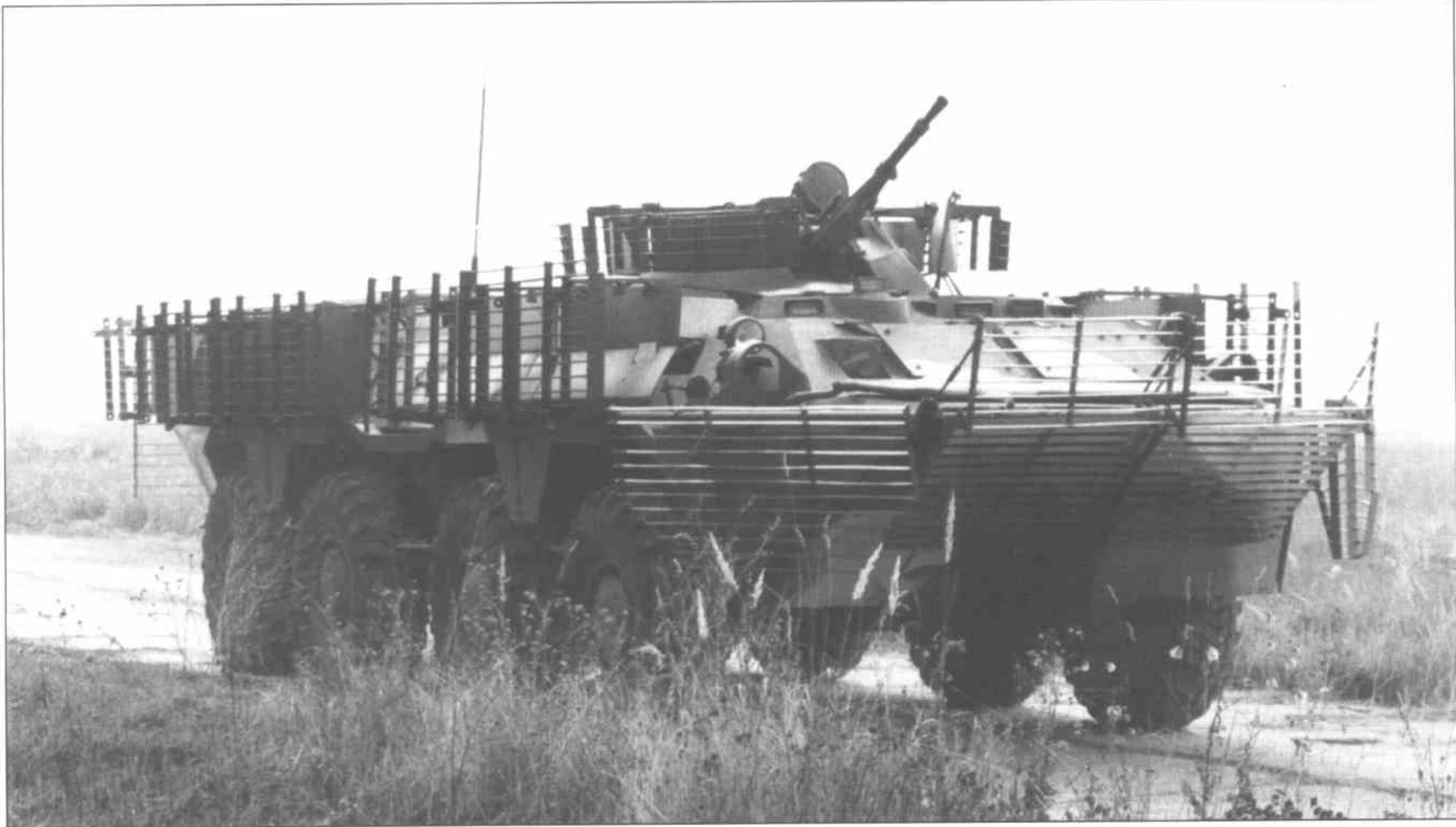
Экспериментальный БТР-80 доработан с учетом опыта локальных войн. Оснащен дополнительными бронелистами и противокумулятивными решетками.
