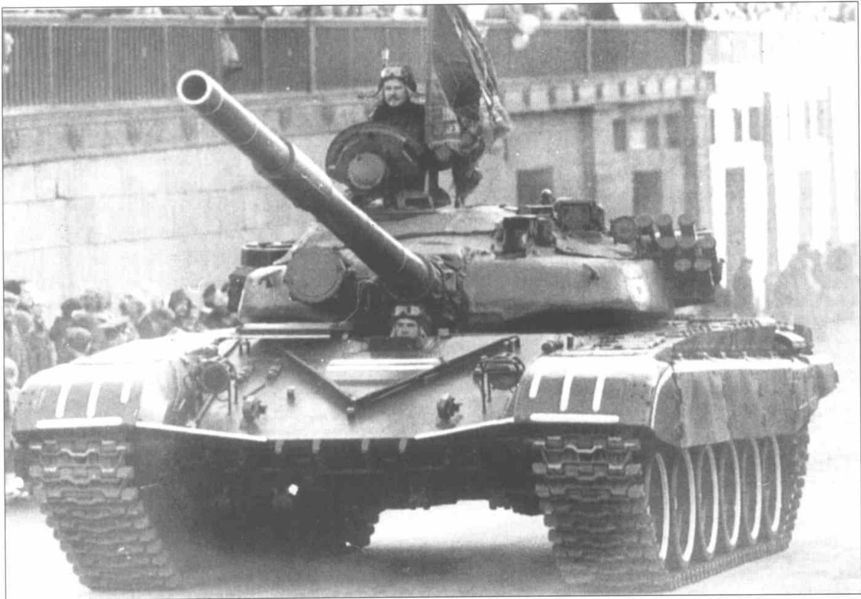
Т-72Б на одном из парадов в Москве. Хорошо видны антирадиационные маты на крыше башни. Перед люком механика-водителя белой краской обозначены приваренные металлические планки, на модели они отсутствуют.
