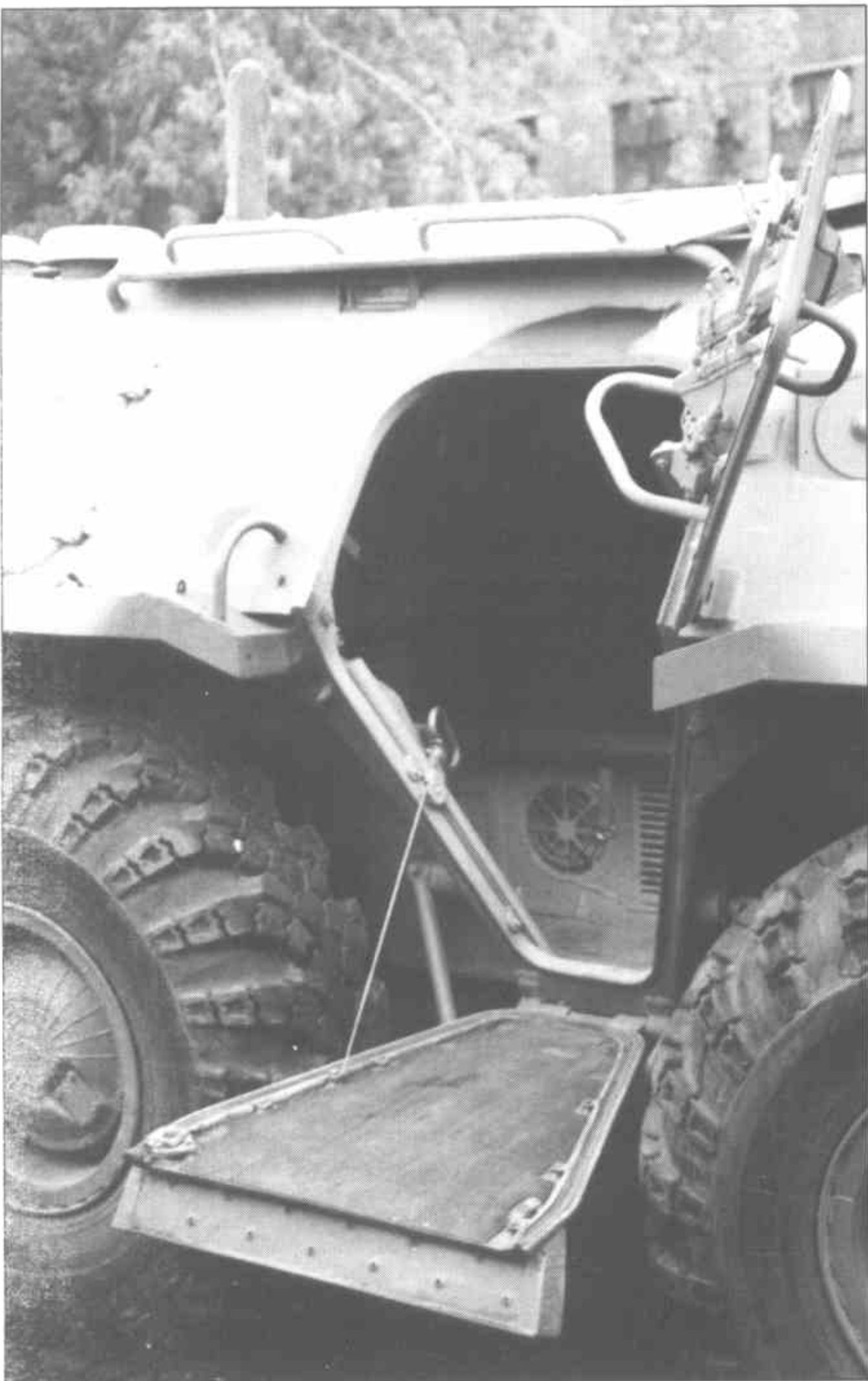
Открытый люк БТР-80А. Нижняя половина используется как мостик для высадки на ходу.
