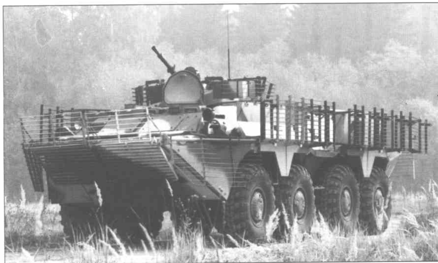
Нижние части решетчатых экранов, в боевом положении прикрывающих колеса, откинуты вверх.
