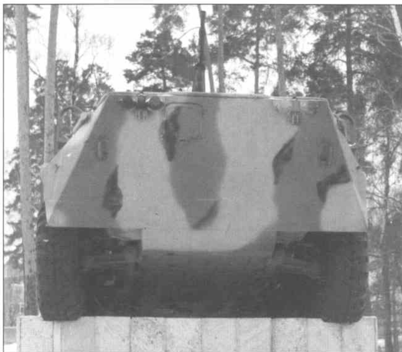
Квадратный люк на переднем листе служит для выдачи троса лебедки. (Ю. Спасибухов) Подвеска переднего колеса. (Ю. Спасибухов)
