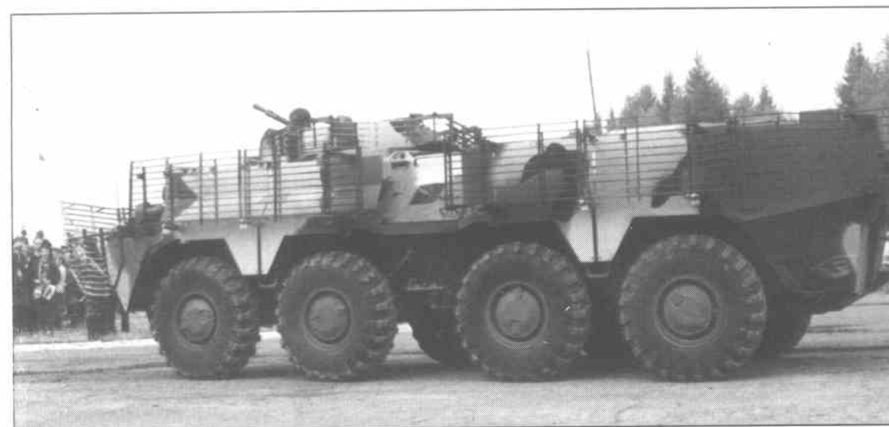
Между решетками и бортом машины установлены дополнительные бронелисты.
