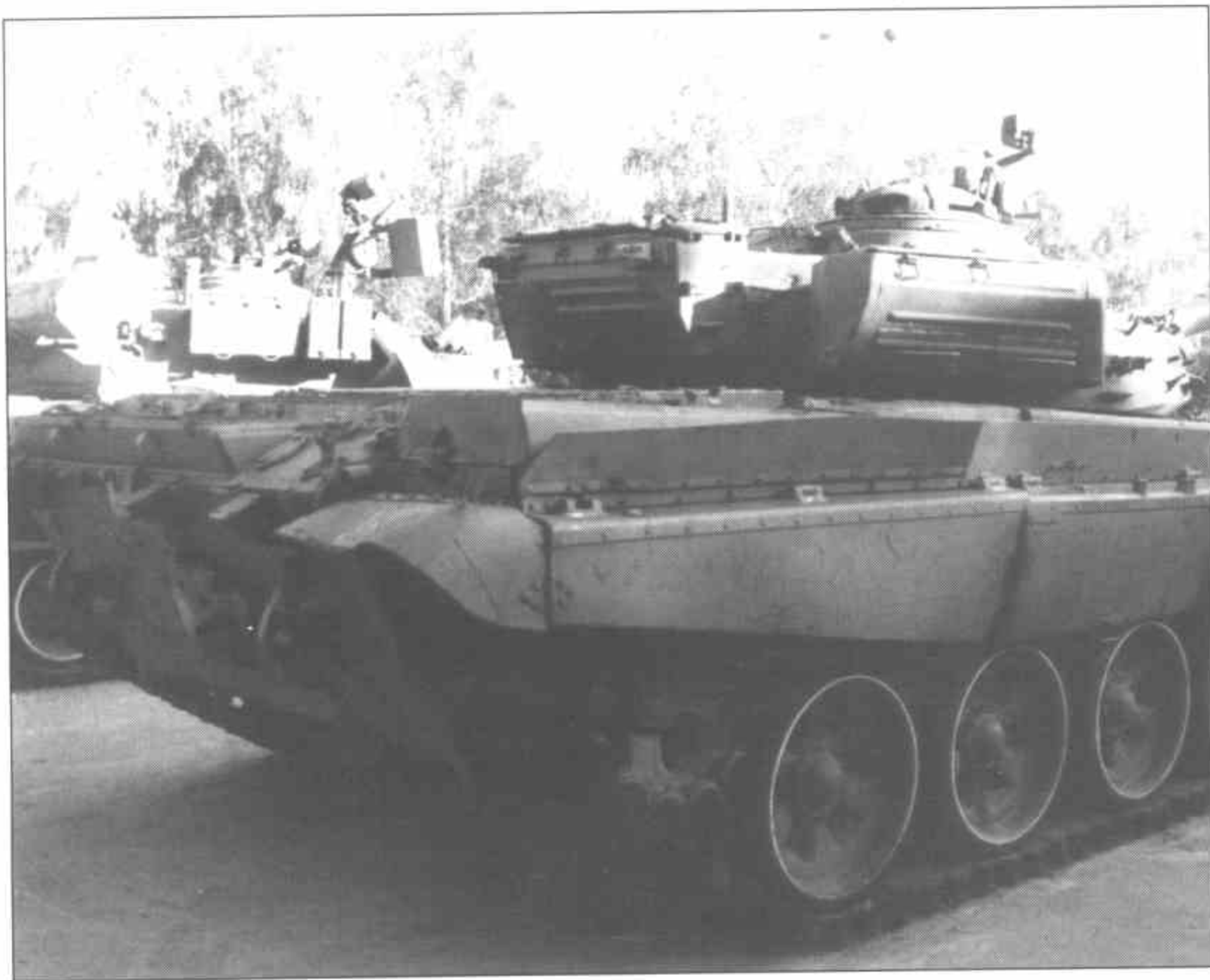
Задняя часть бортового резино-тканевого экрана T-72.
