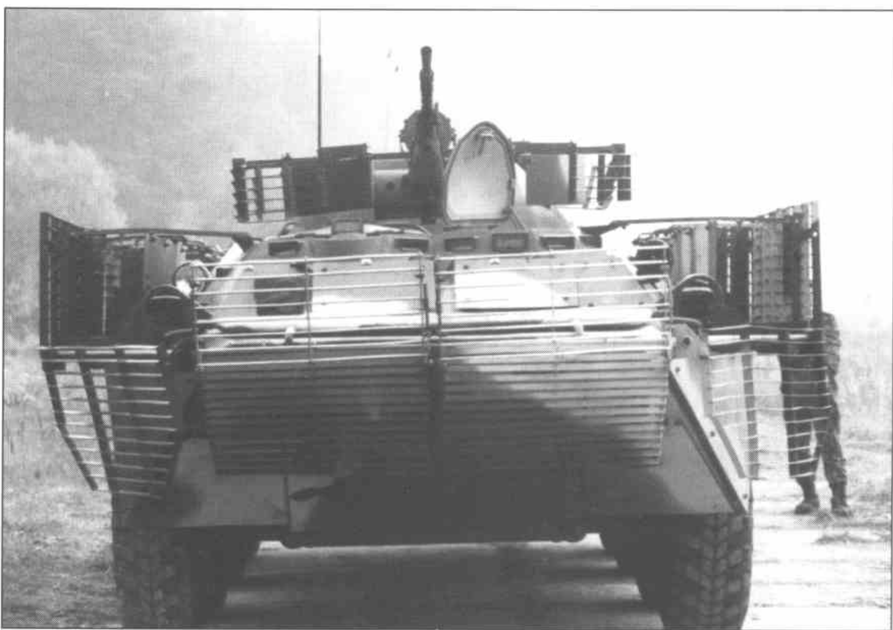
Дополнительные бронелисты установлены и на передней части корпуса.
