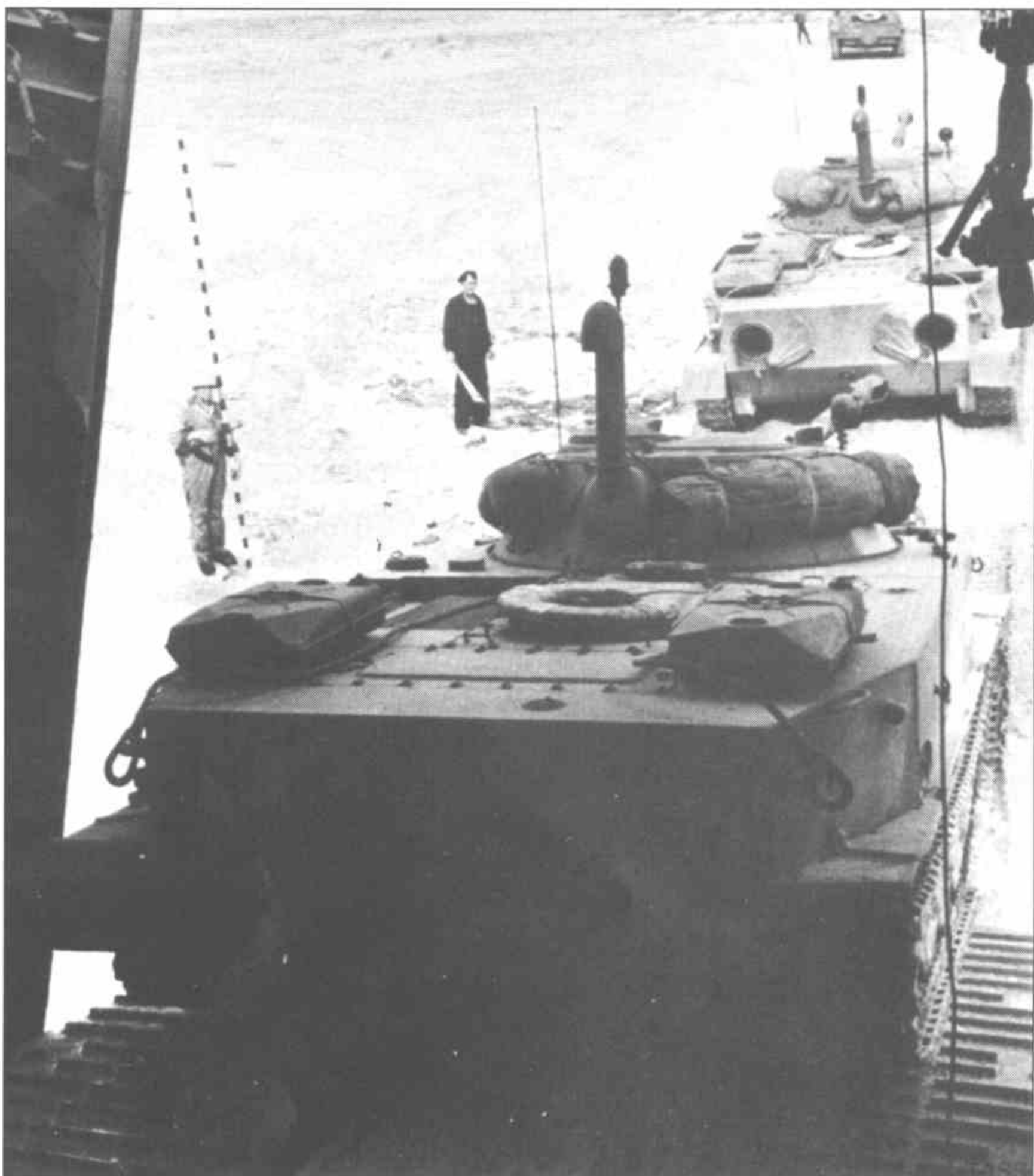
ПТ-76 морской пехоты выходит на берег с аппарели десантного корабля. Волноотражательный щиток откинут. Передняя секция надгусеничной полки демонтирована.
