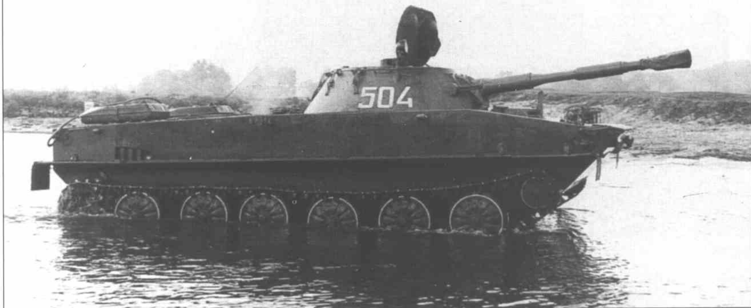
ПТ-76 одной из разведывательных частей Советской Армии. Танк окрашен в зеленый цвет, дульный тормоз укрыт брезентовым чехлом. Обратите внимание как блестят ободы катков в местах сопряжения с резиновым бандажем.
