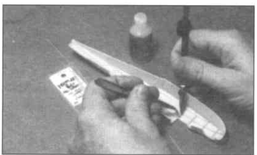
Монтаж полученного силового набора внутри половинки фюзеляжа.
