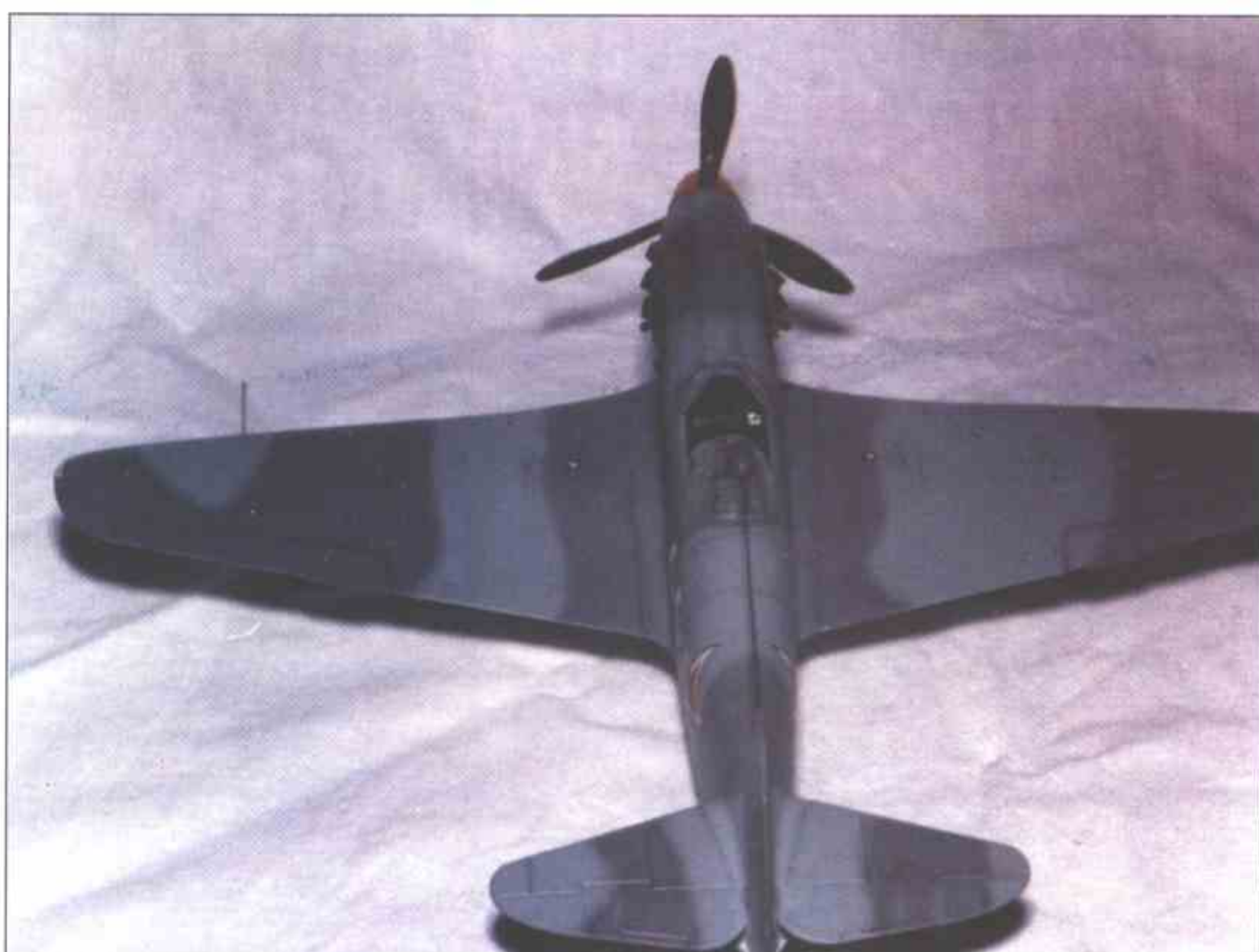
Вид сзади. На винте виден крест калибровки прицела.
