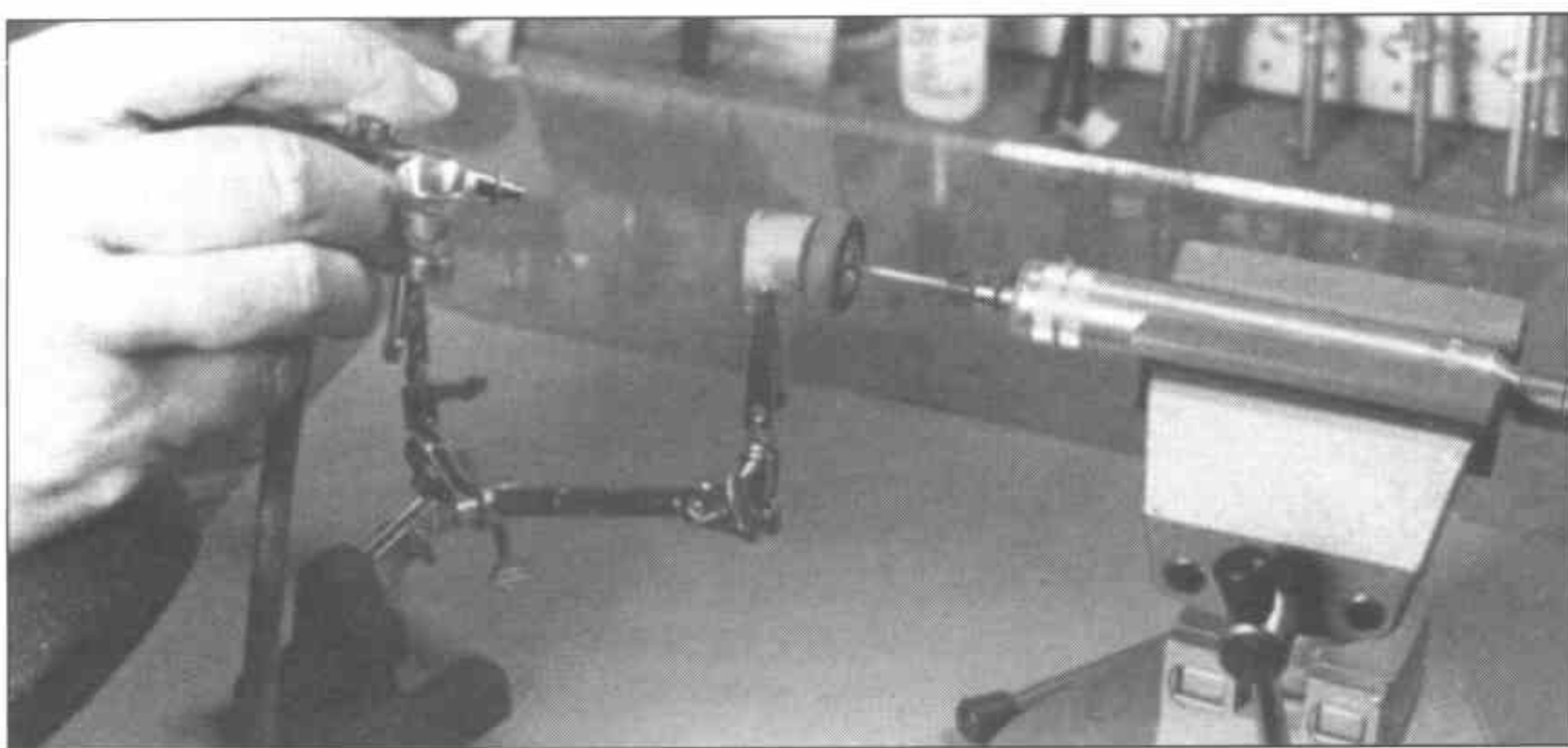
С помощью такого хитрого приспособления можно добиться большого реализма при нанесении имитации грязи на колеса основных опор шасси.
