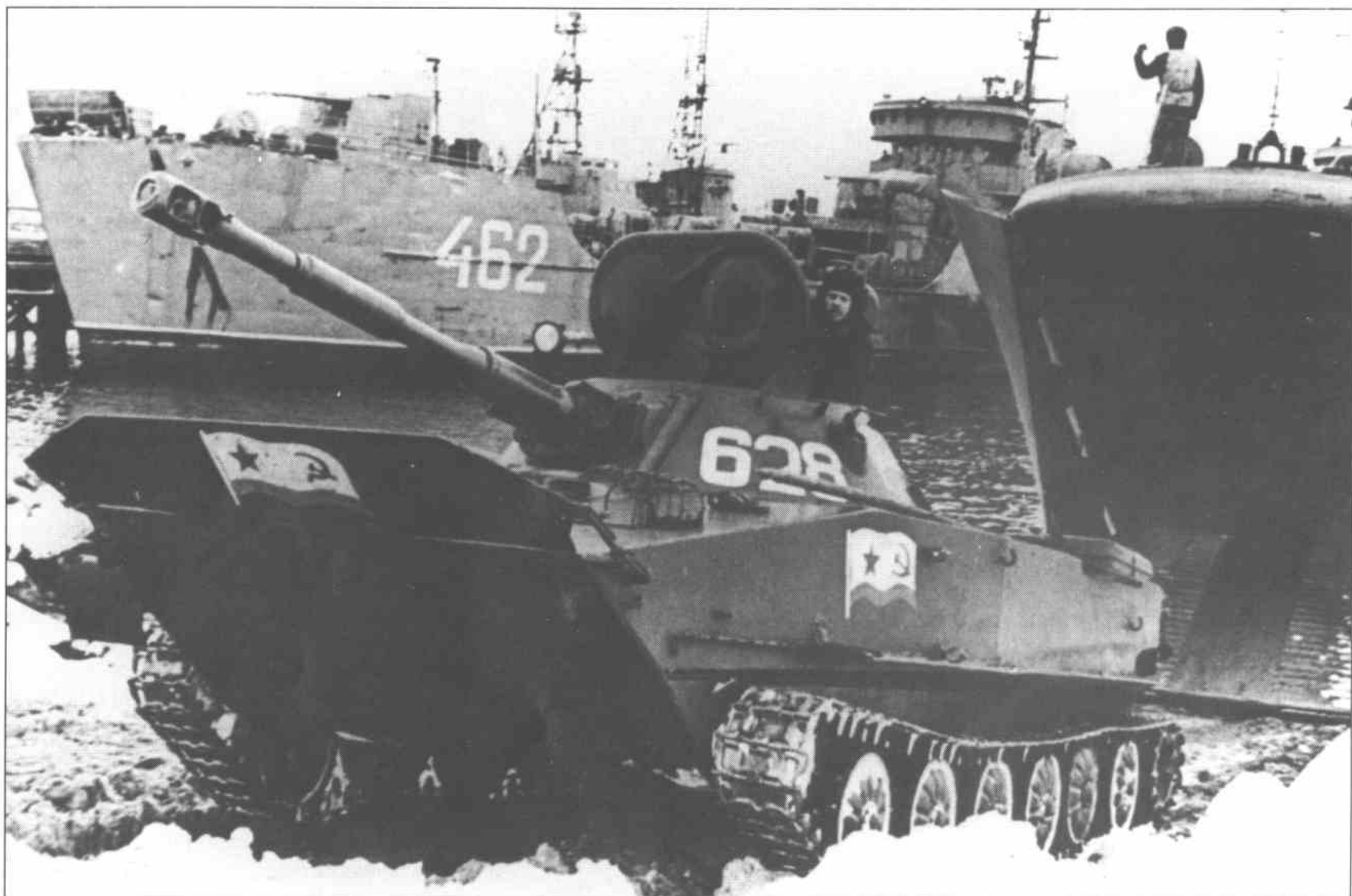
ПТ-76 морской пехоты выходит на берег с аппарели десантного корабля. Волноотражательный щиток откинут. Передняя секция надгусеничной полки демонтирована.
