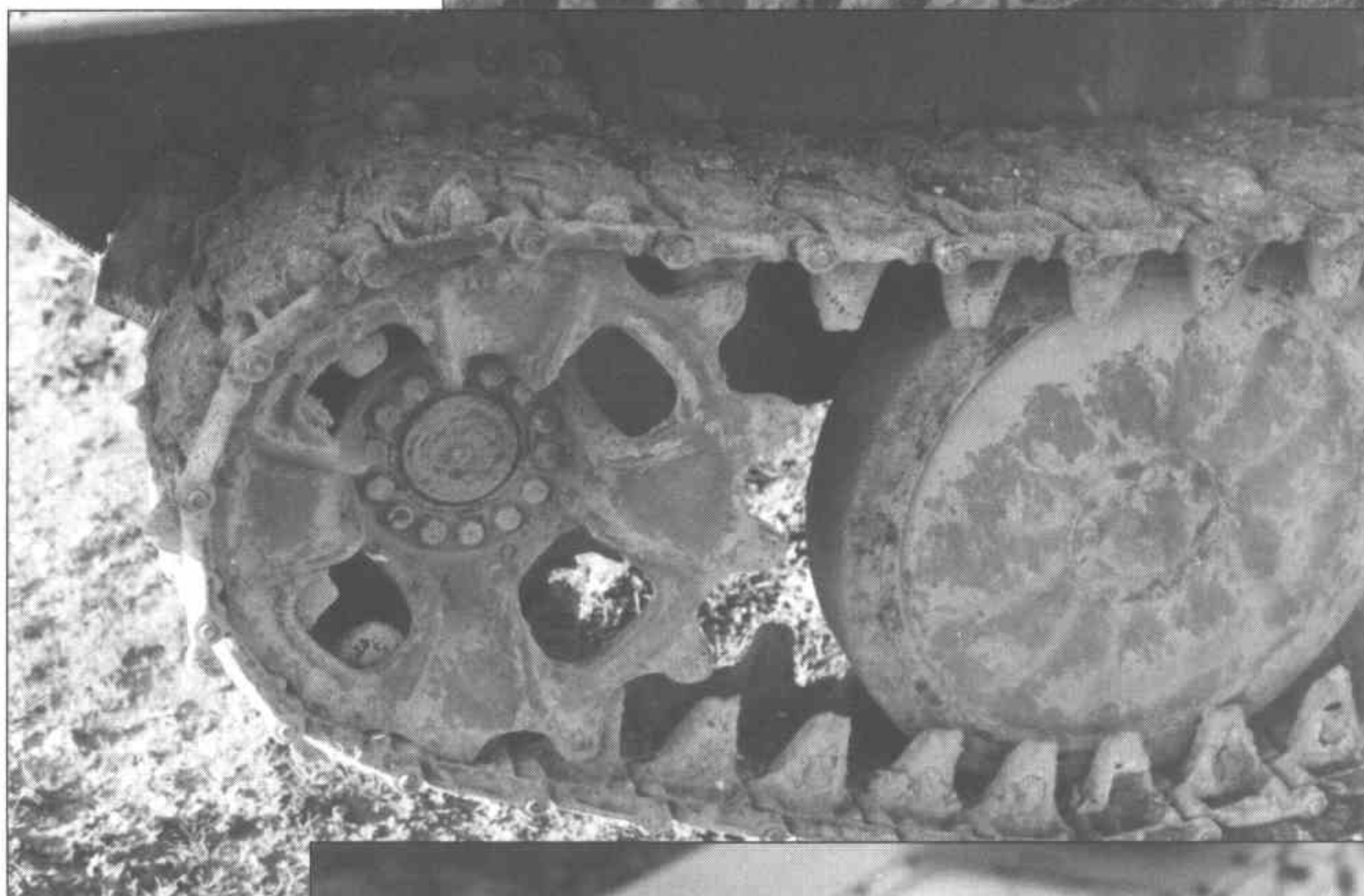
Ведущее колесо. На модели ходовая часть выполнена довольно точно. (А. Аксенов)
