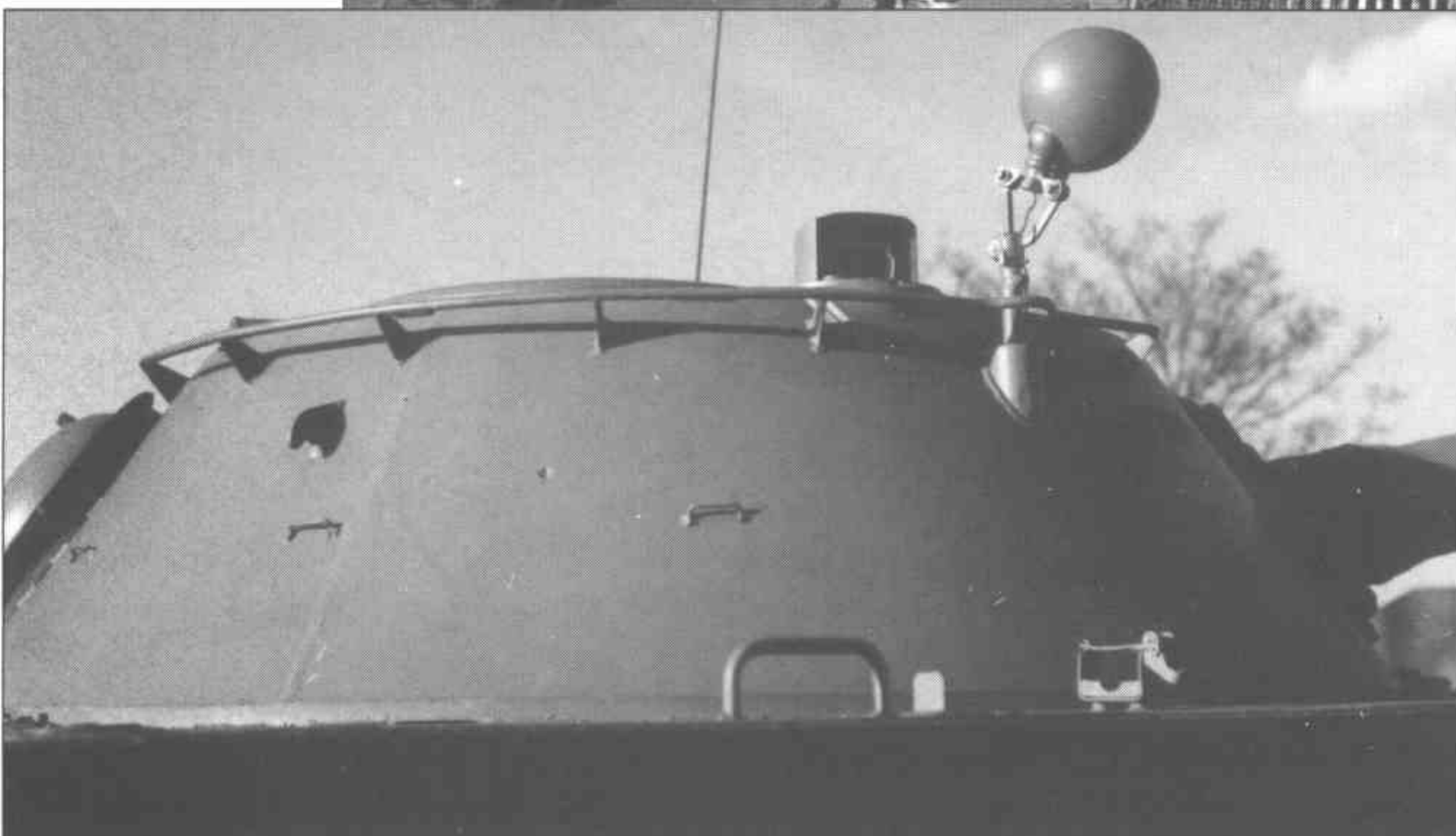
Правая сторона башни танка. Хорошо виден отсутствующий на модели поручень, небольшие скобы для крепления брезентовых ремней и рым для демонтажа башни. Фара на модели выполнена довольно точно. (Дж. Киннэр)
