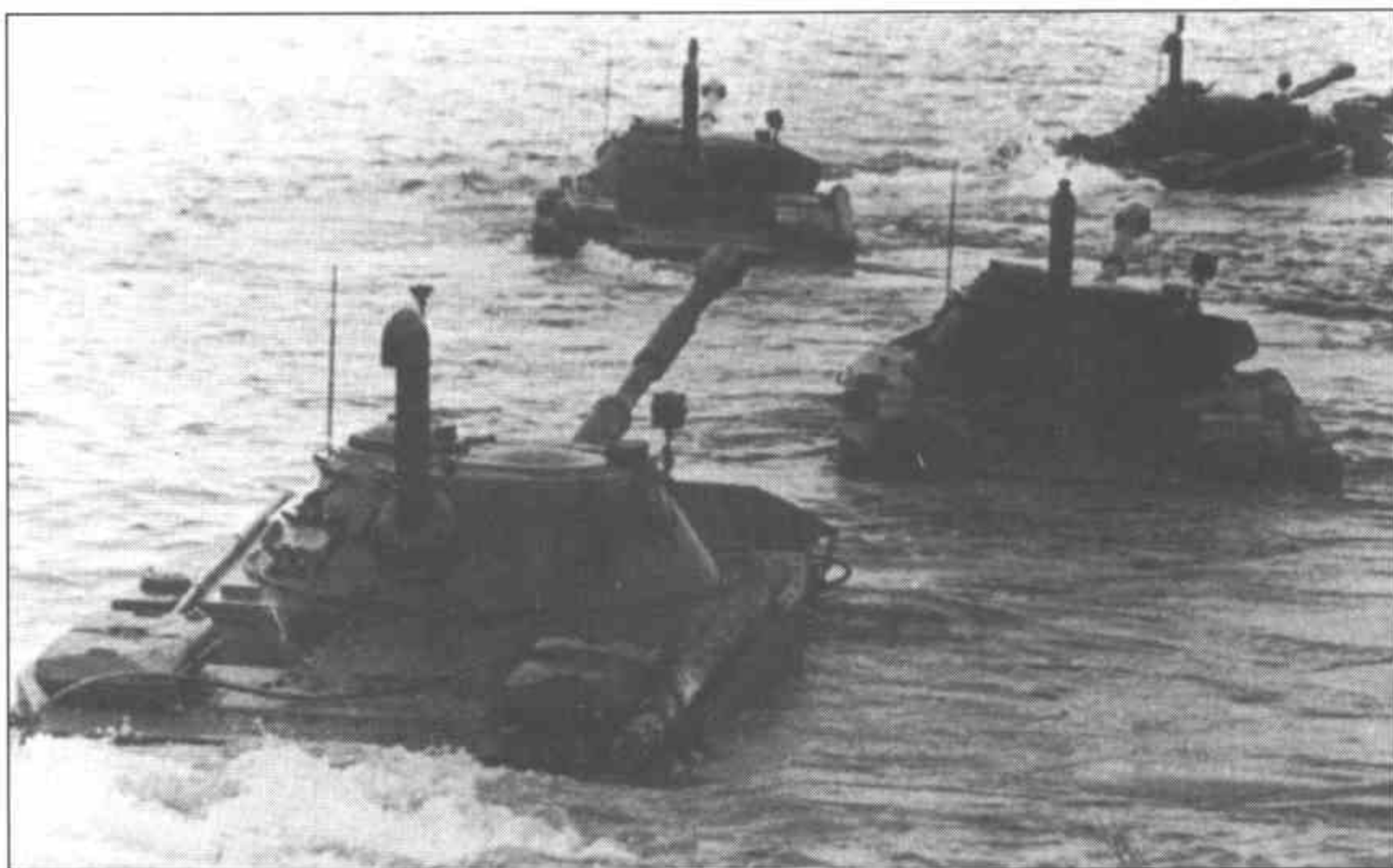
ПТ-76 одной из разведывательных частей Советской Армии. Танк окрашен в зеленый цвет, дульный тормоз укрыт брезентовым чехлом. Обратите внимание как блестят ободы катков в местах сопряжения с резиновым бандажем.
