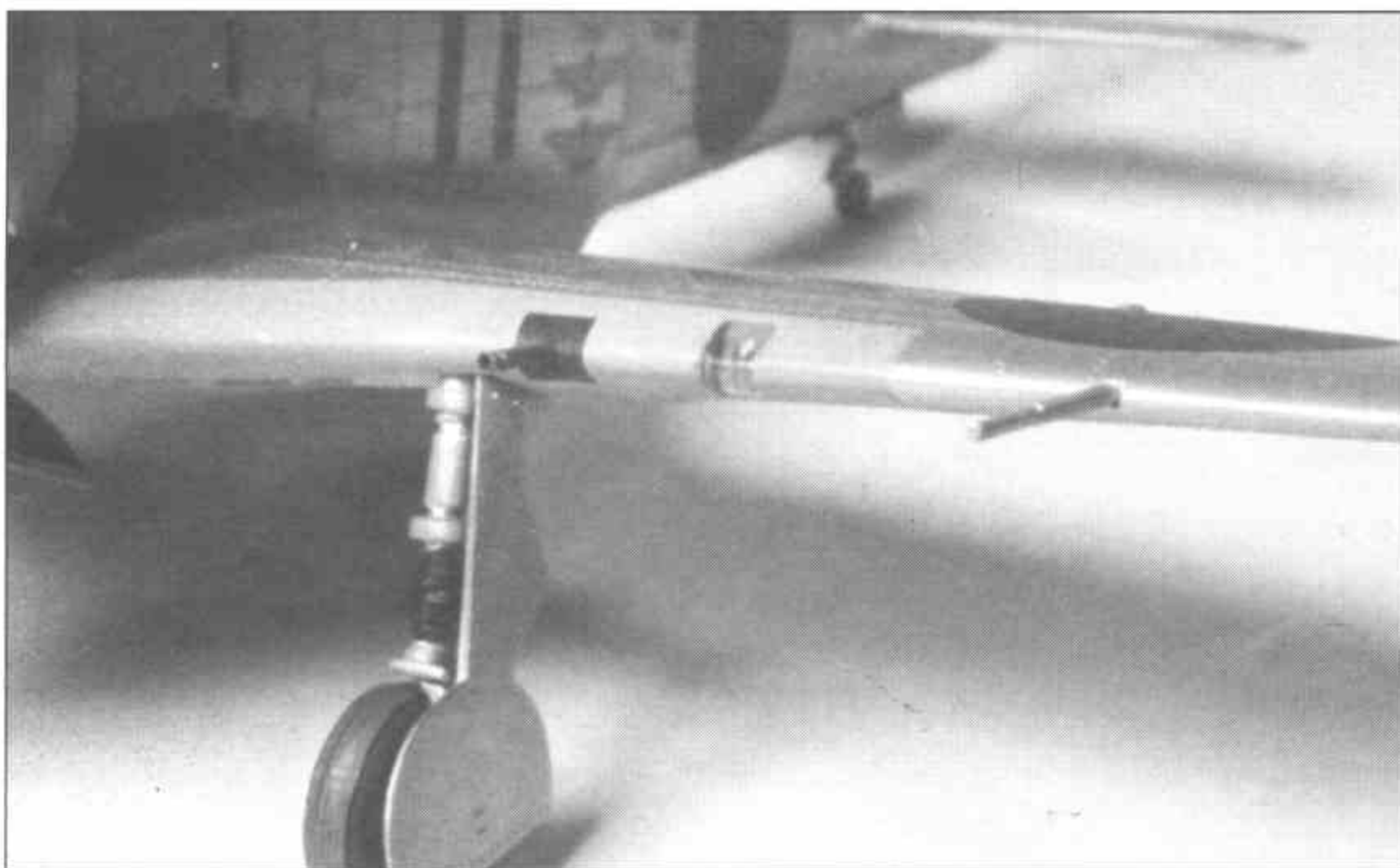
Посадочная фара «вписана» в носок крыла. Модель истребителя Ki-44 «Тодзё».
