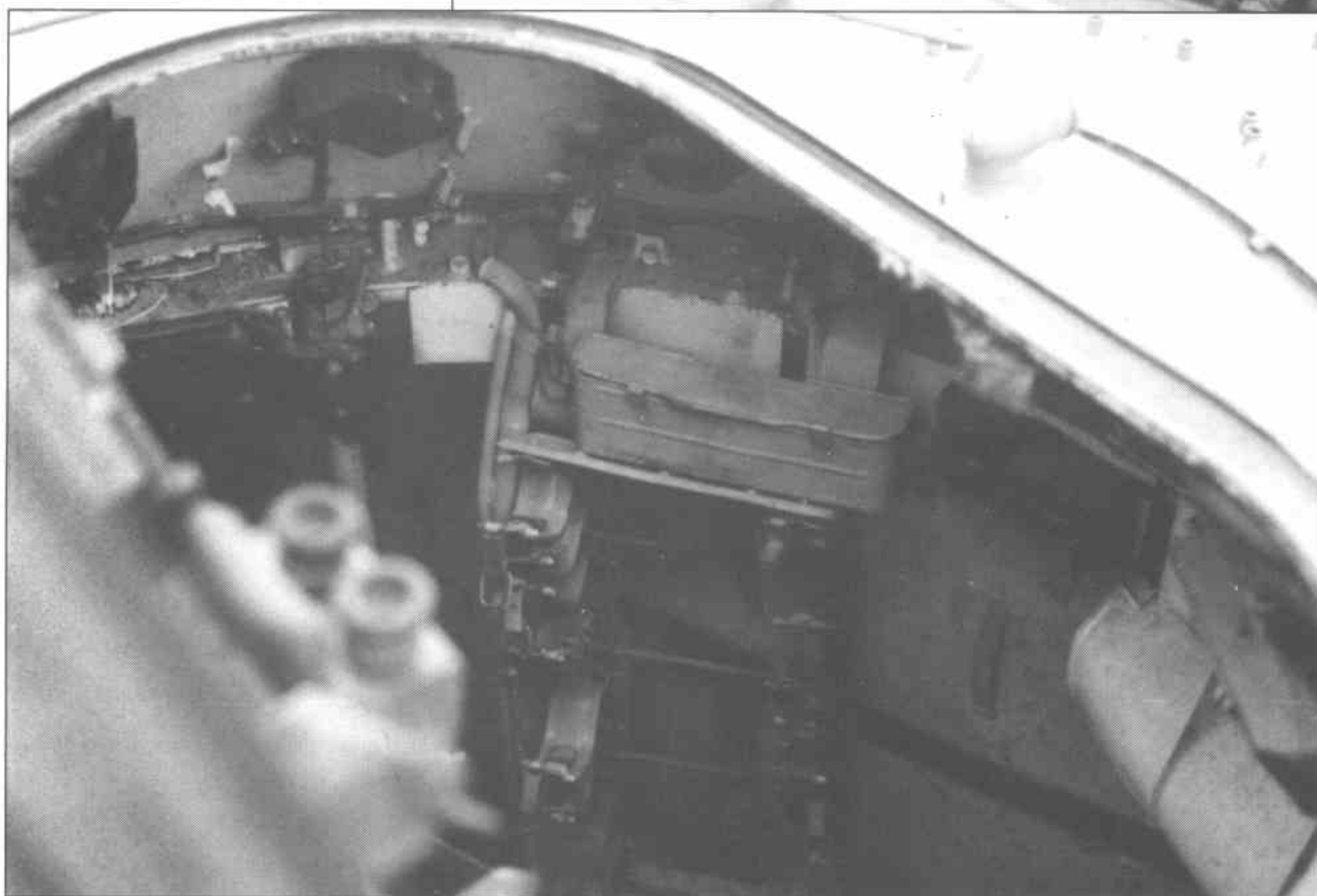
Снарядная укладка, укрепленная на башенном погоне (справа по ходу). Ящик в центре и укладка серо-голубого цвета. (Дж. Киннэр)
