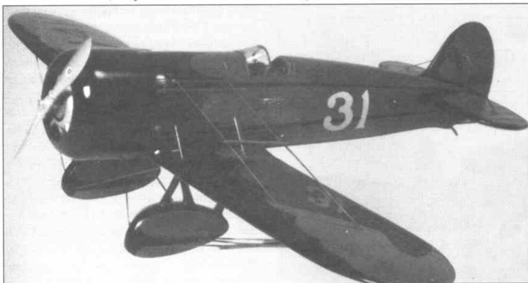
Блестящую поверхность модели спортивного самолета в масштабе 1:48 придала полировка окрашенных поверхностей зубной пастой.
