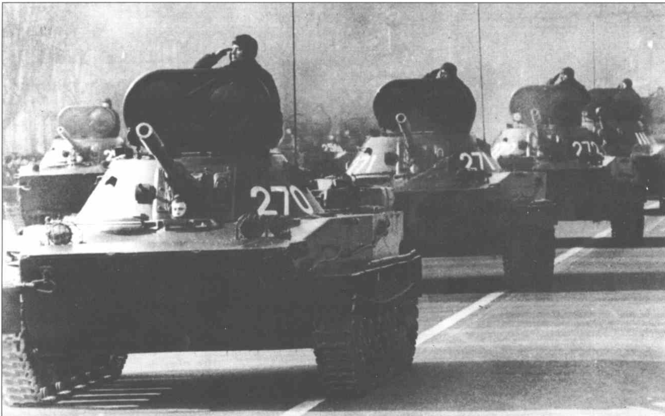
Танки ПТ-76 раннего типа на параде. Хорошо заметен дульный тормоз щелевого типа.
