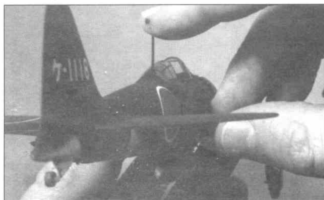
Мачта радиоантенны должна располагаться вертикально в плоскости симметрии фюзеляжа модели самолета.
