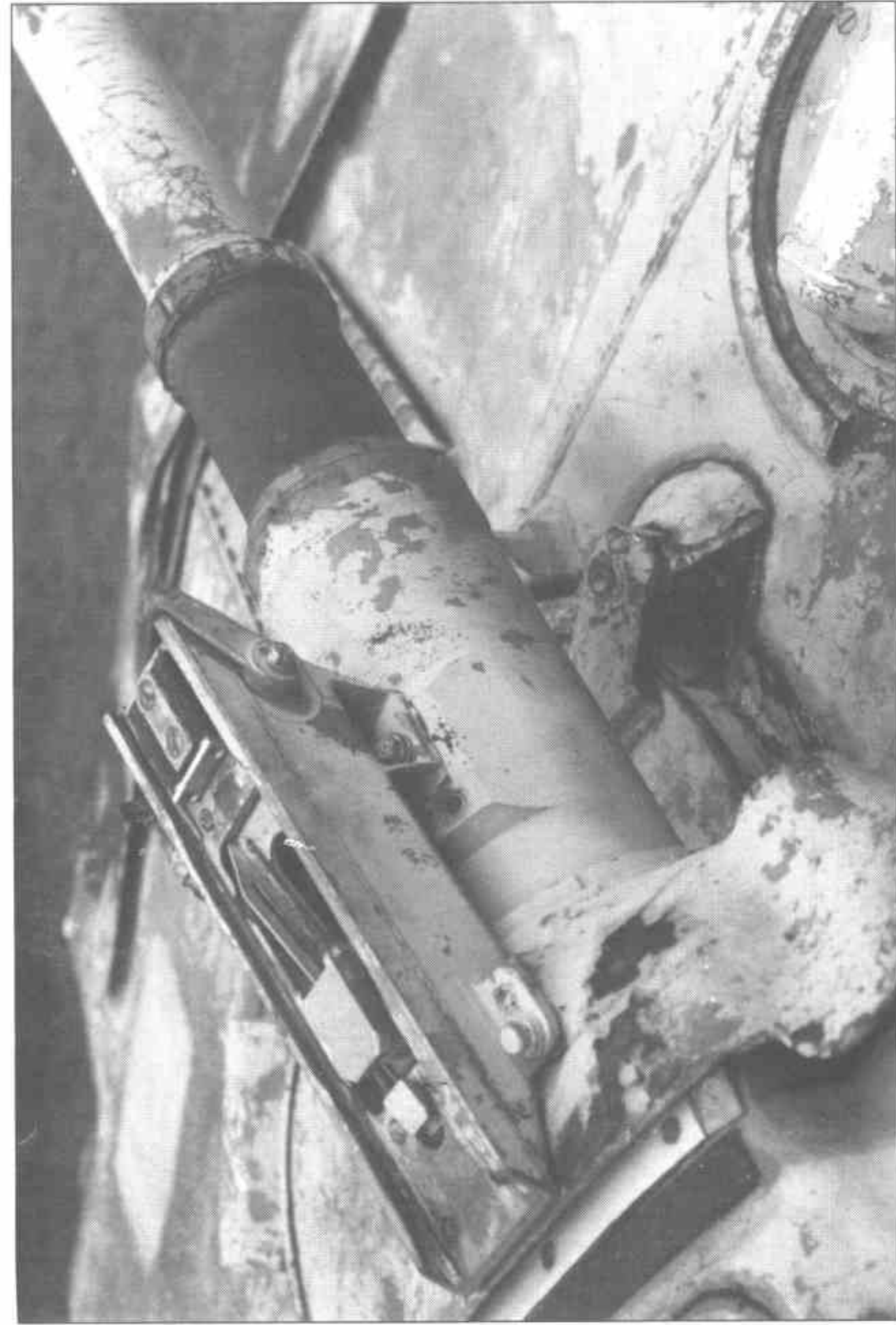
— Направляющие ПТУР «Малютка» крупным планом. Эта система устанавливалась на ранних БМД-1 с 1968 по 1978 год, когда была заменена ПТУР 9П135М. (фото Джима Кингера)
