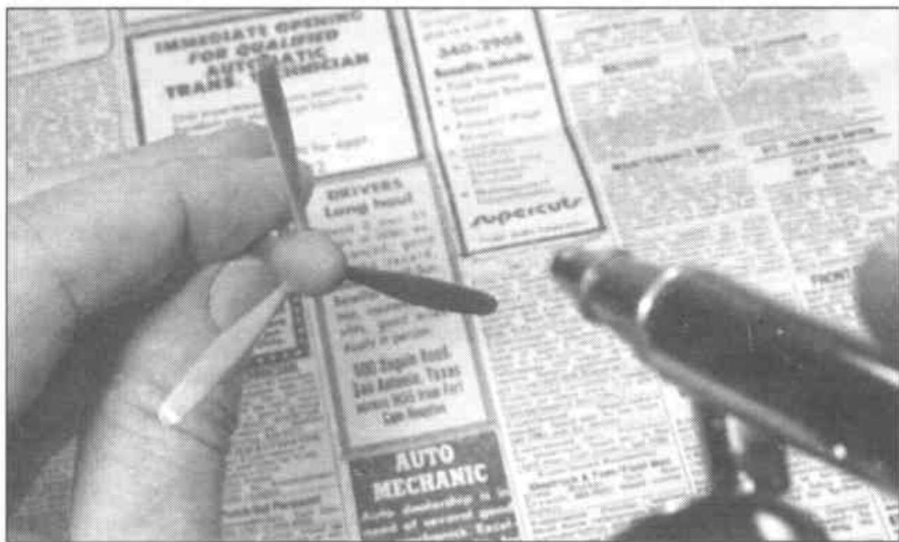
Обычно сначала в желтый цвет окрашивают кончики лопастей воздушного винта. После высыхания краски кончики закрывают масками и окрашивают сами лопасти.
