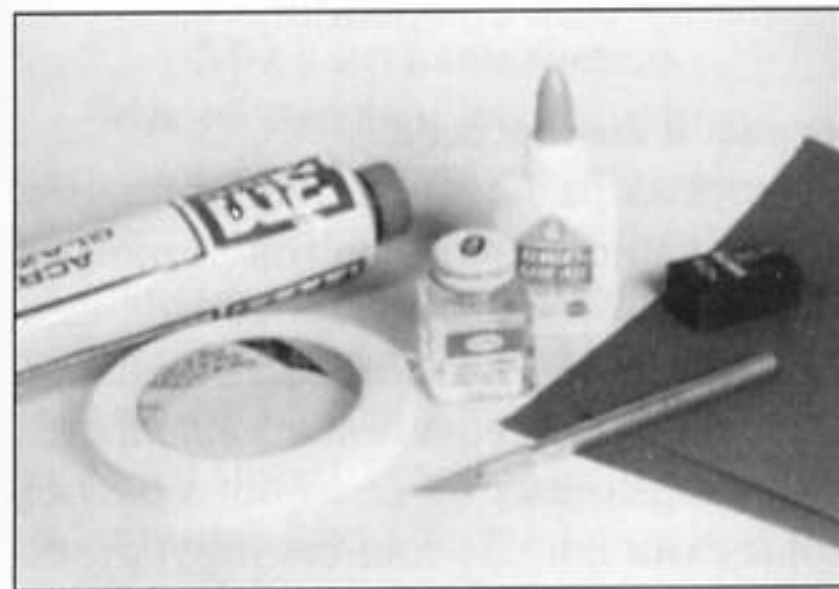
Основные инструменты моделиста: шпаклевка, маскировочная лента, жидкий клей, густой клей в тубике, модельный нож, шкурка.
