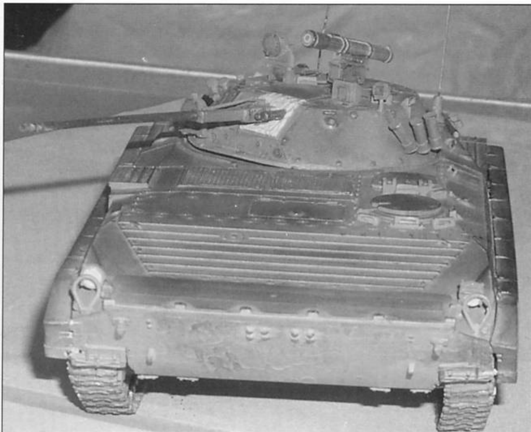
После покраски оказалось, что передок шпаклевали мало - заметны щели. Гусеничные траки подходят к друг другу хорошо, но в звездочку ведущего колеса вставить не хотят, поэтому здесь придется помучиться при подгонке.
