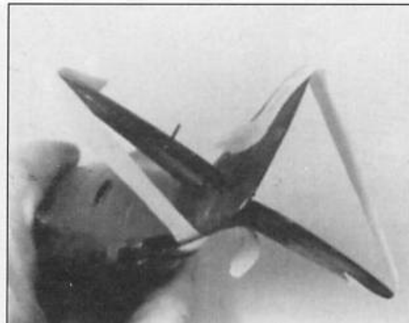
Зафиксировать стабилизатор до высыхания клея можно маскировочной лентой.
