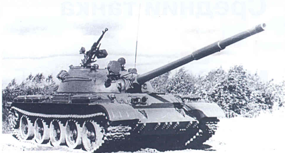
Танк Т-62 выпуска 1972 года. Главным внешним отличием стала установка крупнокалиберного зенитного пулемета на люке заряжающего
