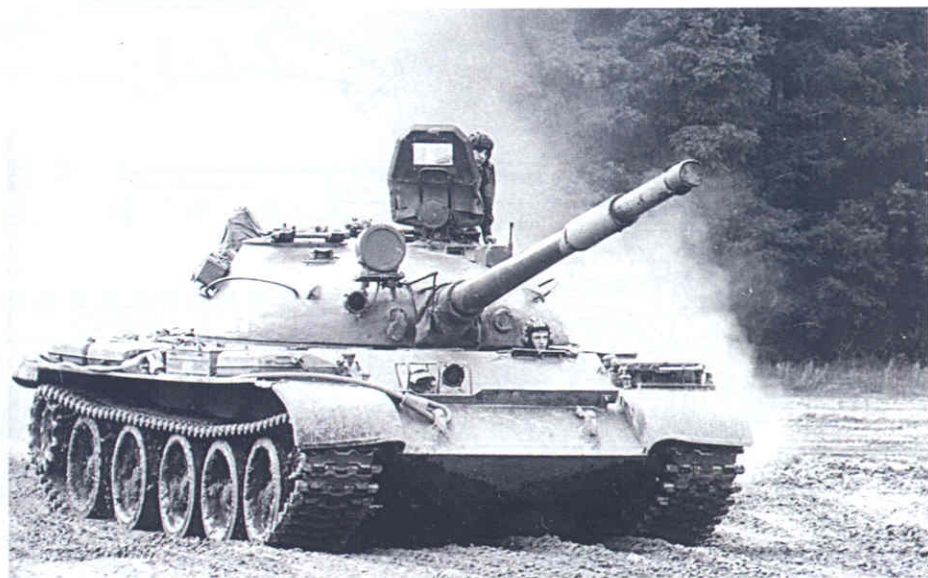
Учебный танк Т-62 на танкодроме. На открытую крышку командирского люка надет специальный кожух, защищавший командира машины от грязи, летящей из-под гусениц впереди идущего танка
