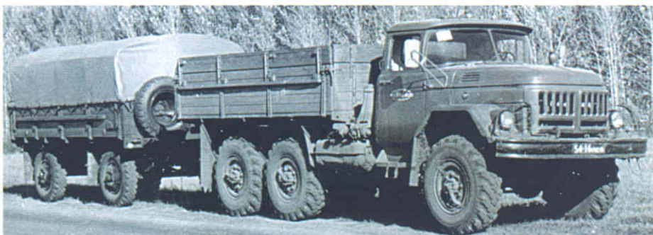
Автопоезд в составе ЗиЛ-131 с грузовой платформой от ЗиЛ-130 (установлена потребителем) и прицепом СМЗ-8325
