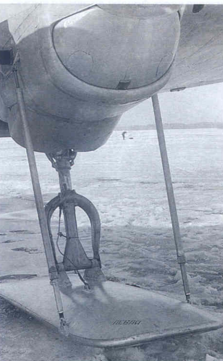
Мотогондола СБ выпуска второй половины 1940 г. со специальным ложементом для убираемых в полете лыж
