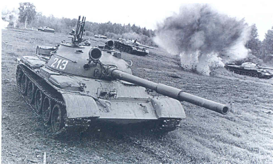
Учебная танковая атака. На переднем плане – танк Т-62 выпуска после 1972 года. На турели люка заряжающего хорошо виден станок 12,7-мм зенитного пулемета ДШКМ
