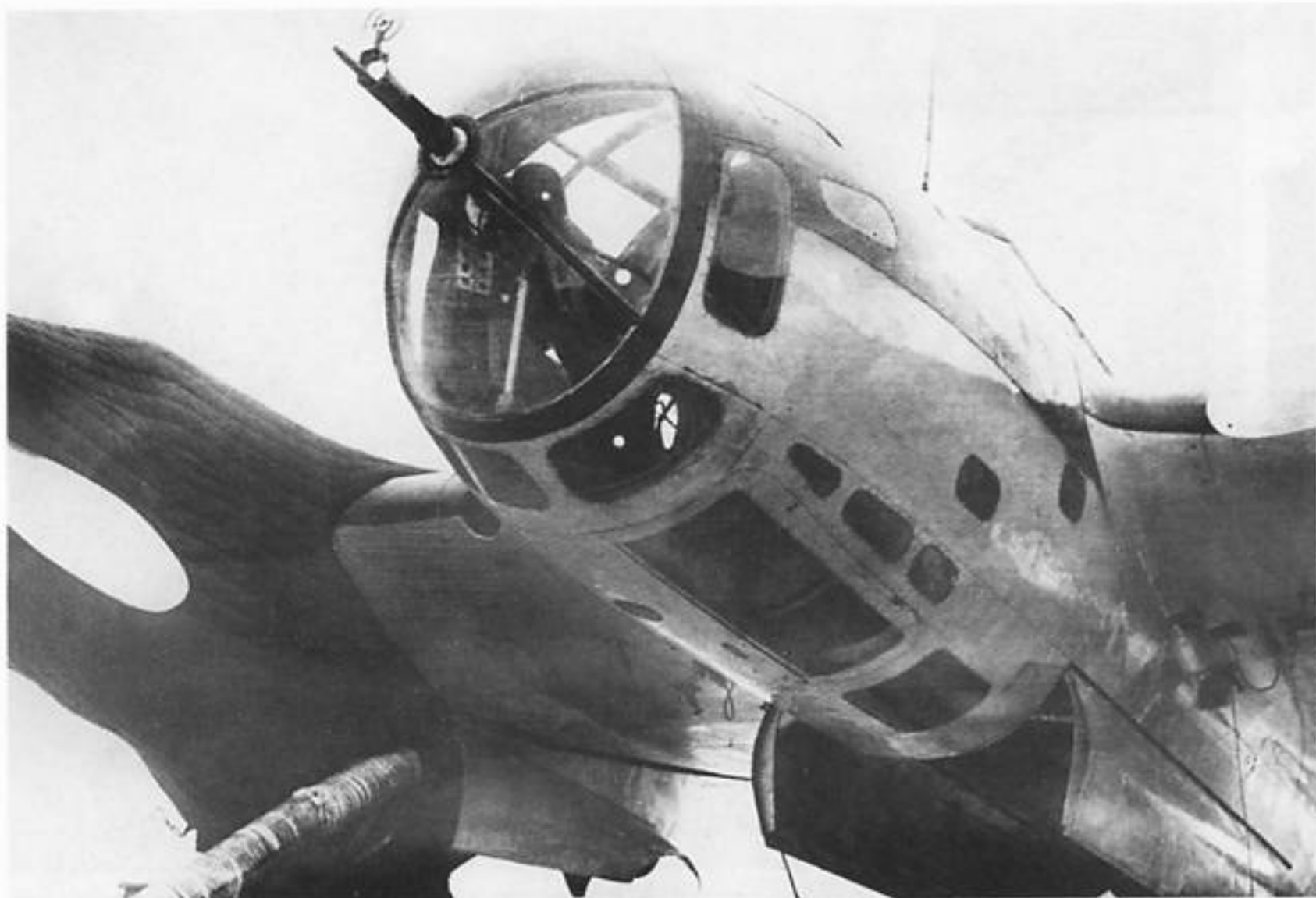
Носовая стрелковая установка НУ. Под чехол правого мотора подается по гибкому рукаву теплый воздух от аэродвигателя.
