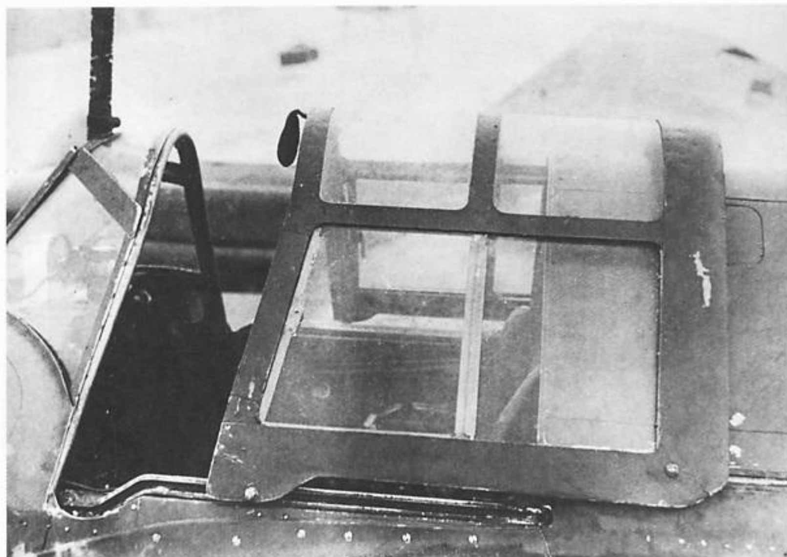
Рельсы фонаря pilota имели «ступеньку», поднимающую фонарь над гаргротом при сдвиге его назад.
