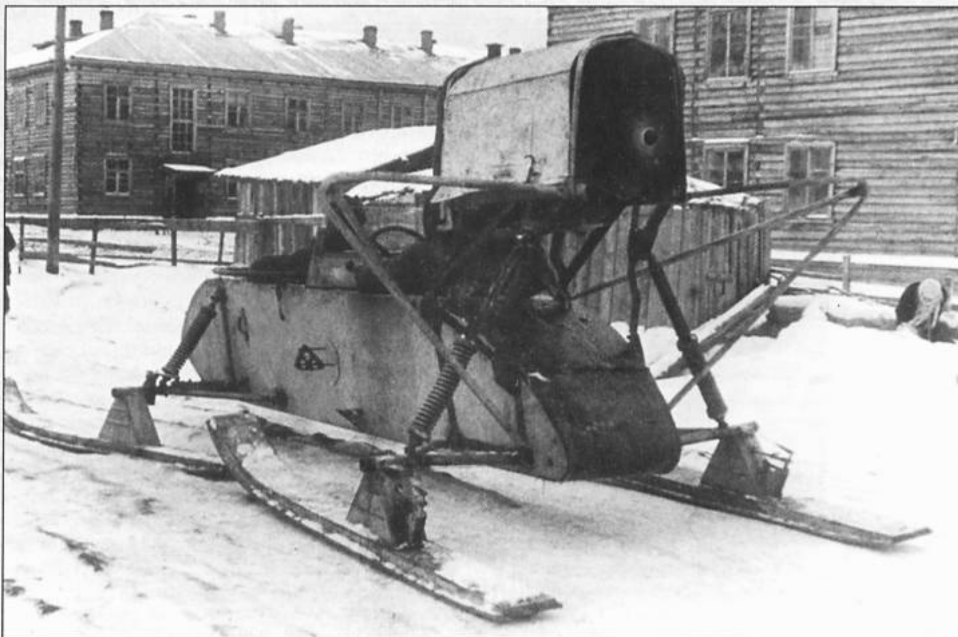
РФ-8 с подмоторной рамой кустарного изготовления.
