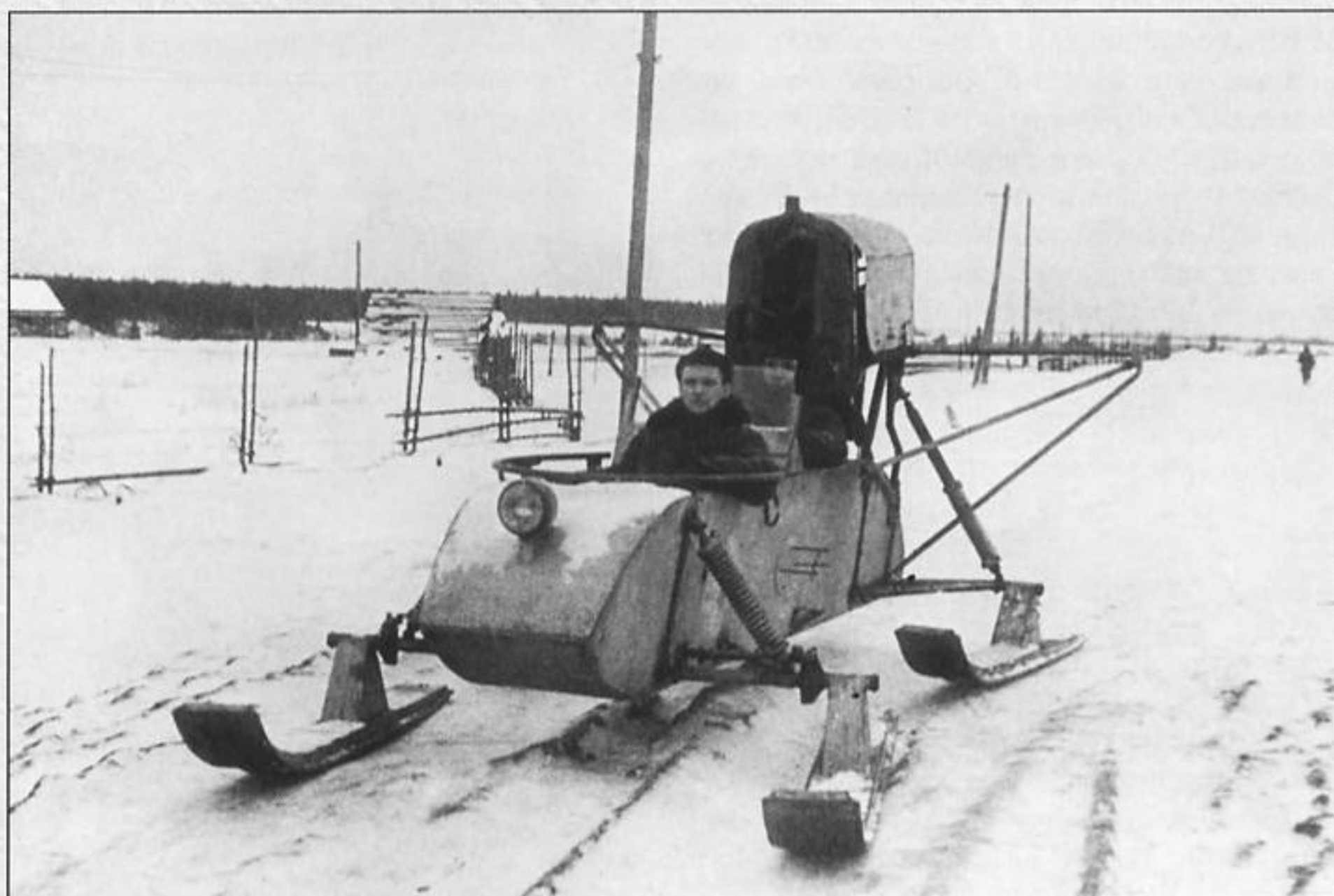
РФ-8 с подмоторной рамой кустарного изготовления.
