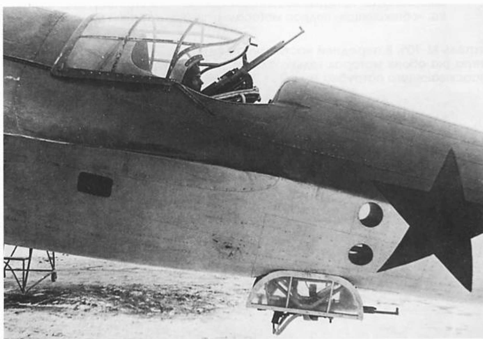
Верхняя турель ТСС-1 и нижняя МВ-2 в боевом положении.
