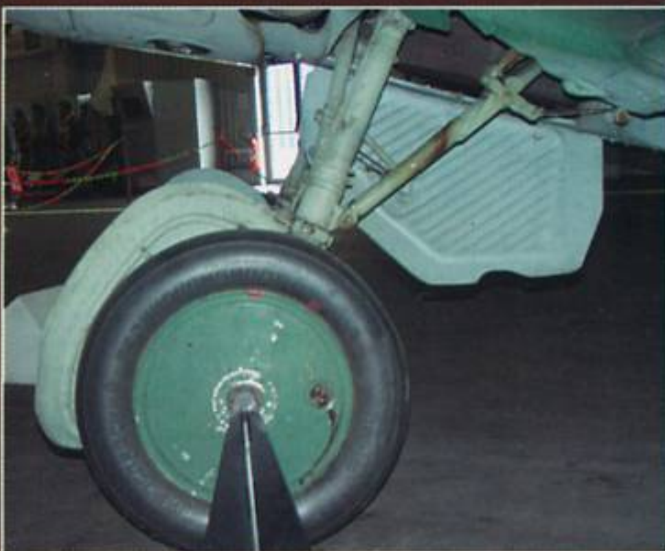
На этой фотографии стойки шасси обратите внимание на тяги закрытия створок.
