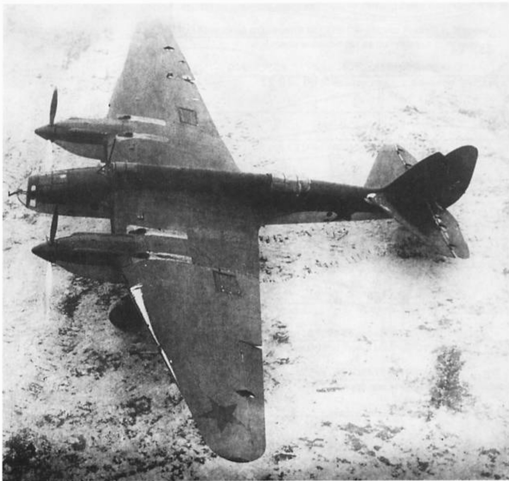
Ар-2. На правом элероне и левой половине руля высоты на время испытаний укреплены датчики СОР. На этом самолете выходные жалюзи воздушных каналов водорадиаторов раннего типа. Задние поверхности лопастей винтов окрашены в черный цвет.
