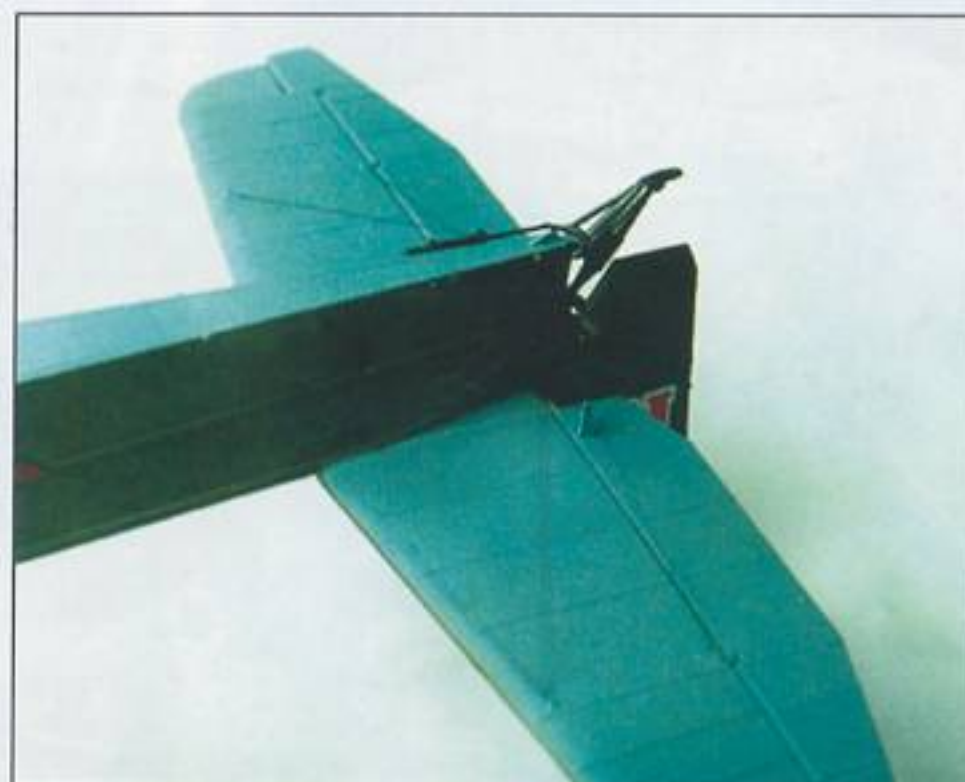
Хорошо выполнен костыль, со всеми опорами и амортизацией. Растяжки натянуты из капроновой нити от ленточки для девчачьих бантиков и вклеены в просверленные отверстия на Super Glue.
