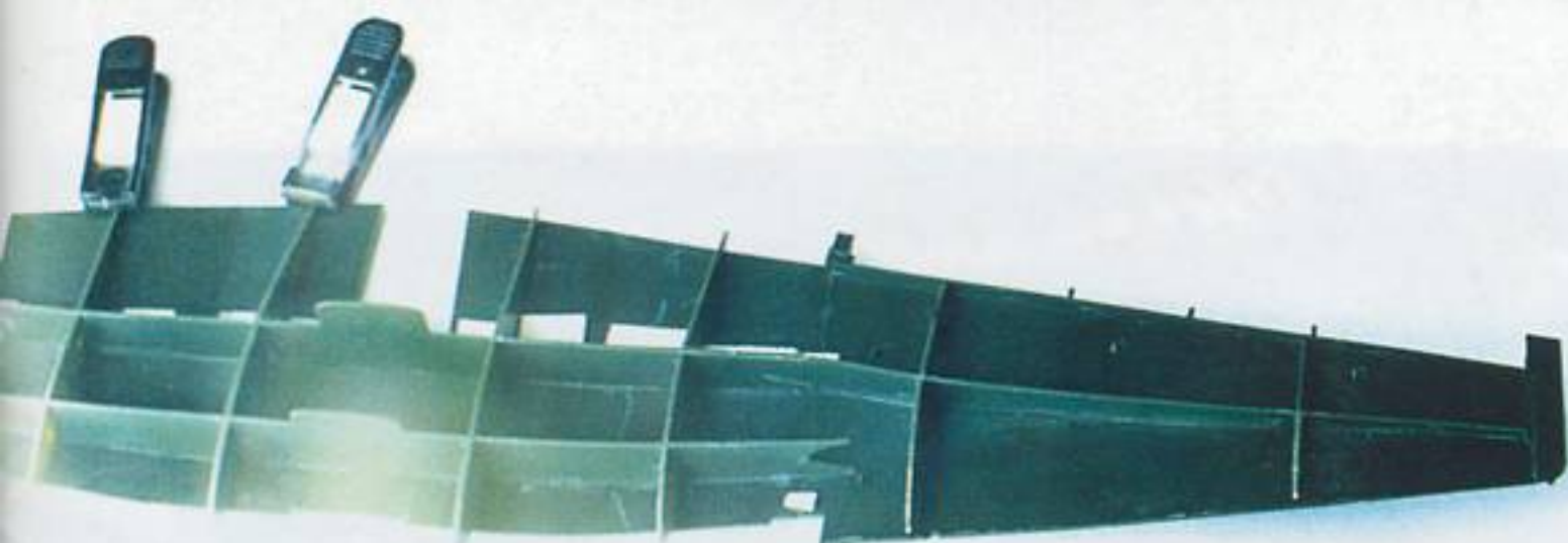
По стыкам панелей обшивки крыла подклеены дополнительные усиления.
