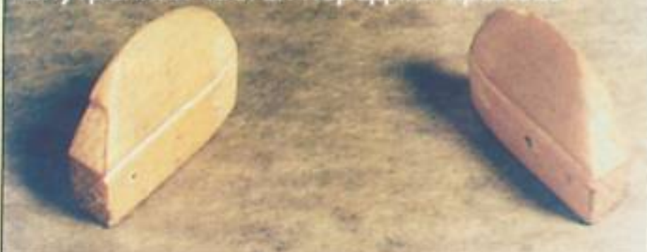
Деревянные болванки для изготовления внутренних частей передних крыльев
