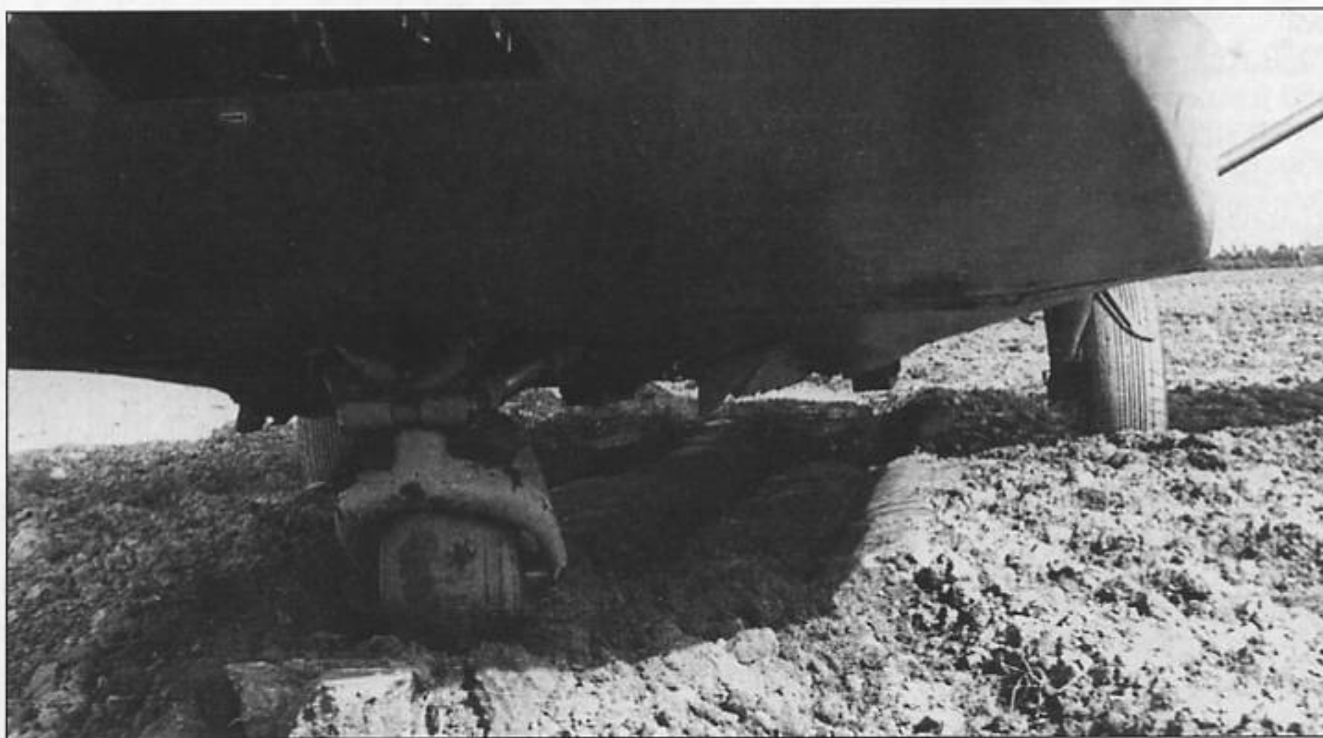
Вверху: В систему шасси подано давление — планер приподнялся с земли. Внизу: Посадка на пашню на лыжах — колеса подобраны, планер лежит на «брюхе».
