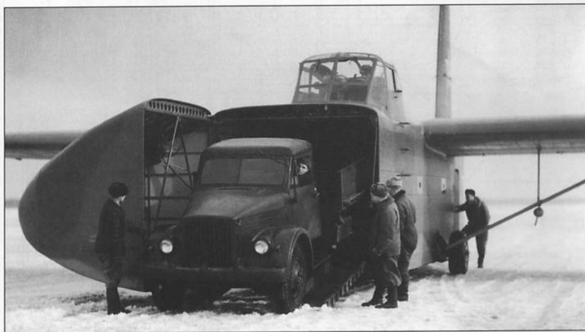
Вверху: Газ-67Б в «чреве» Як-14. Внизу: Погрузка ГаЗ-51. Носовой обтекатель отведен в сторону.
