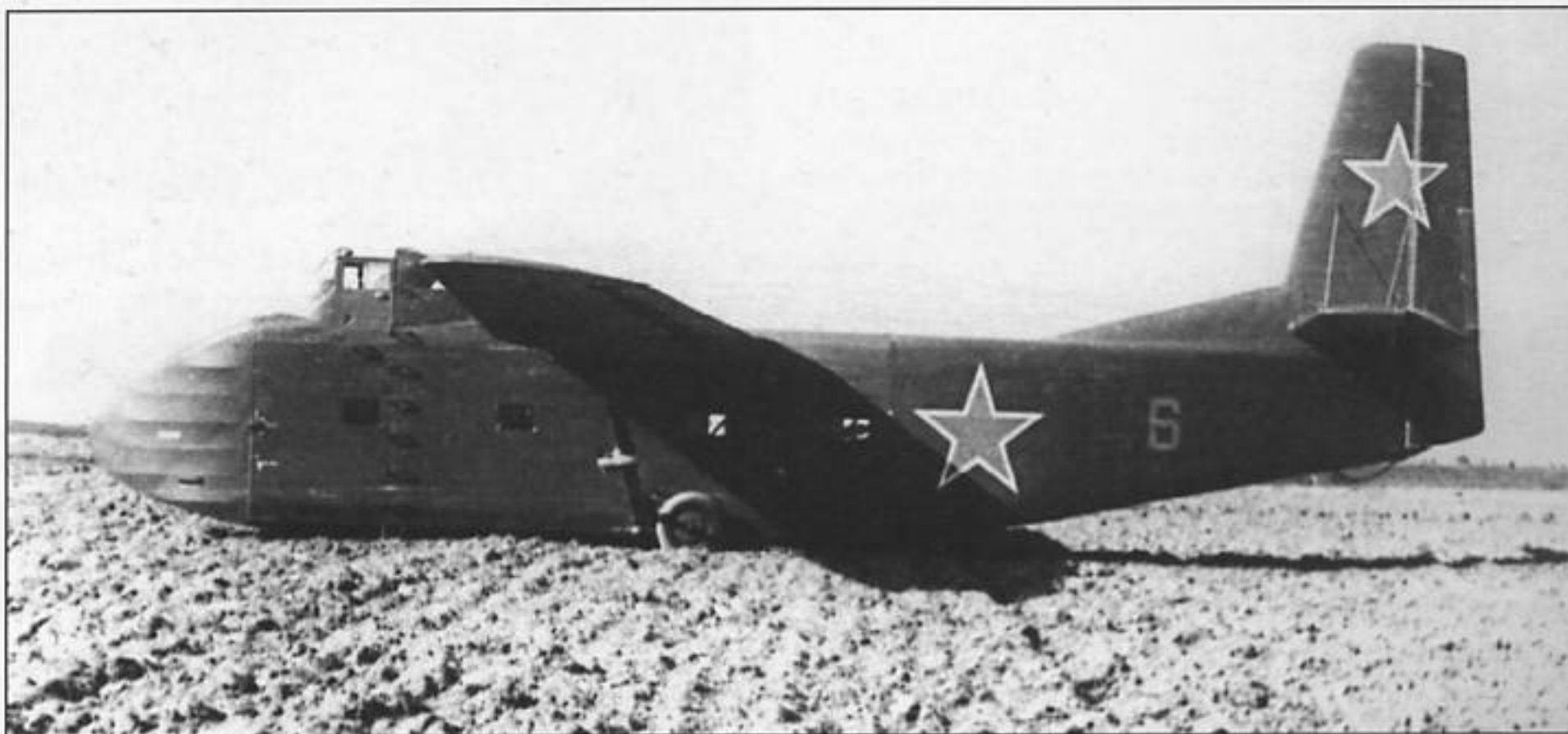
Вверху: В систему шасси подано давление — планер приподнялся с земли. Внизу: Посадка на пашню на лыжах — колеса подобраны, планер лежит на «брюхе».
