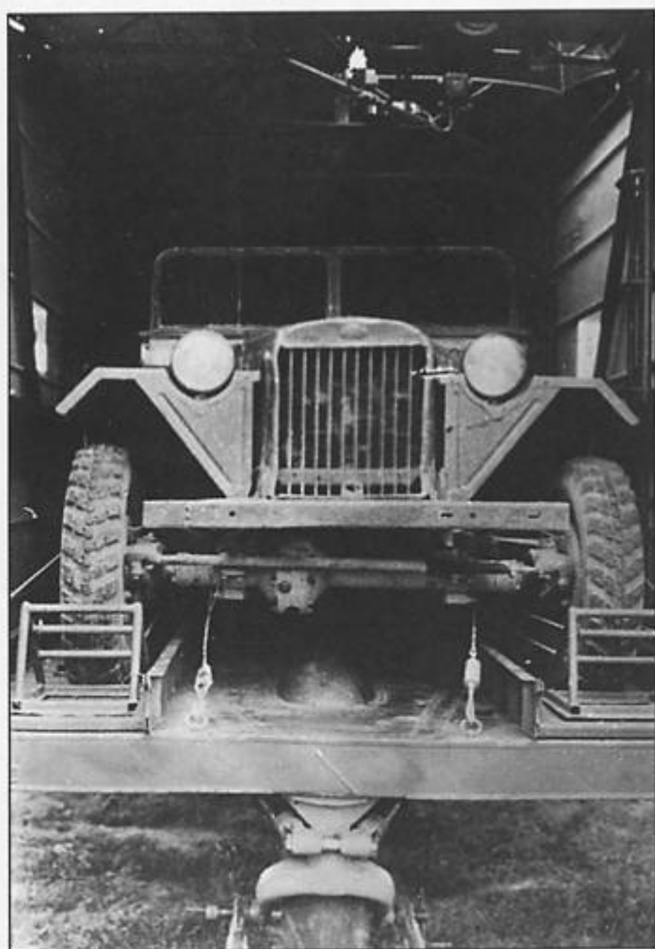
Вверху: Газ-67Б в «чреве» Як-14. Внизу: Погрузка ГаЗ-51. Носовой обтекатель отведен в сторону.
