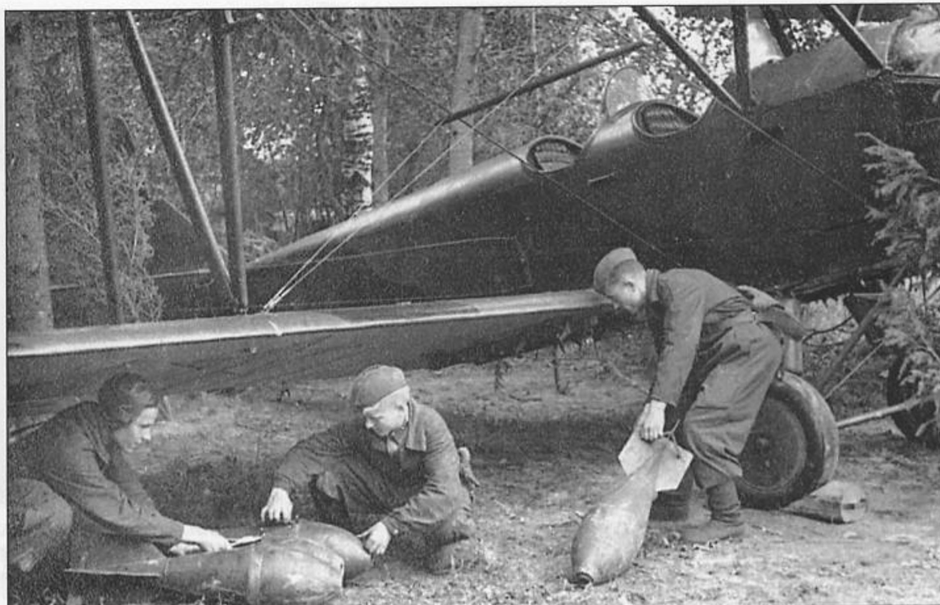
Подготовка 50 кг бомб для подвески на У-2ВС. Обратите внимание на гранитолевые спинки сидений экипажа и отсутствие оборонительного пулемета. Западный фронт, 1942 г.
