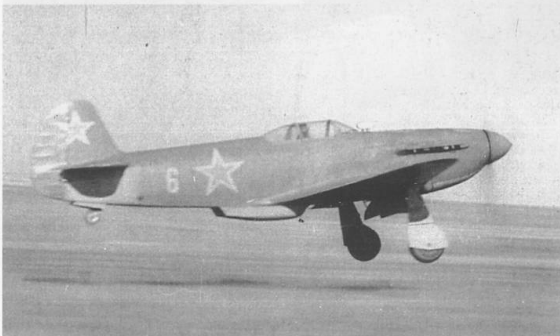
1948 г. Як-3, принадлежащий 1 ГвИАП, в послевоенной окраске. Верхние и боковые поверхности, вероятно, покрыты серо-голубым аэролаком АМТ-11. Нижние — АМТ-7.
