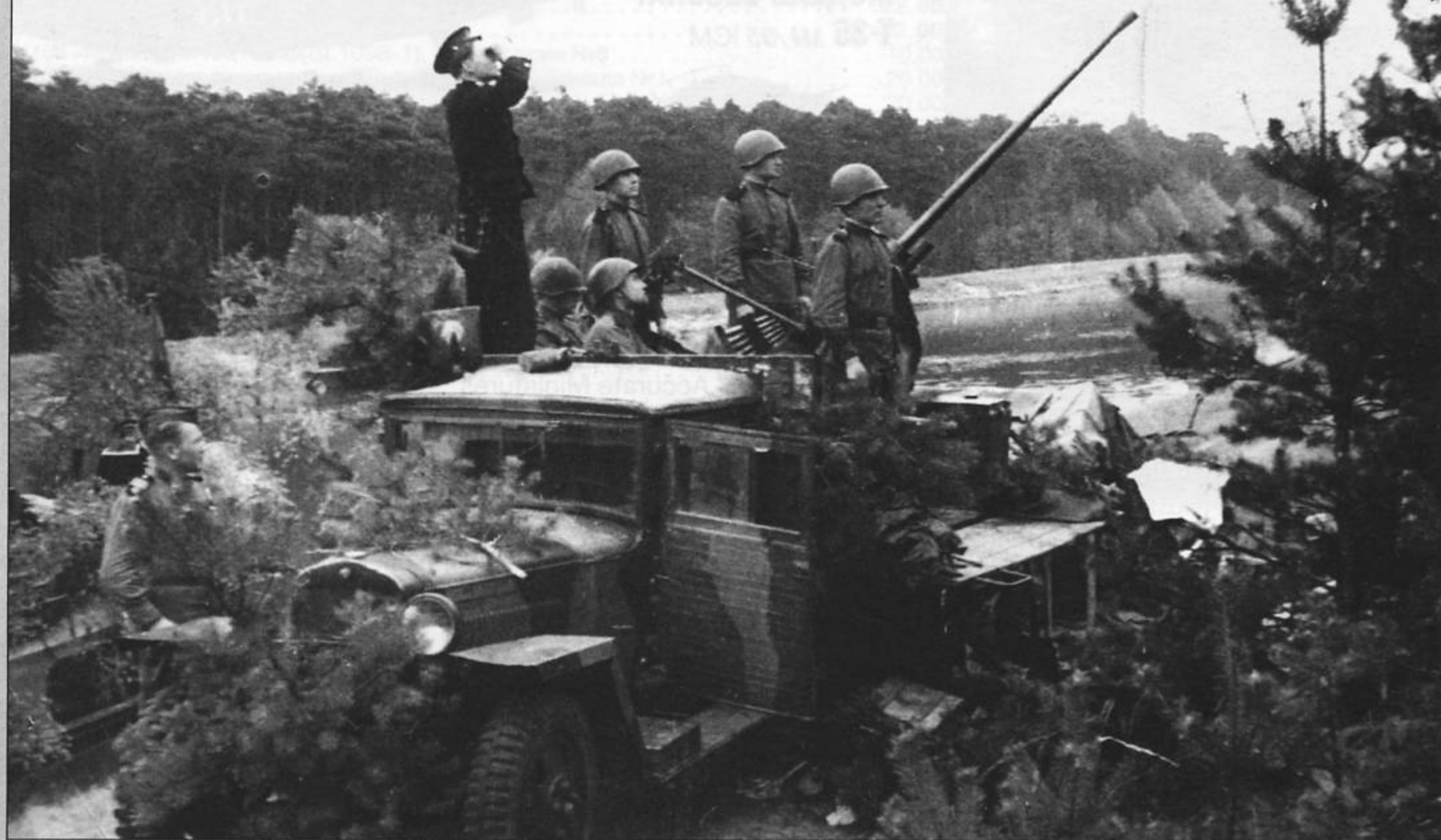
Зенитчики охраняют войска от налетов вражеской авиации. Ленинградский фронт, Выборгское напр., лето 1944 г. В кузове машины ГАЗ-ММ установлен 25-мм зенитный автомат. (фото предоставил Г.Петров)
