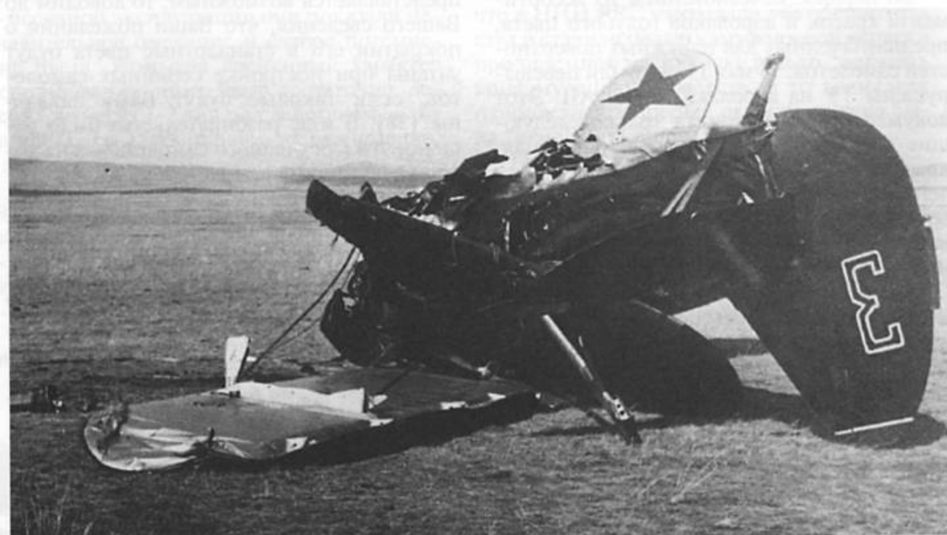
На фотографии обломков этого И-15бис хорошо заметен блеск нижней поверхности крыла, окрашенной аэролаком алюминиевого цвета. Верхние поверхности - зеленые. Самолет (зав. №3826, выпущен 22.04.38 г.) 3-й эскадр. 70 ИАП потерпел аварию 27.04.39 г. южнее Улан-Батора (Монголия). Летчик л-т Рыбаков А.П. РГВА.
