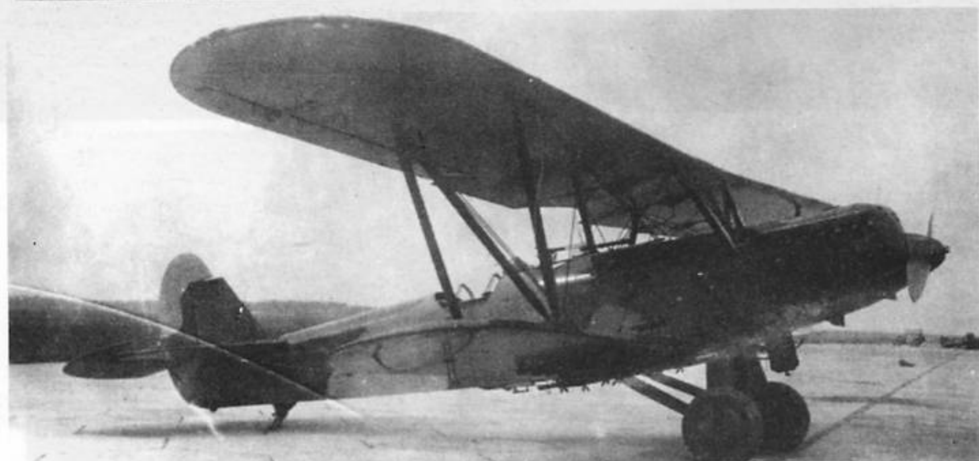
Сверху: 1936 г. Разведчик Р-5 в трехцветном камуфляже, использовавшийся в качестве контрольного при испытаниях мелкопятнистой окраски. РГВА
