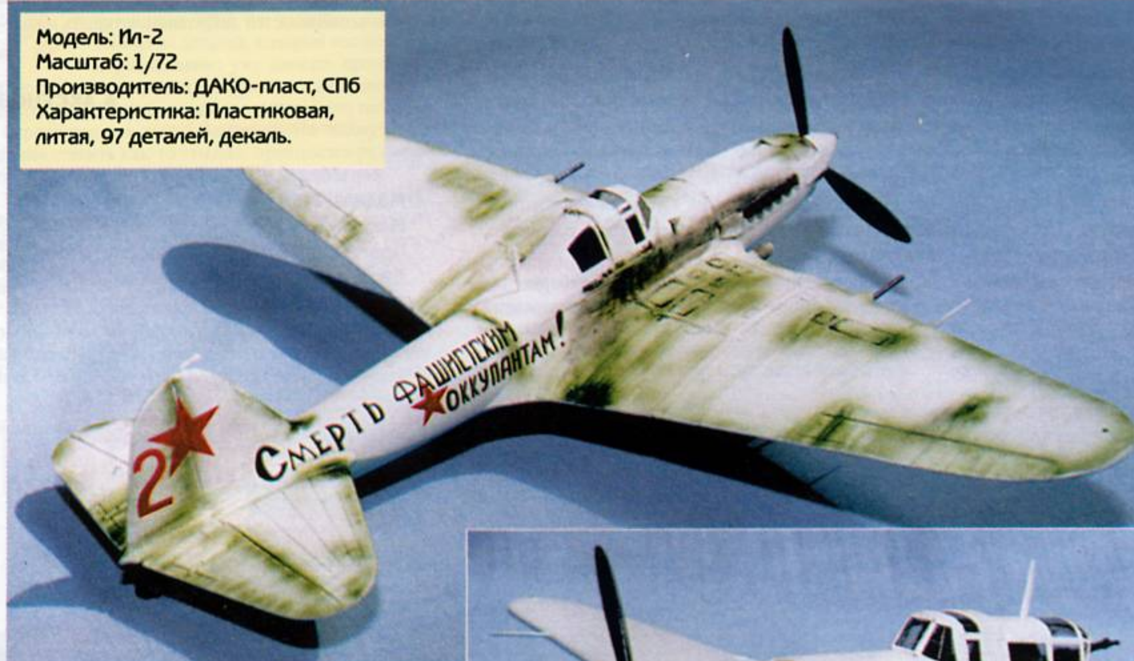
Модель: Ил-2М-3 с Н-37 Масштаб: 1/72 Производитель: ДАКО-пласт, СПб Характеристика: Пластиковая, литая, 95 деталей, декаль.
