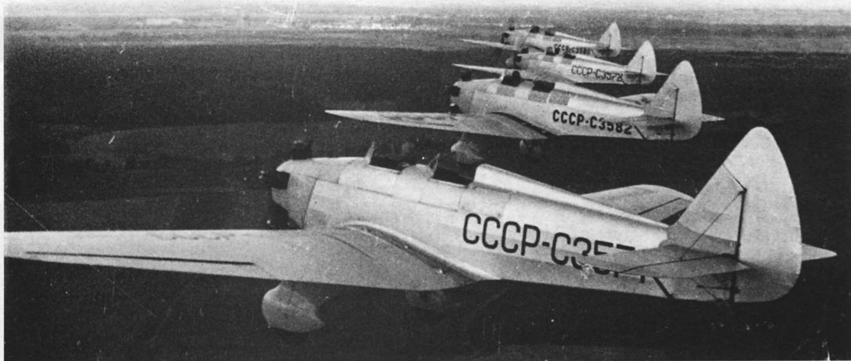
Светло-серые УТ-2. Металлические капоты окрашены масляной светло-серой эмалью АЭ-9, остальные поверхности - светло-серым аэролаком АП. Заметно небольшое различие цветов этих покрытий. Тушино, 1938 г. Фото Б. Вдовенко.
