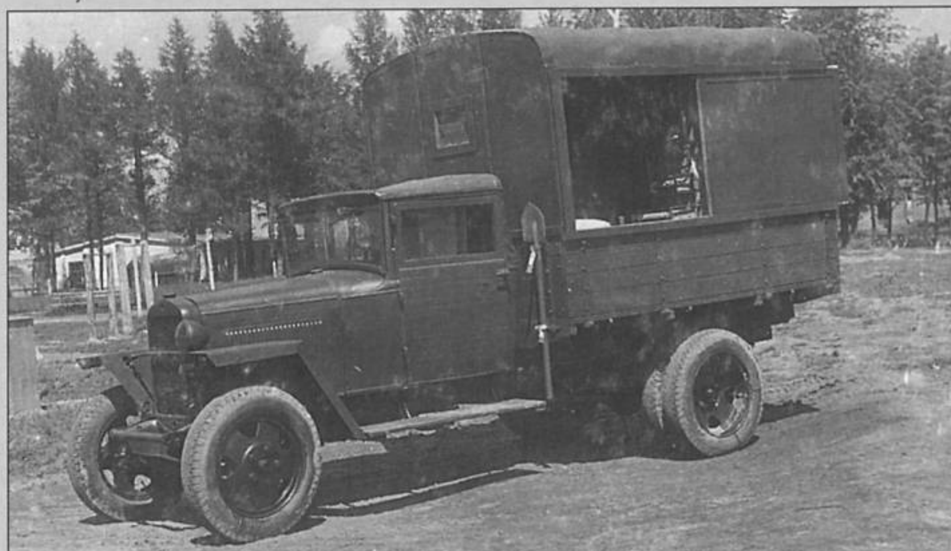
Походно-зарядная (аккумуляторная) станция на ГАЗ-ММ 1943 г. На машине фара нового типа. Фото из архива Е.И. Прочко.
