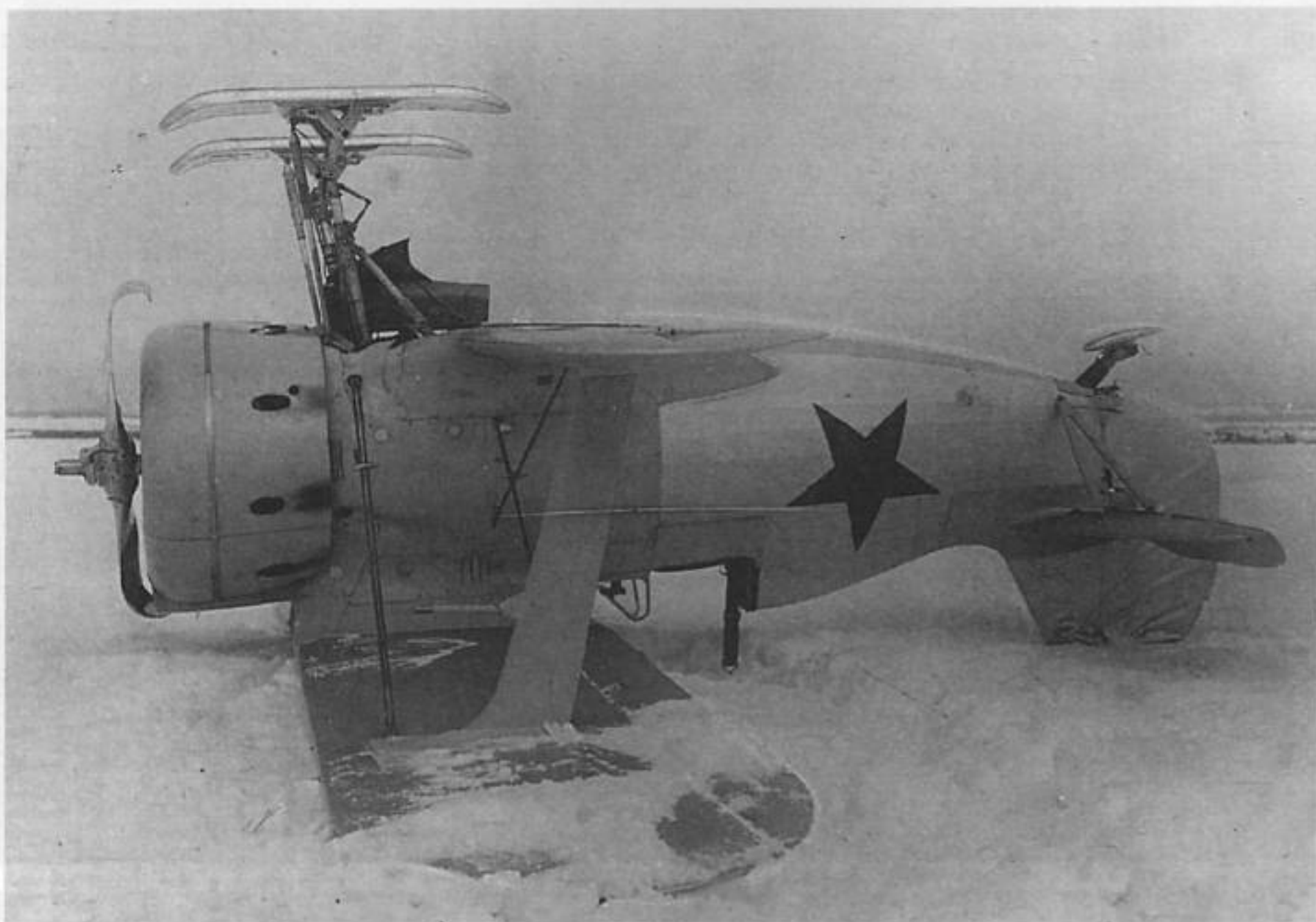
Февраль 1940 г. И-153 (з.№ 6541), потерпевший аварию на ЛИС завода № 19. Однотонная серебристая окраска этого истребителя не дает блеска в условиях рассеянного освещения, характерного для закрытого сплошной облачностью неба.
