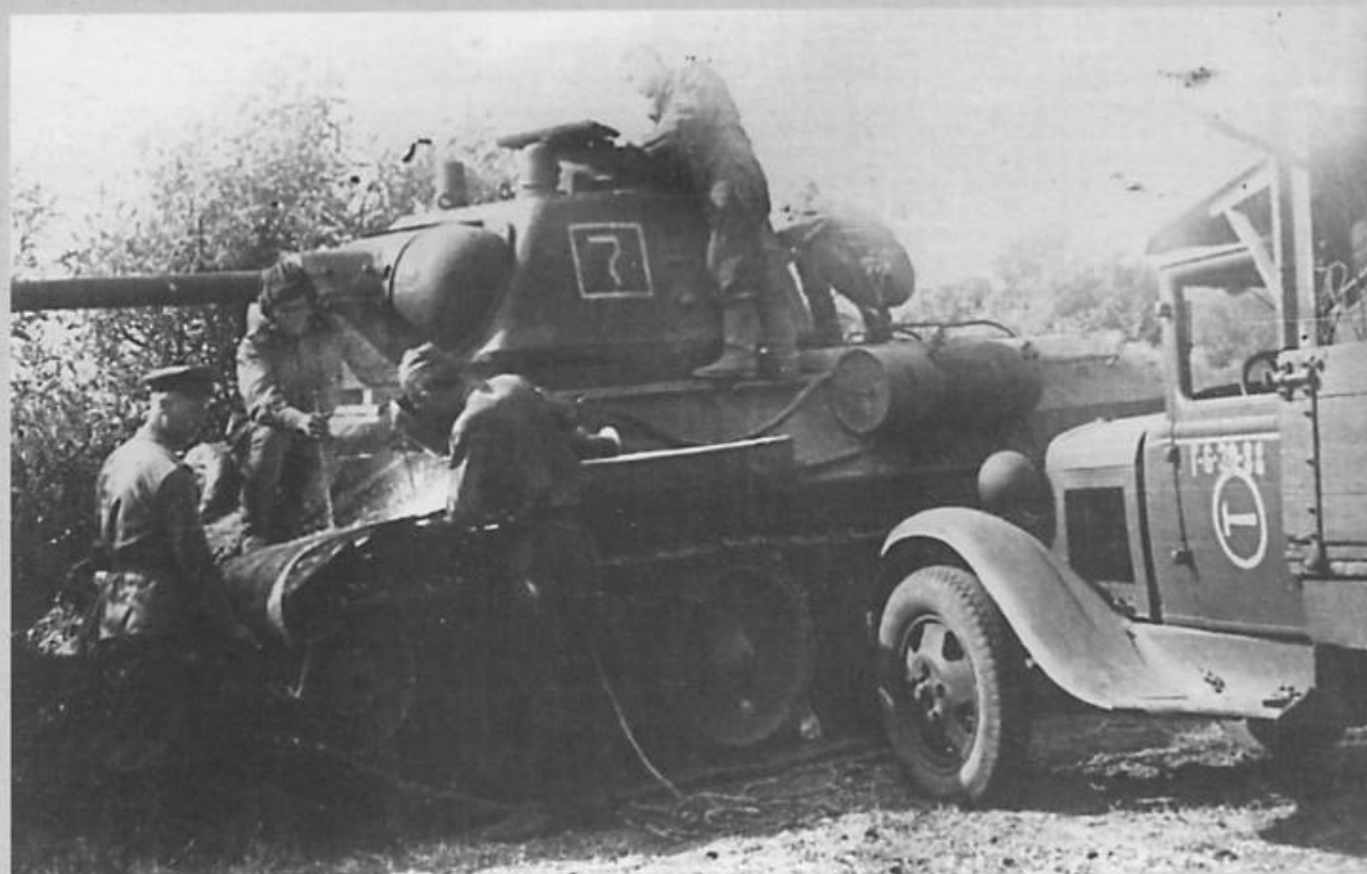
Экипаж походно-ремонтной мастерской приваривает оторванное крыло Т-34. На дверке кабины номер Г-6-30-88 и эмблема - молоток в круге. 3-й Украинский фронт, 4 мотомехкорпус, 13 бригада, 1944 г. Фото РГАКФД.
