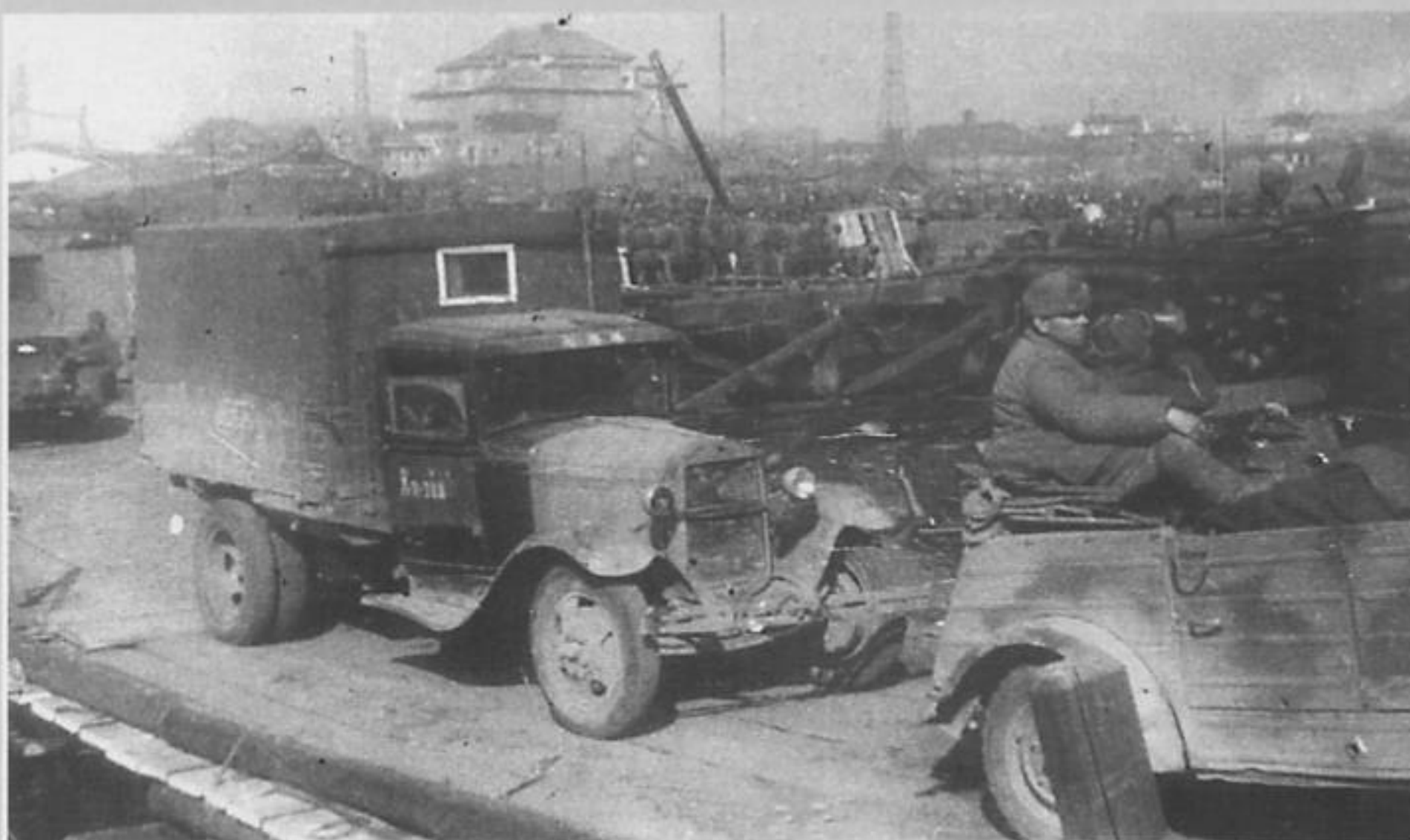
Фургон на шасси ГАЗ-ММ переправляется через реку в Восточной Пруссии. На машине стоят «не родные» фары. 1944 г. Фото РГАКФД.
