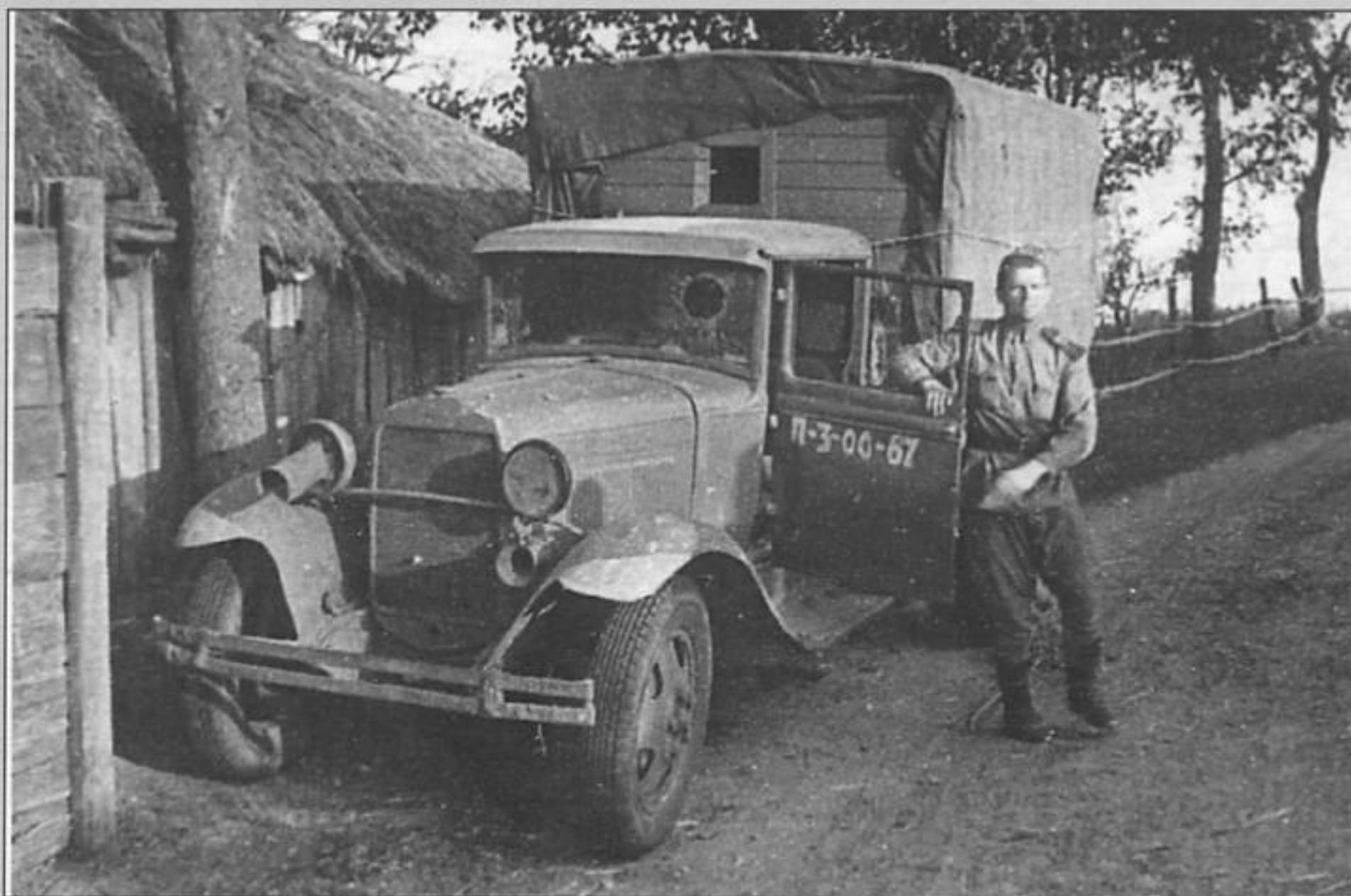
«Полуторки» широко применялись в армии для постройки разнообразных фургонов. На ГАЗ-ММ сержанта А.П.Сивенко стекло левой фары заменено непрозрачным диском, на правой - светомаскировочный козырек. Углы крыльев покрашены в белый цвет для обозначения габаритов машины в темноте. Центральный фронт, село Береза Сумской области, 6.09.43 г. Фото из архива журнала «Воин».
