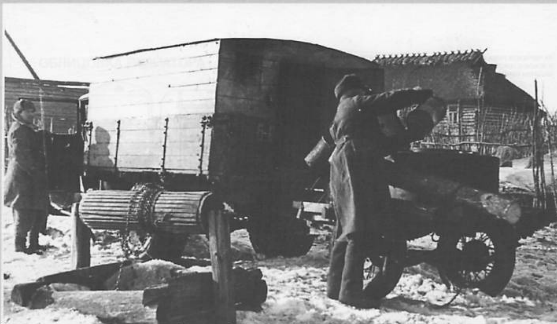
Фургон хоззвода с полевой кухней на буксире. Хорошо видны замки кузова позднего типа. Западный фронт, район Вязьмы, март 1943 г. Фото РГАКФД.
