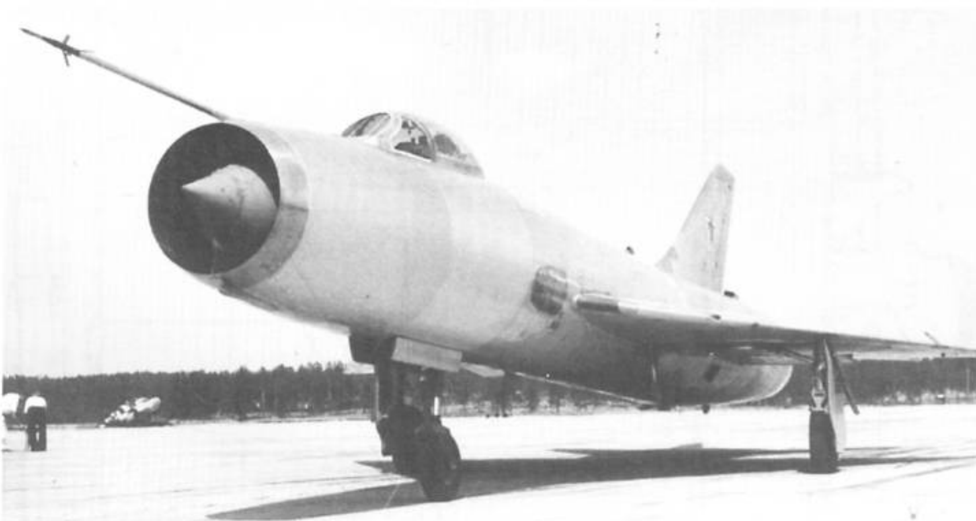
Т-5 с двумя двигателями Р-11 на испытаниях летом 1958 г. Фото ОКБ Сухого.
