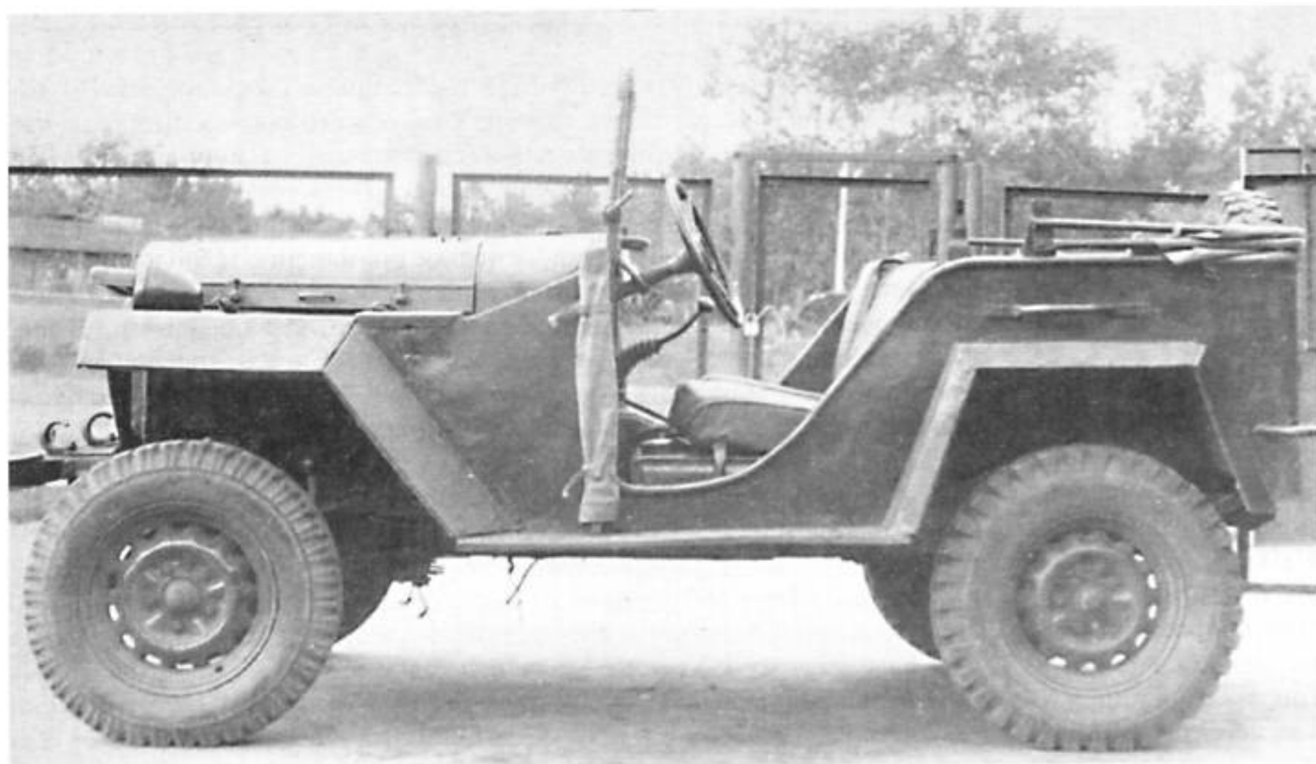
ГАЗ-67Б 1953 года выпуска. Эта машина до сих пор на ходу. Примечание: покрышки колес и рукоятка переключения передач не родные.
