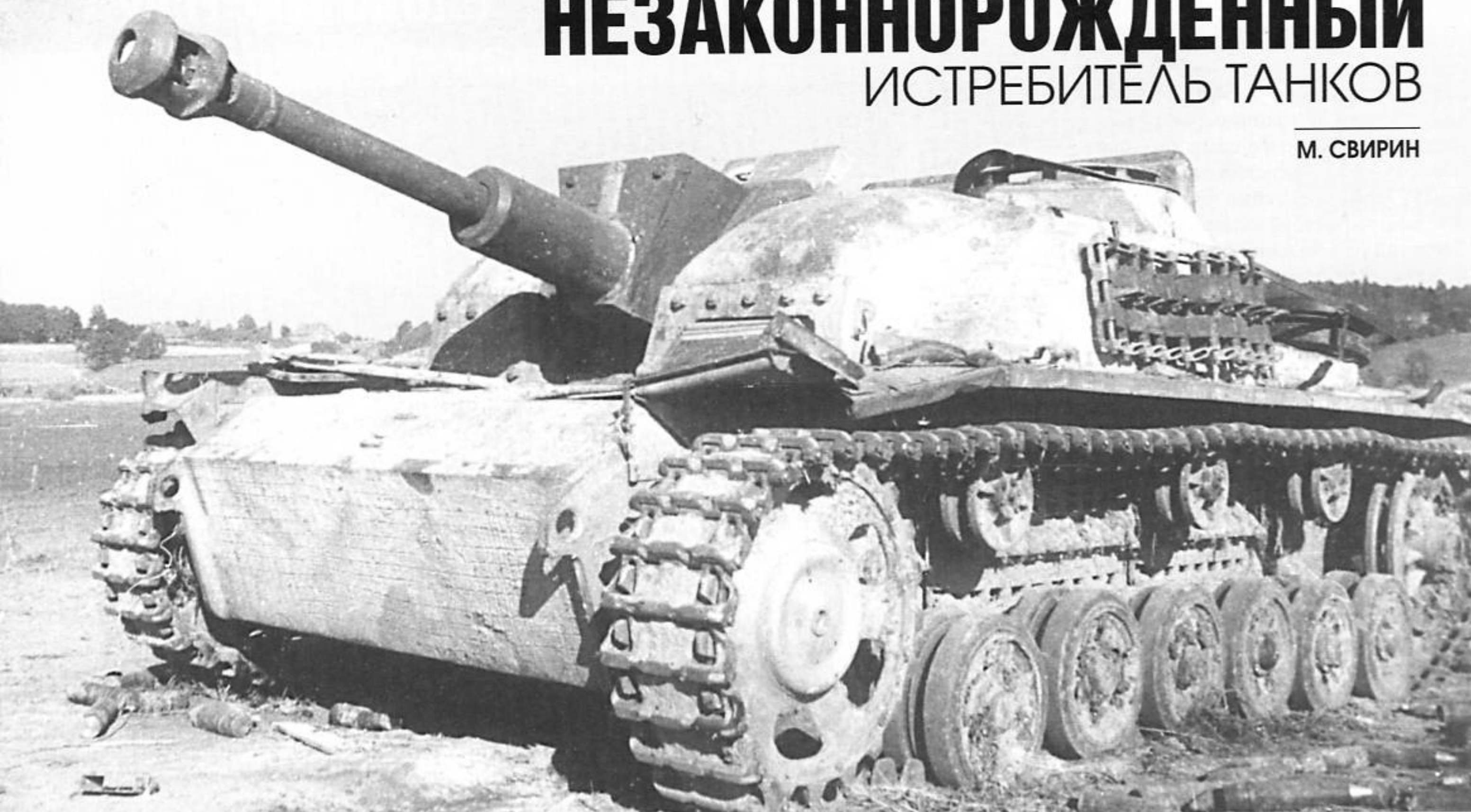
Брошенный StuG 40 Ausf G. 2-й Украинский фронт, май 1944 г. Фото из коллекции Н.Свирина. На приведенной фотографии изображена машина выпуска конца 1943 г. Интересен способ нанесения антимагнитного покрытия «Циммерит» на лобовой части рубки. Покрытие образует «подушки» по обеим сторонам орудия. Поддерживающие катки — цельнометаллические.
