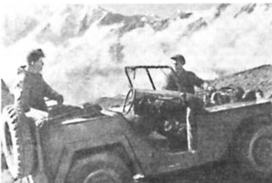
1950 г. Облегченный ГАЗ-67Б со снятым капотом на строительстве высокогорной обсерватории на Эльбрусе.
