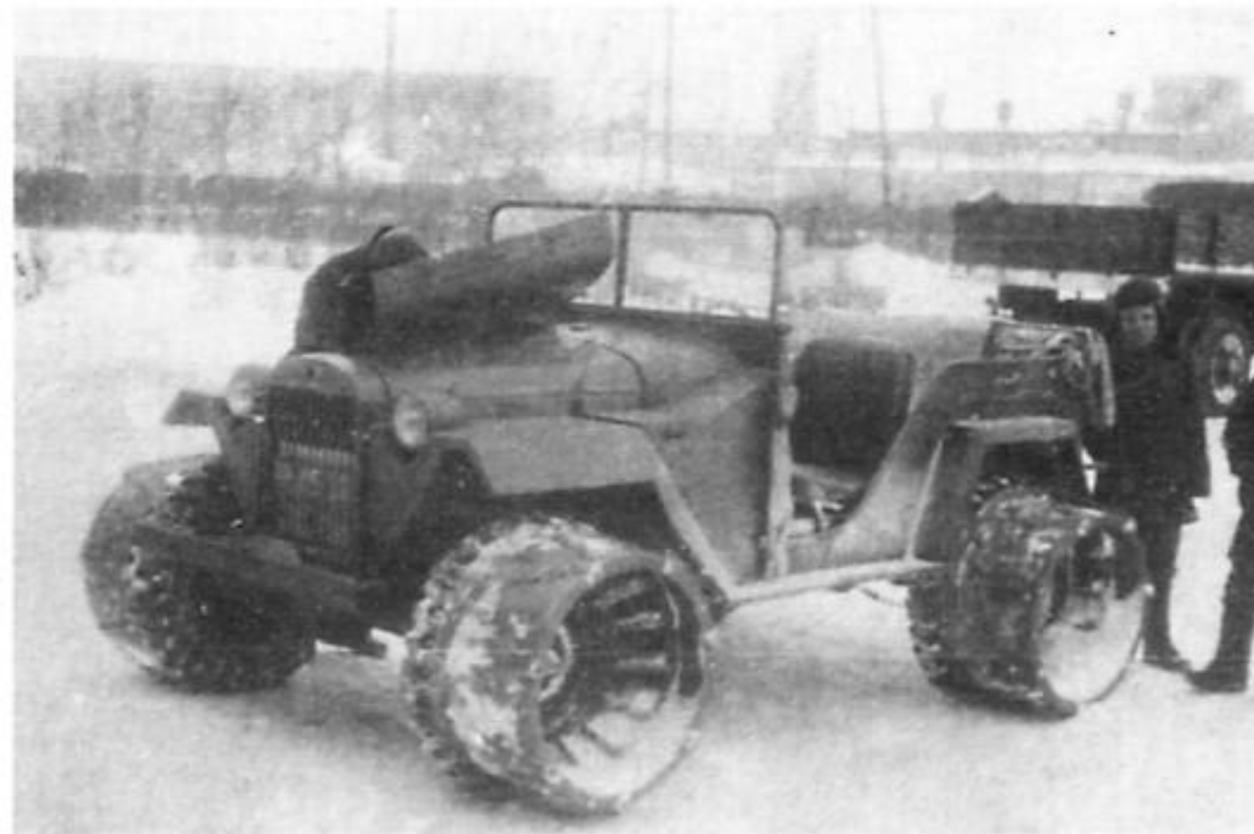
Опыты по повышению проходимости машины по снегу путем установки снегоходных барабанов.
