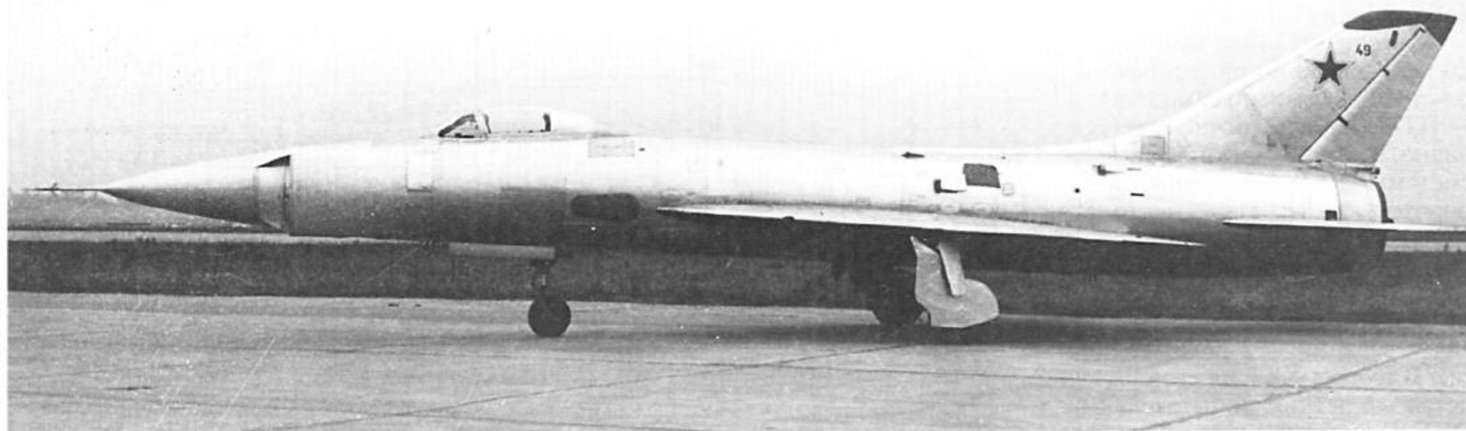
Т-49. Обратите внимание на конструкцию воздухозаборников. Фото ОКБ Сухого
