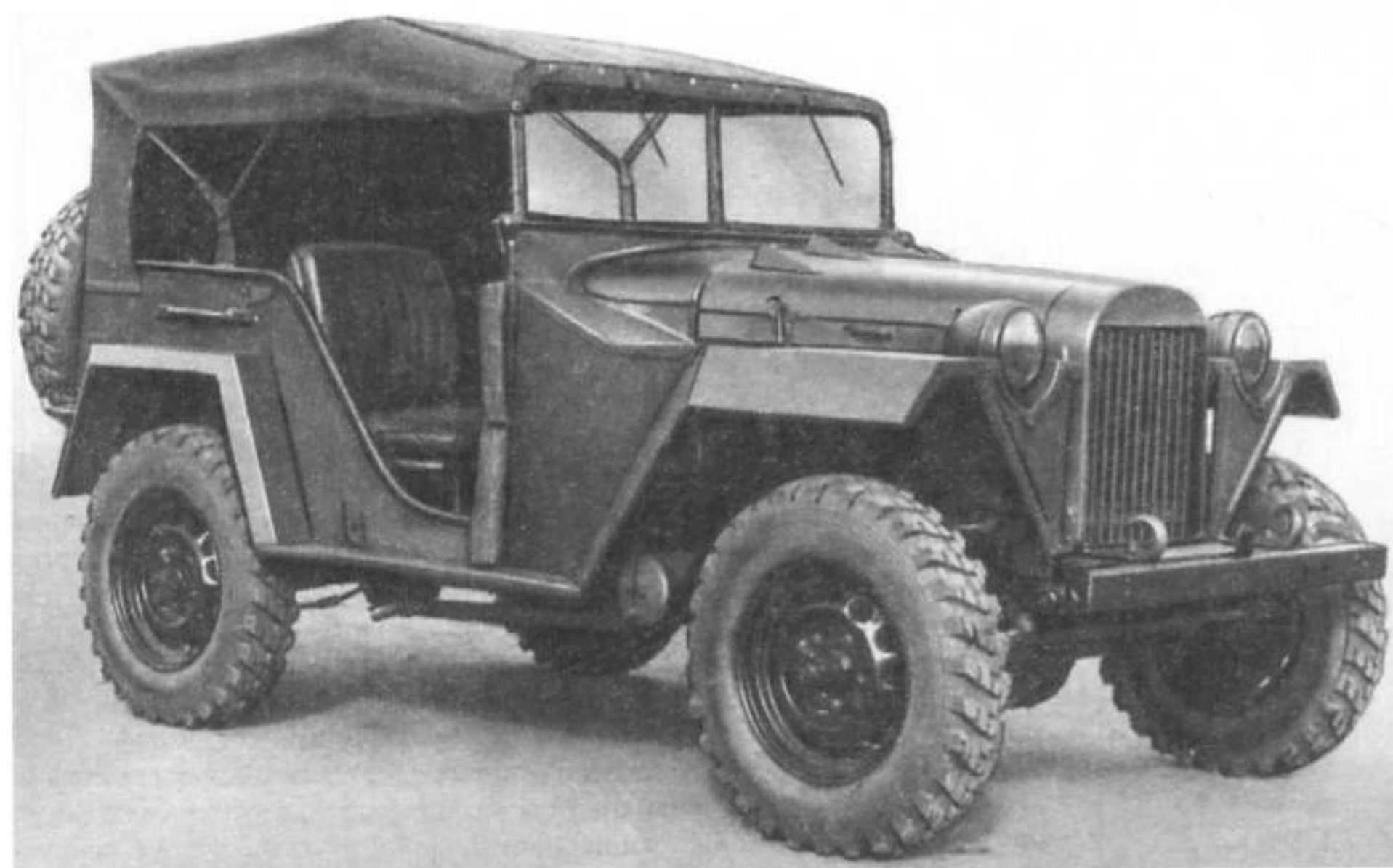
ГАЗ-67 1943 г. выпуска. Обратите внимание на узлы для крепления пилы на правом борту и характерный рисунок протектора типа «елка».
