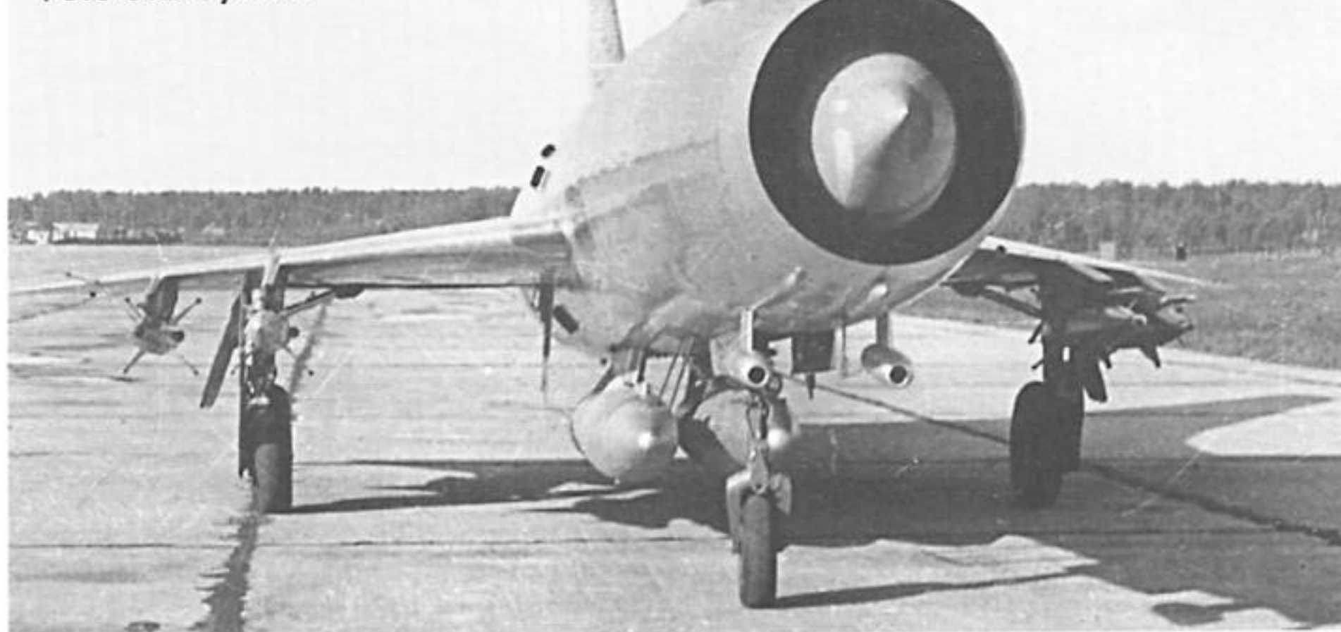
Один из опытных самолетов Т-43. В носовой части фюзеляжа установлены нештатные обтекатели фотоаппаратов. Фото ОКБ Сухого.
