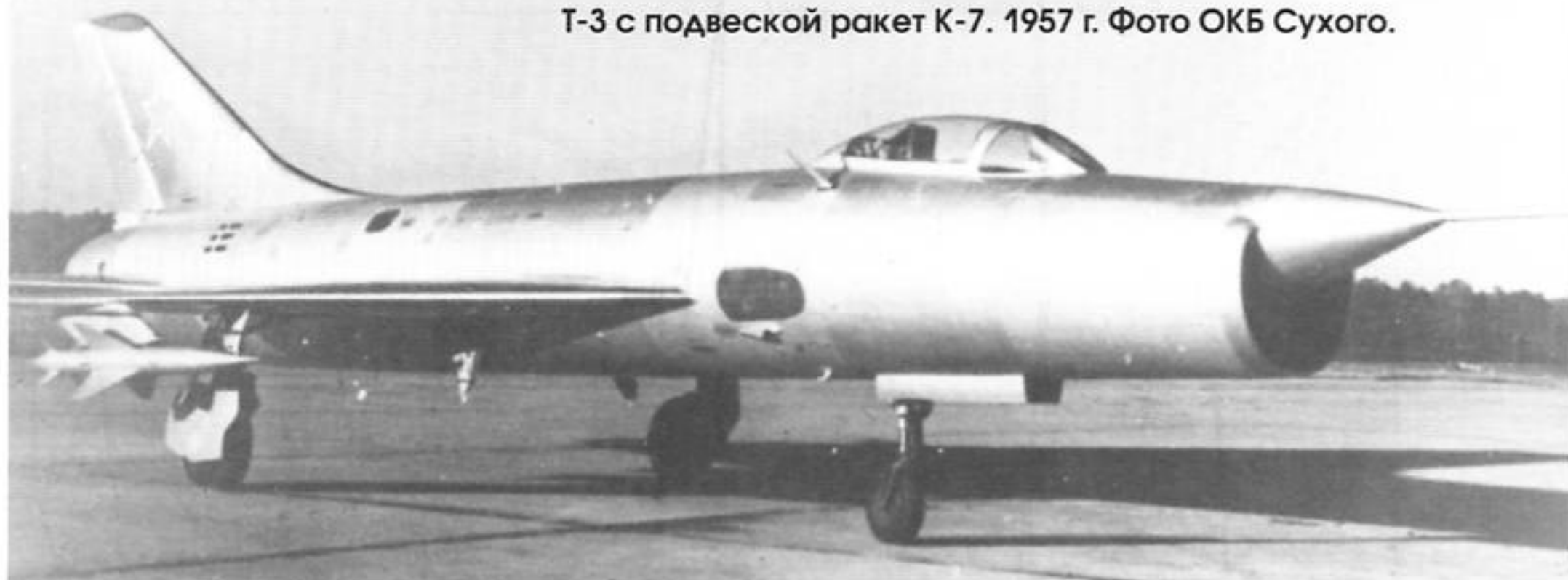
Т-3. Обратите внимание на «дырявые» тормозные щитки. Фото ОКБ Сухого.
