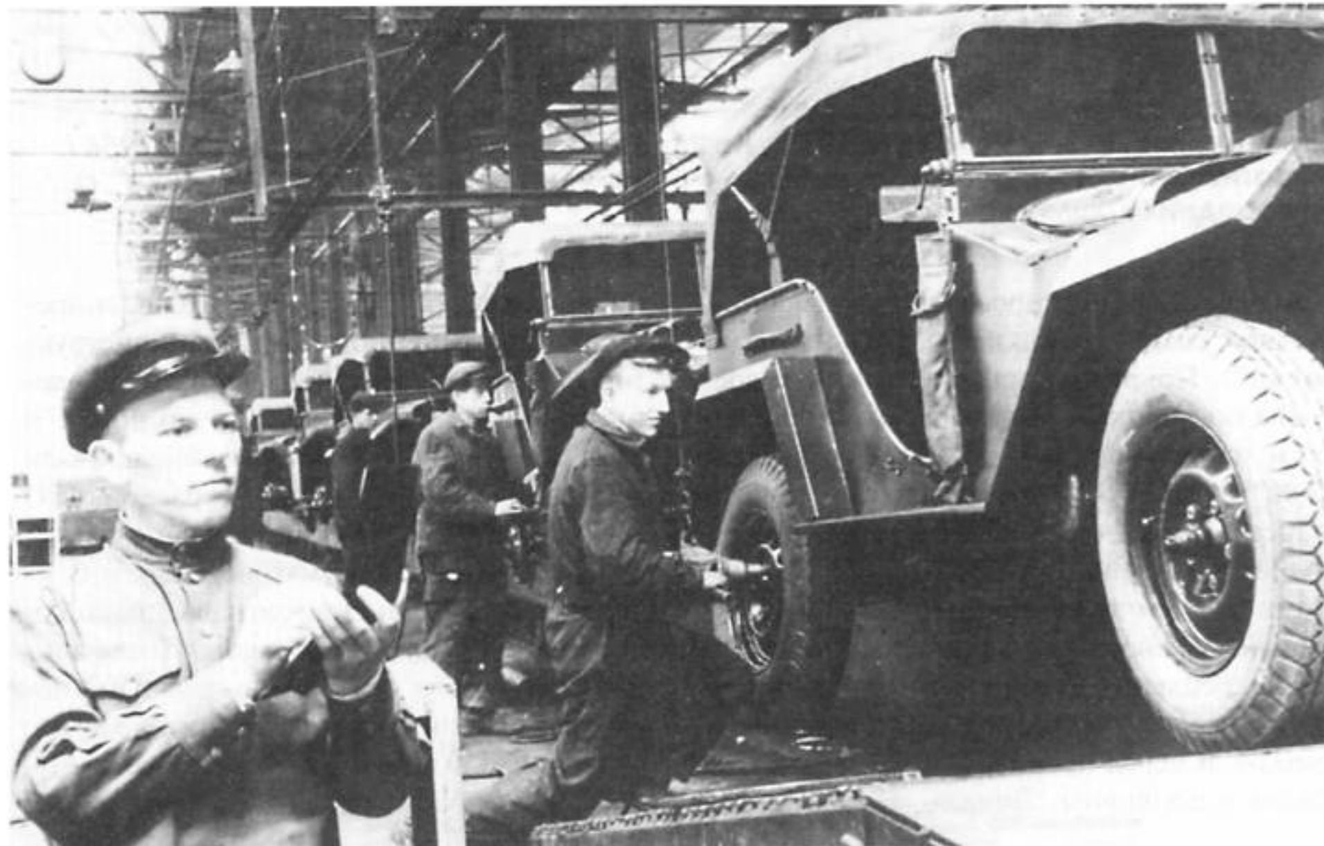
Сборка ГАЗ-67Б на конвейере ГАЗа в 1947 г. На переднем плане — мастер А. Зальцев. Фото РГАКФД.
