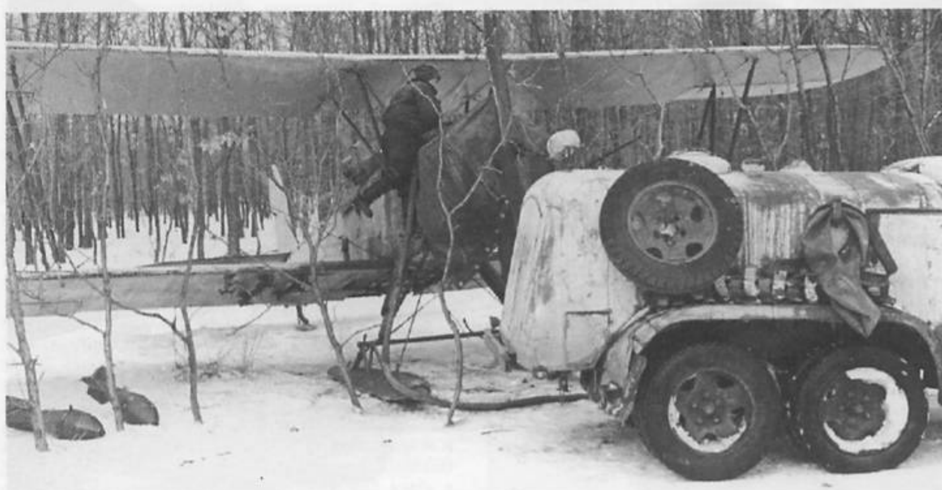
Замаскированный БЗ-35 заправляет замаскированный МиГ-3. На машине снята дверка люка буксирного крюка. Лето 1941. Фото РГАКФД.
