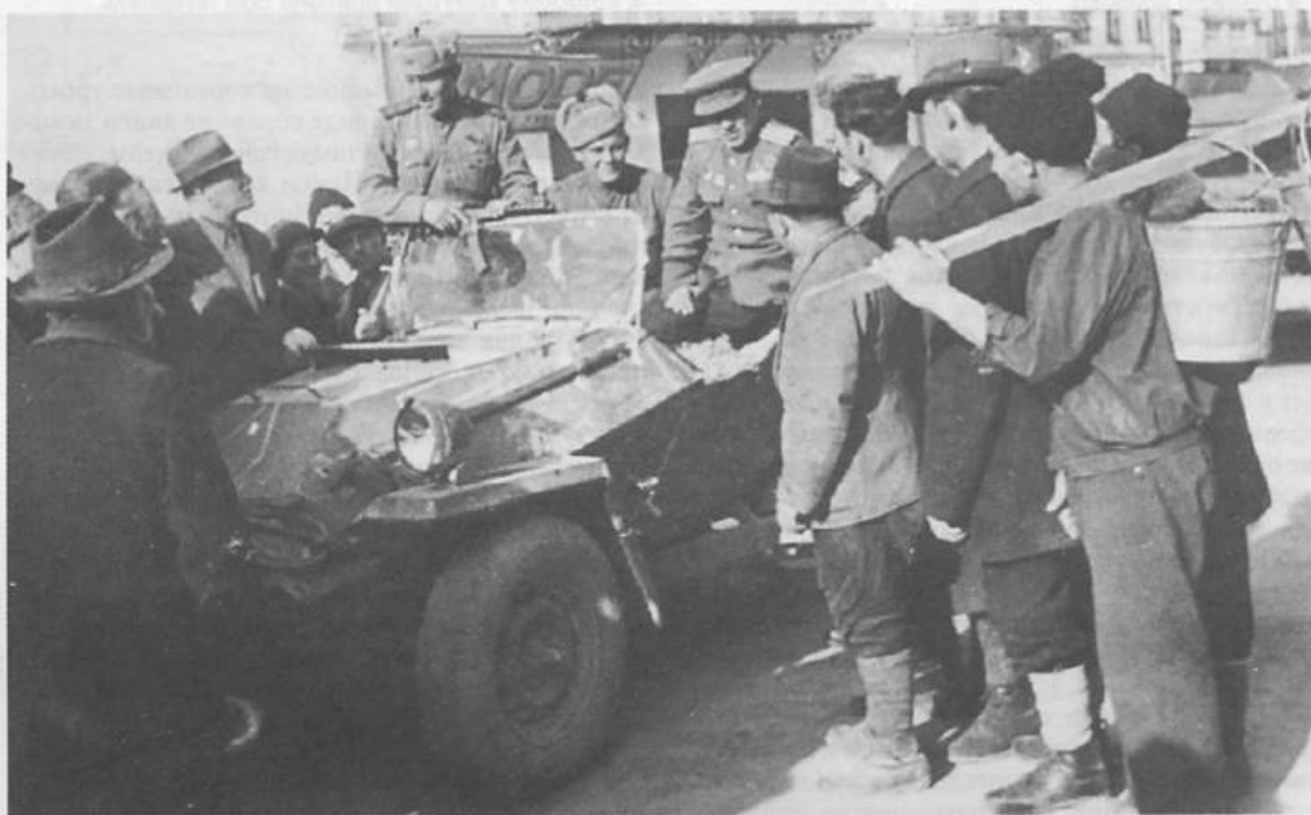
БА-64-125, превращенный в родстер фронтовыми умельцами. На машине сиденья и ветровое стекло от Schwimmwagen. К необходимости таких переделок приводила теснота боевого отделения и любовь «стодвадцатьпятки» к переворачиванию. На переднем бронелисте изображено красное знамя в ромбе. Румыния, г.Богашаны, 1944.
