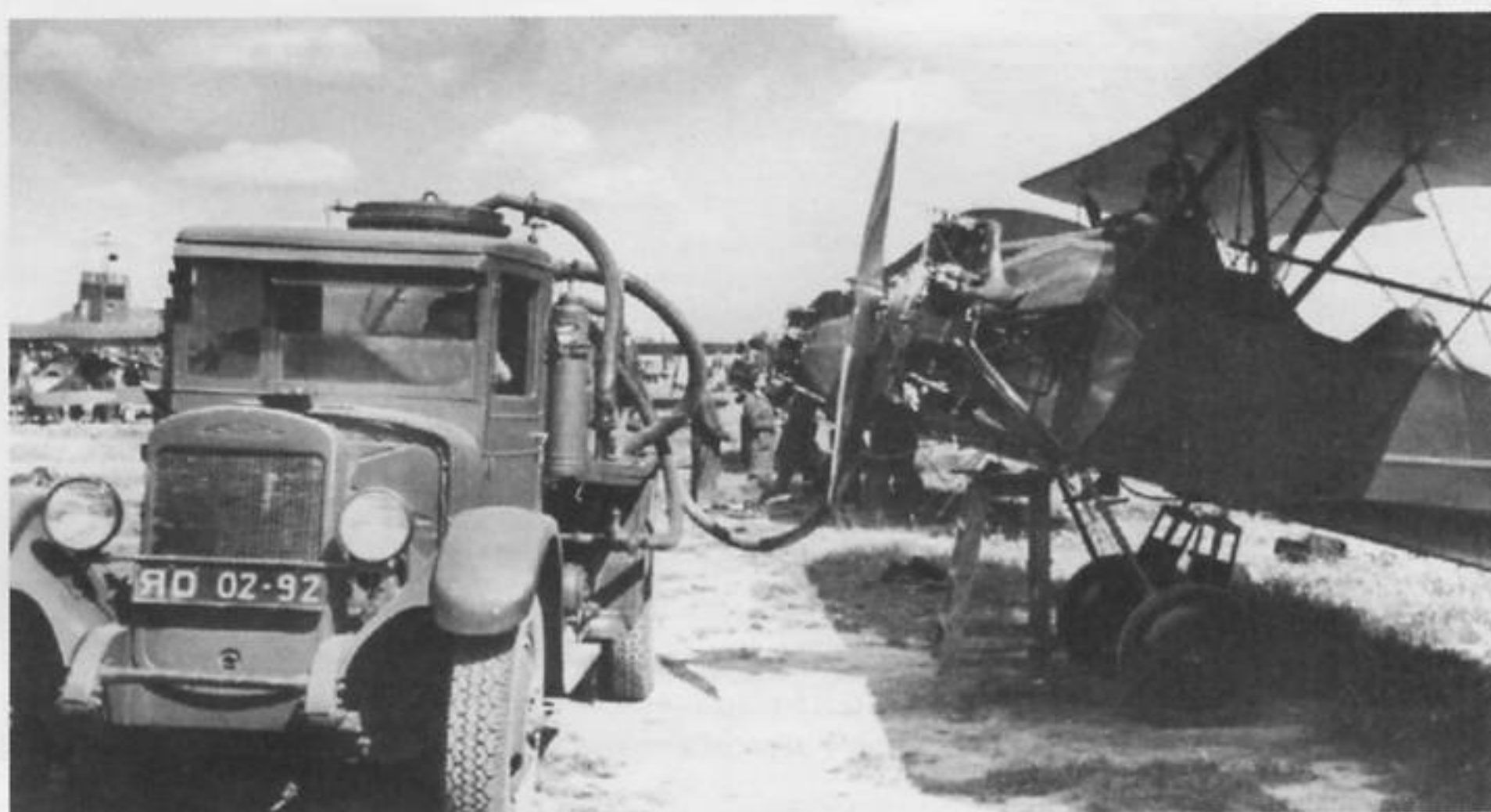
Бензозаправщик Б3-39М принимает горячее с бензовоза на шасси ЗиС-5 (на переднем плане). На лобовом стекле заправщика гвардейский значок. Фото РГАКФД.
