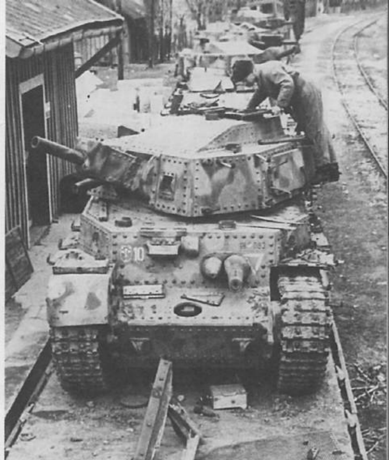
Танк Turan II. На лобовом листе — тактический номер машины, эмблема подразделения, а также серийный номер и тактический знак в виде треугольника.
