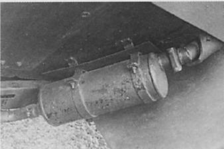
Глушитель. Хорошо виден стальной экран к которому хомутами притянут сам глушитель.
