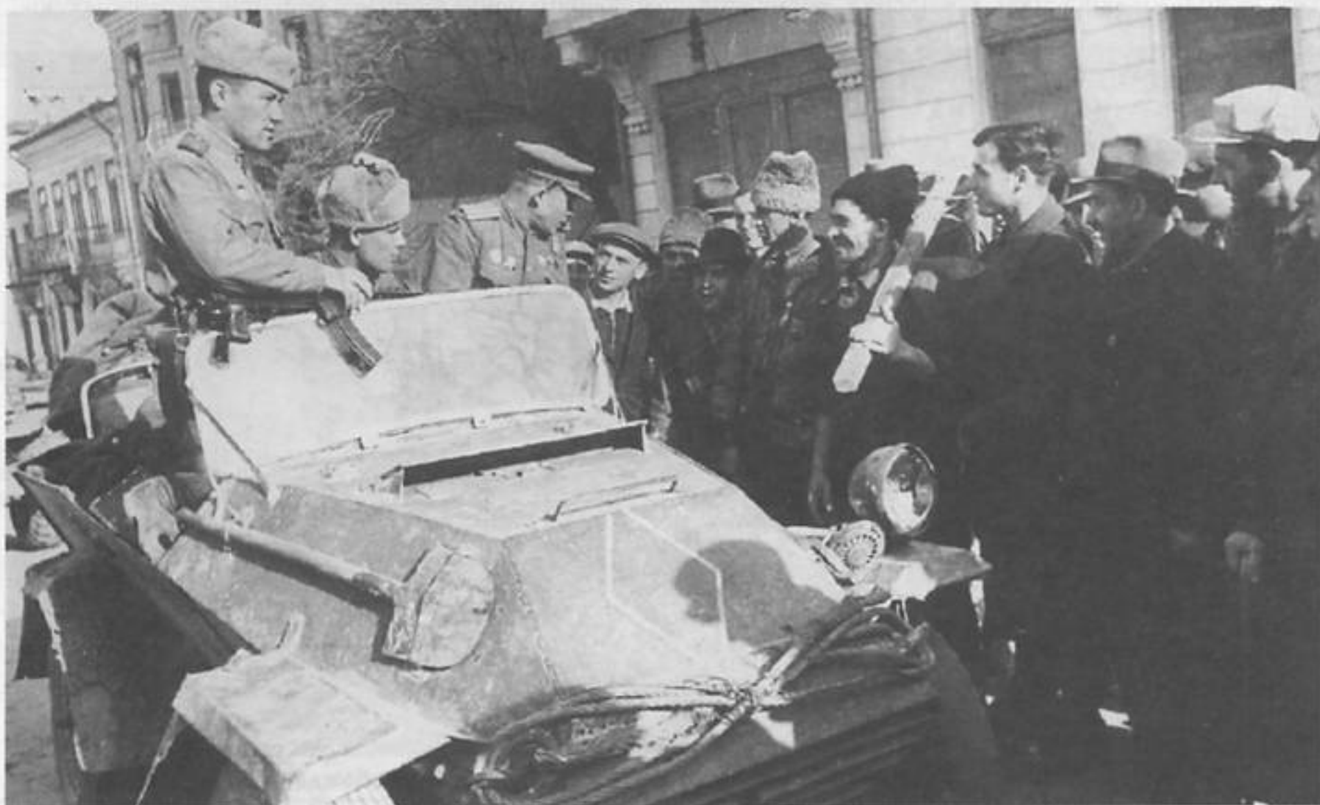
БА-64-125, превращенный в родстер фронтовыми умельцами. На машине сиденья и ветровое стекло от Schwimmwagen. К необходимости таких переделок приводила теснота боевого отделения и любовь «стодвадцатьпятки» к переворачиванию. На переднем бронелисте изображено красное знамя в ромбе. Румыния, г.Богашаны, 1944.
