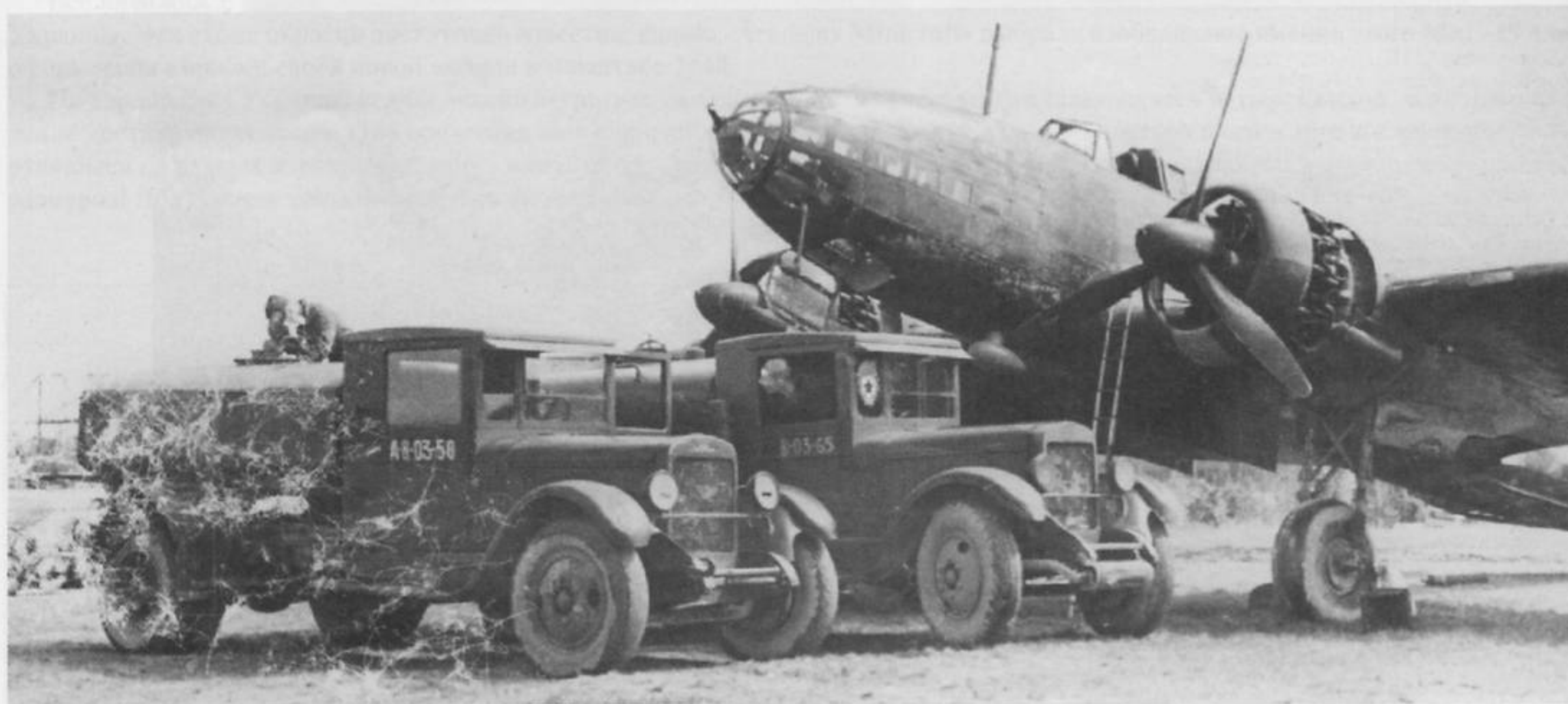
Бензозаправщик Б3-39М принимает горячее с бензовоза на шасси ЗиС-5 (на переднем плане). На лобовом стекле заправщика гвардейский значок. Фото РГАКФД.
