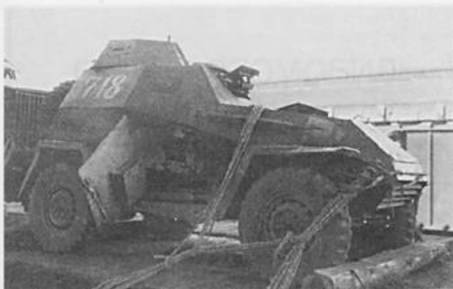
БА-64Б захваченный американцами в Корее в 1950. На открытой двери хорошо виден жестяной ящик для ЗИП и инструментов (был на обеих дверях).
