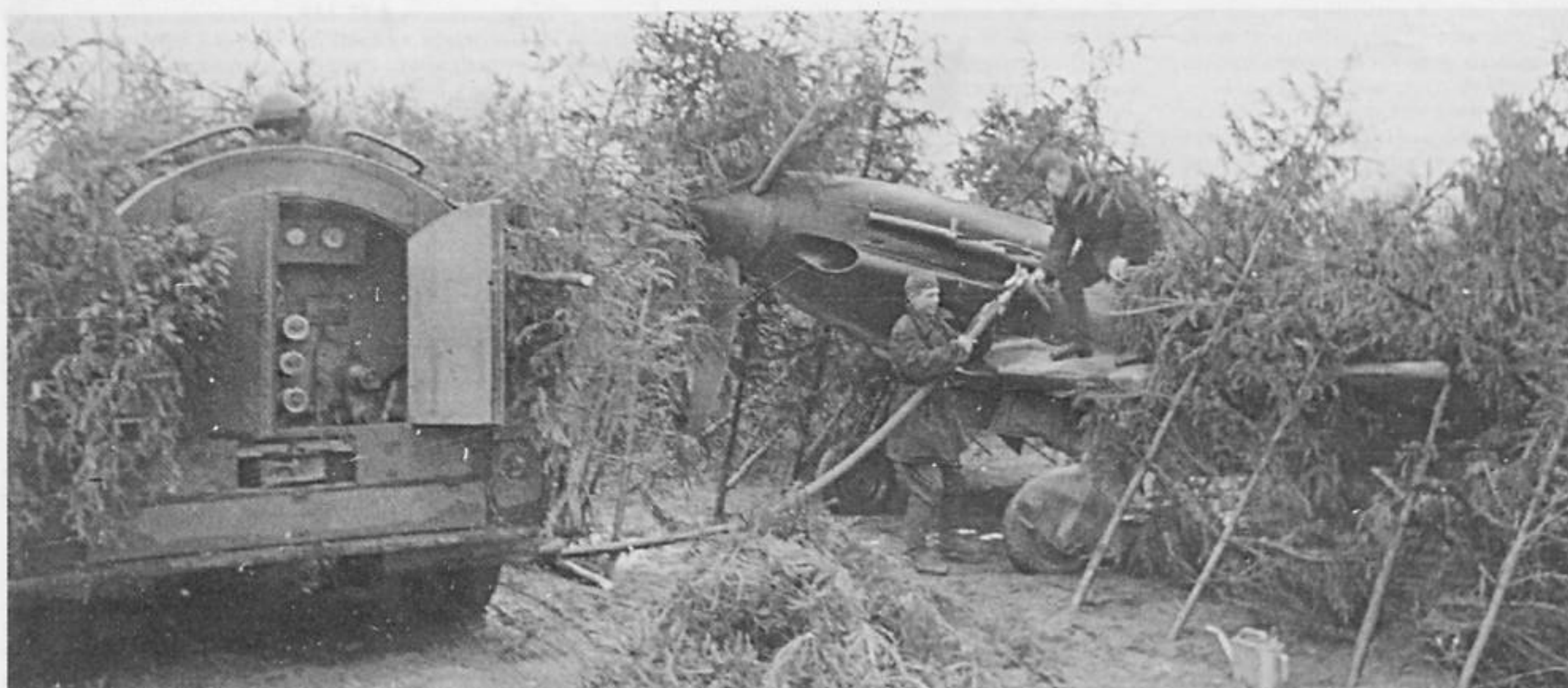
Замаскированный БЗ-35 заправляет замаскированный МиГ-3. На машине снята дверка люка буксирного крюка. Лето 1941. Фото РГАКФД.
