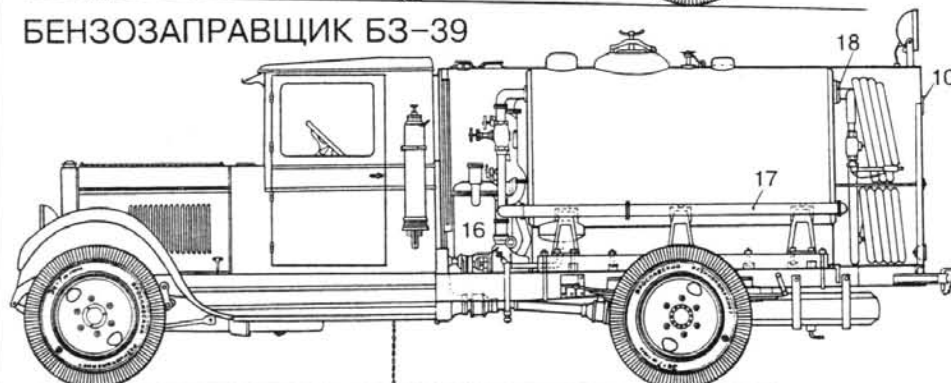
УСТАНОВКА КОРОБКИ ОТБОРА МОЩНОСТИ И НАСОСА НА ШАССИ
