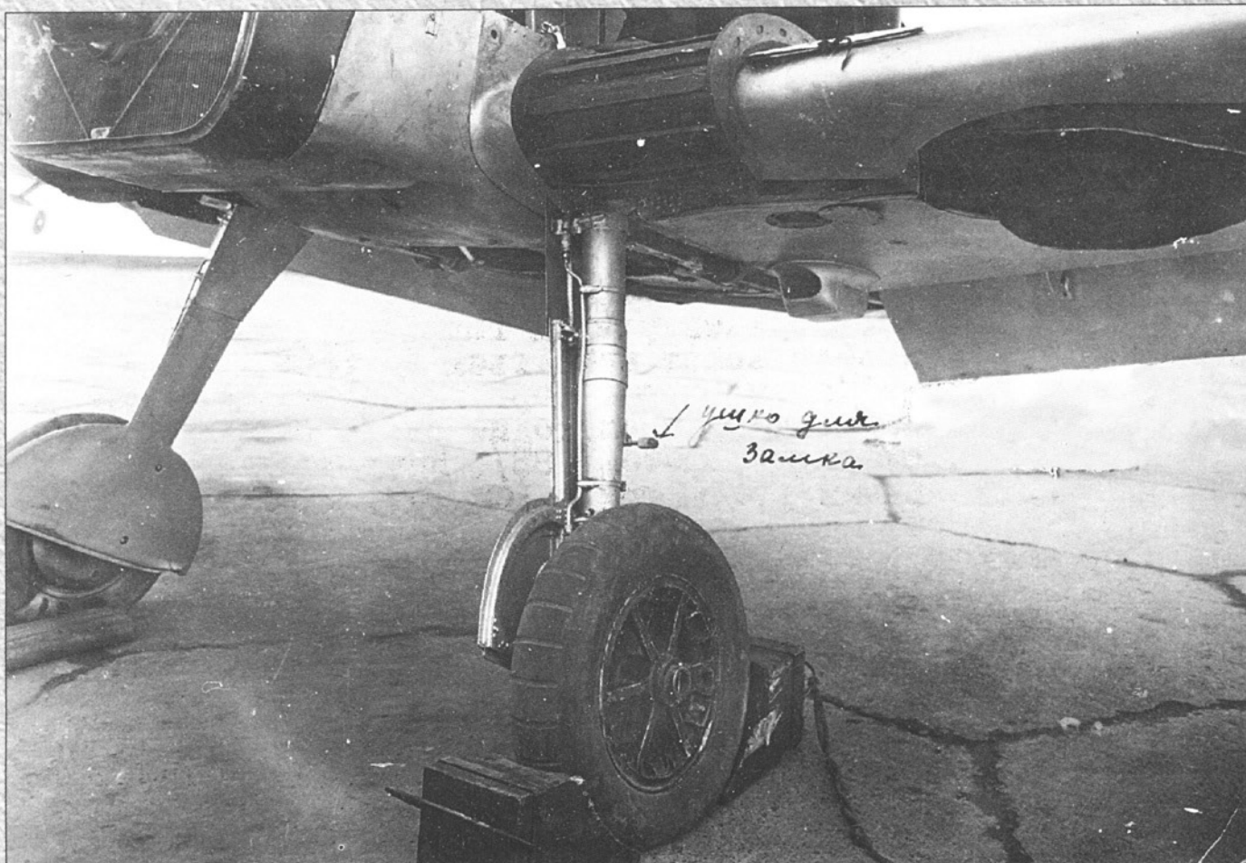
Общий вид шасси. Отмечено ушко для замка, фиксирующего шасси в убранном положении. Undercarriage legs.
