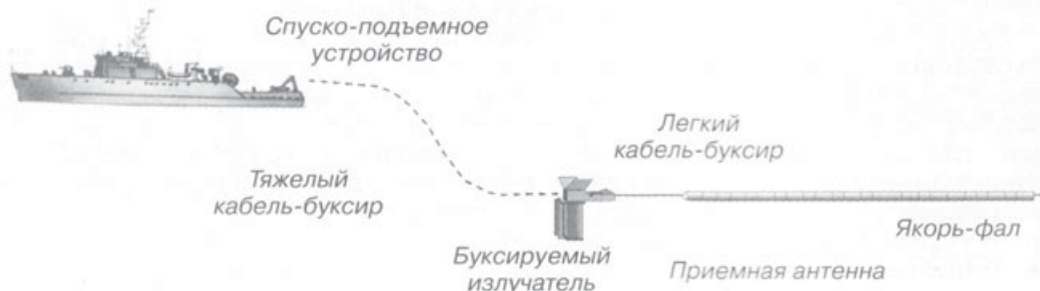
Рис. 4. Схема буксируемой части активно-пассивной ГАС для надводного корабля с гибкой протяженной буксируемой антенной
