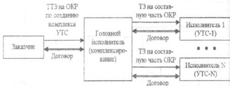
Рис. 4. Вариант создания комплекса UTC по модели «Один заказчик – один исполнитель»
