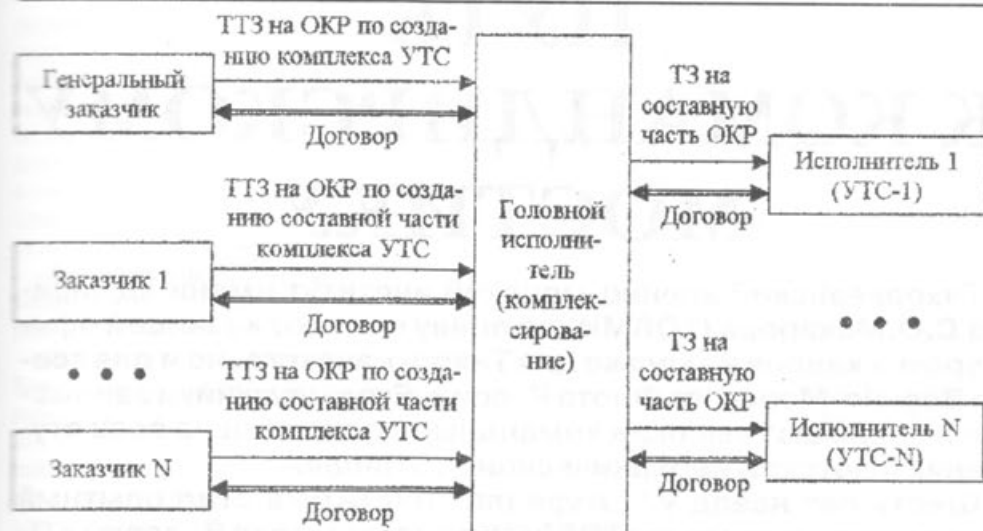
Рис. 5. Вариант создания комплекса УТС по модели «Много заказчиков – один головной исполнитель»
