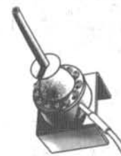
Антенна станции радиоразведки APR-1
