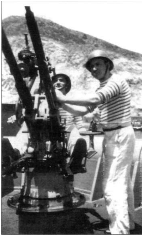
Зенитное вооружение лидера «Могадор»: 37-мм орудие (слева) и 13,2-мм пулемет; июнь 1940 г.
