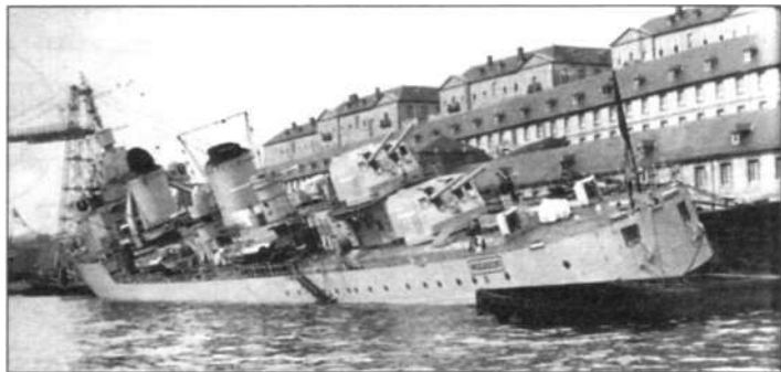
«Могадор» в Бресте, 1 апреля 1939 г. Корабль накренен для проведения испытаний работоспособности систем подачи снарядов установок главного калибра
