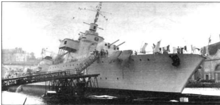
«Могадор» в Бресте, 1 апреля 1939 г. Корабль накренен для проведения испытаний работоспособности систем подачи снарядов установок главного калибра
