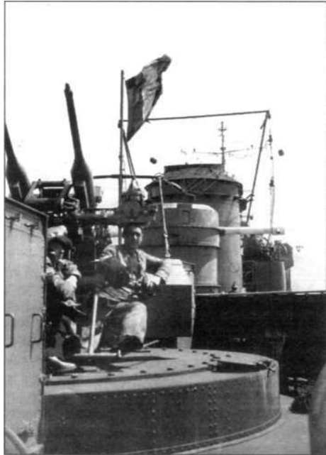
Зенитное вооружение лидера «Могадор»: 37-мм орудие (слева) и 13,2-мм пулемет; июнь 1940 г.
