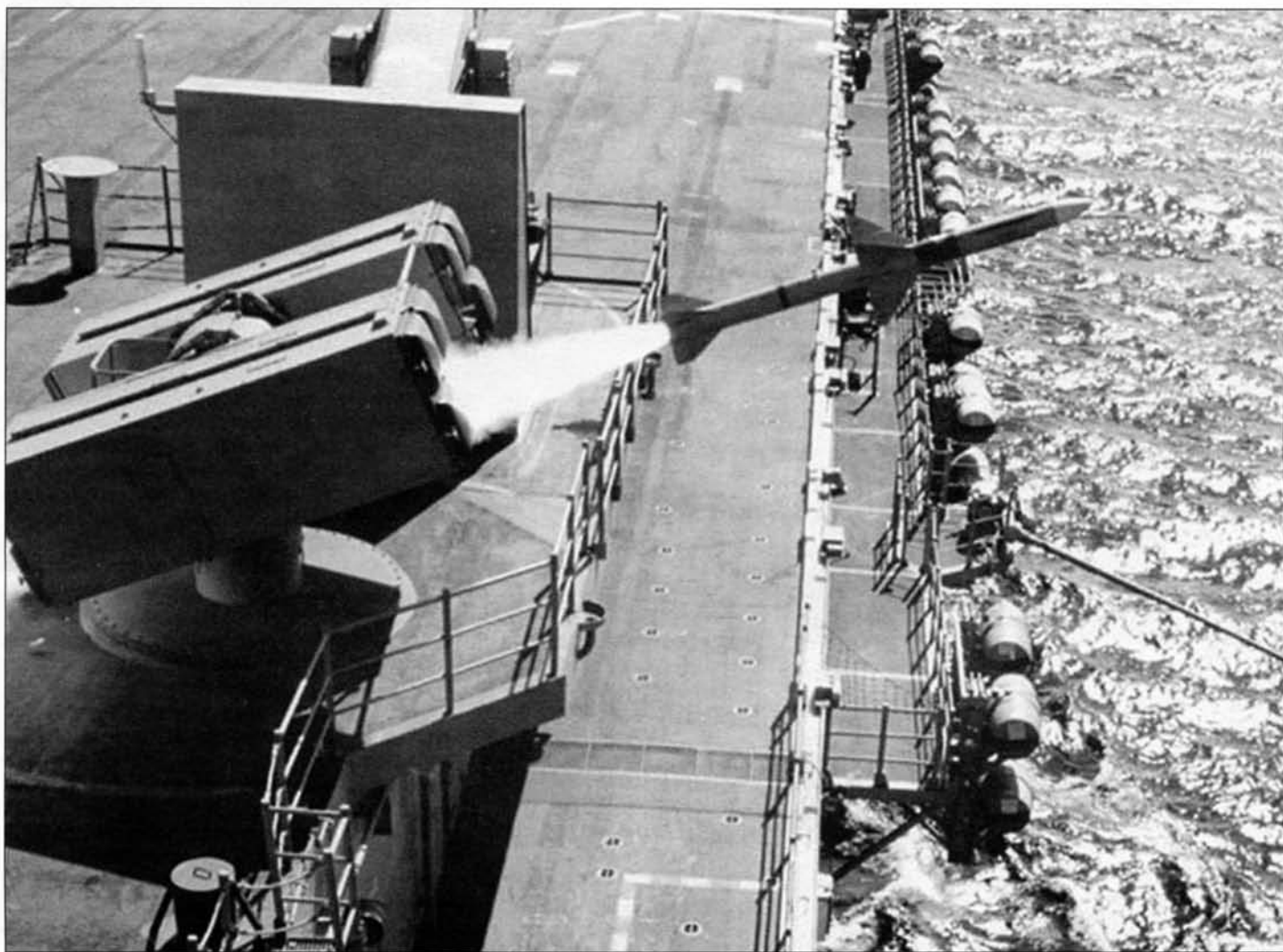
Пуск управляемой ракеты RIM-7M/P зенитного ракетного комплекса (ЗРК) Sea Sparrow с борта авианосца Nimitz
