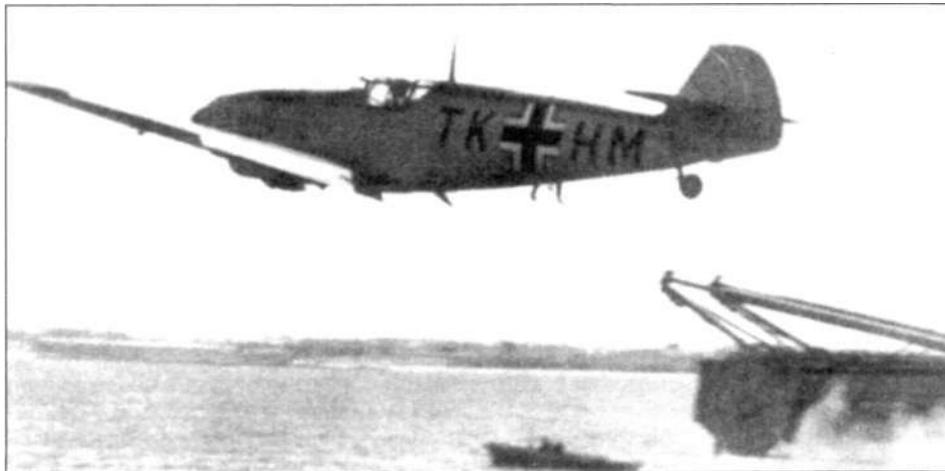
бителя продолжались до января 1939 года, и первоначально они проводились на аэродроме, имитирующем палубу авианосца. В испытаниях участвовали две машины — V17 и V17А. Последний представлял собой Bf 109В, прошедший капитальный ремонт летом 1938 года. Каждый из самолетов оснастили тормозным гаком, а также заслонками, предотвращающими захват колесами тросов аэрофинишера.
