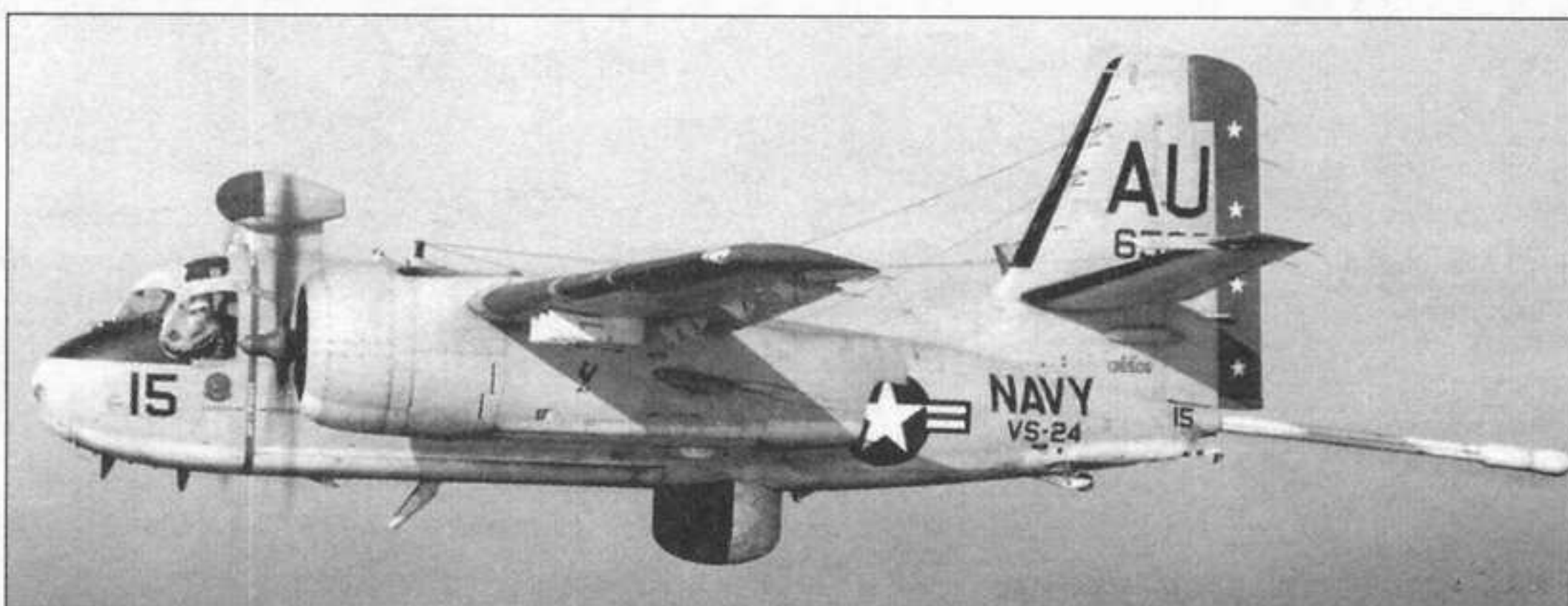
Противолодочный самолет S2-F Tracker в полете. Поисковая РЛС и магнитный датчик в рабочем положении
