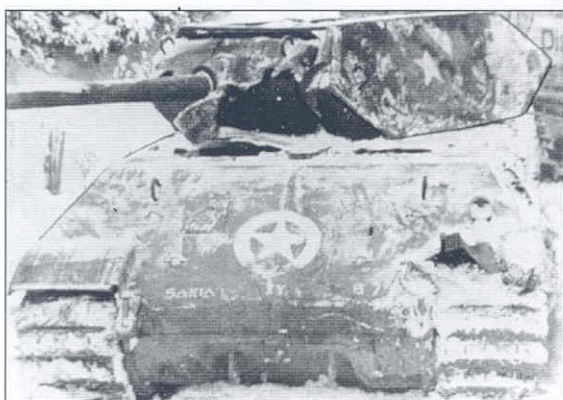
Различные ракурсы немецкого танка "Пантера", закамуфлированного под американскую самоходку М10. 2150-й батальон 150-й танковой бригады специального назначения вермахта, декабрь 1944 года (АВЛ).
