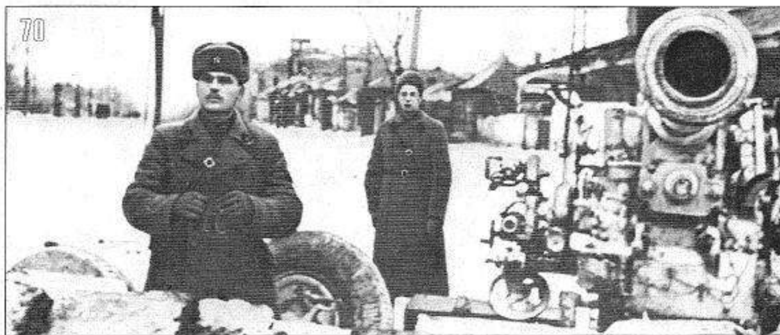
70, 71. Зенитные орудия на окраинах Тулы. Эти 85-мм орудия образца 1939 года могли уничтожать не только самолеты, но и танки врага. 732-й зенитно-артиллерийский полк, конец октября 1941 года (АВЛ).
