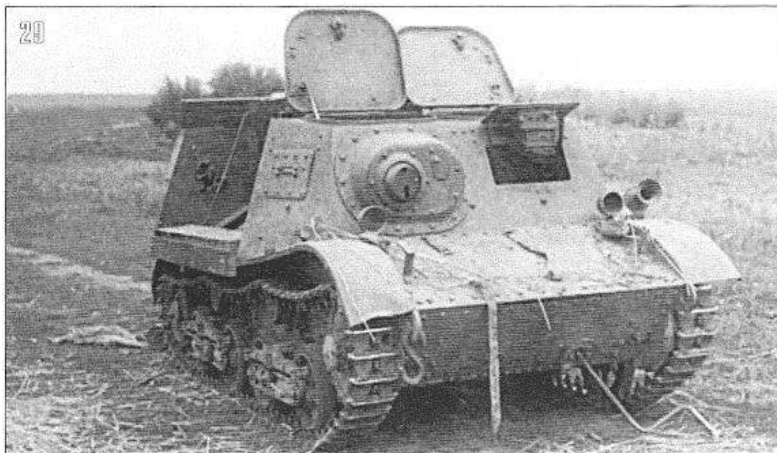
28. Трофеи вермахта: скоростной артиллерийский трактор СТЗ-5НАТИ и его водитель. 2-я танковая армия, октябрь 1941 года (АВЛ).
