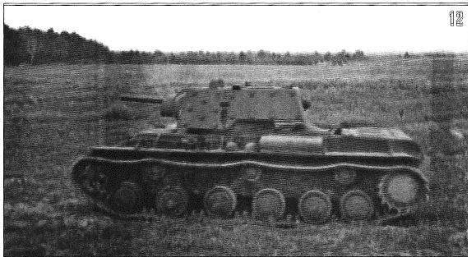
12-14. Рассчитывая остановить германское наступление, советские войска отчаянно контратаковали. На фото 12 – тяжелый танк КВ-1 движется на вражеские позиции, на снимках 13, 14 – подбитые немцами наши КВ. Все эти машины экранированы дополнительными бронелистами. Брянский фронт, 108-я танковая дивизия, сентябрь 1941 года (АВЛ).
