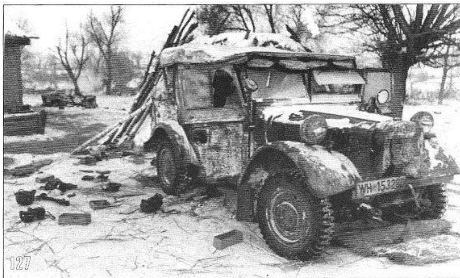
127. Брошенный отступавшими штабной автомобиль из артдивизиона — le.gl.Einheits-Pkw с регистрационным номером типа «WH-153280». По брошенной заводной ручке и подстилке (она прикрывала капот) перед капотом видно, что машину пытались завести. Группа армий «Центр», 2-я танковая армия Гудериана, декабрь 1941 года (АВЛ).
