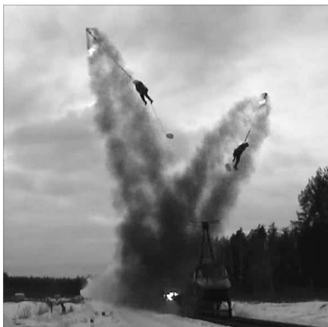
Рис. 10. Катапультирование манекенов из стенда-кабины, движущейся по ракетной дорожке со скоростью 350 км/ч
