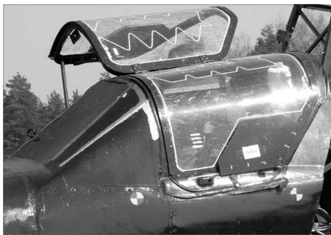
Рис. 9. Створки кабины с устройством разрушения остекления
