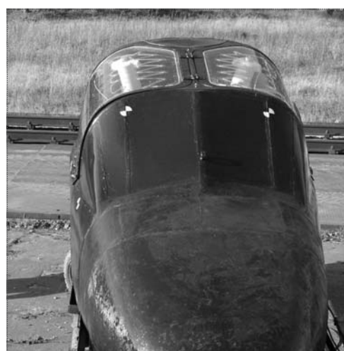
Рис. 4. Устройство разрушения остекления на створках кабины
