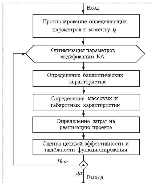
Рис. 6. Блок-схема алгоритма оптимизации параметров модификации КА при заданных функциональных связях
