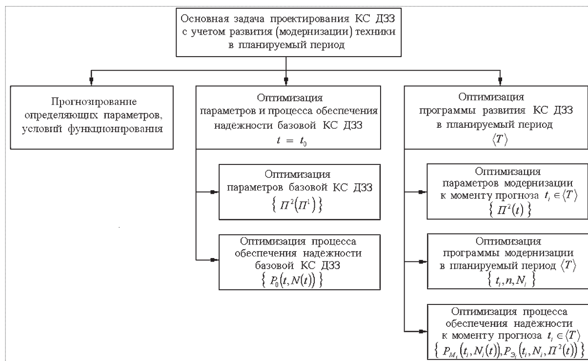
Рис. 1. Логическая схема расчлененного исследования динамической задачи проектирования КС ДЗЗ
