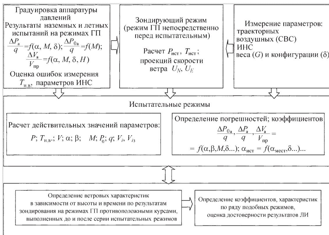
Рис. 1. Структура решения задачи определения действительных значений воздушных параметров и аэродинамических погрешностей ПВД в ЛИ ВС на неустановившихся режимах полета
